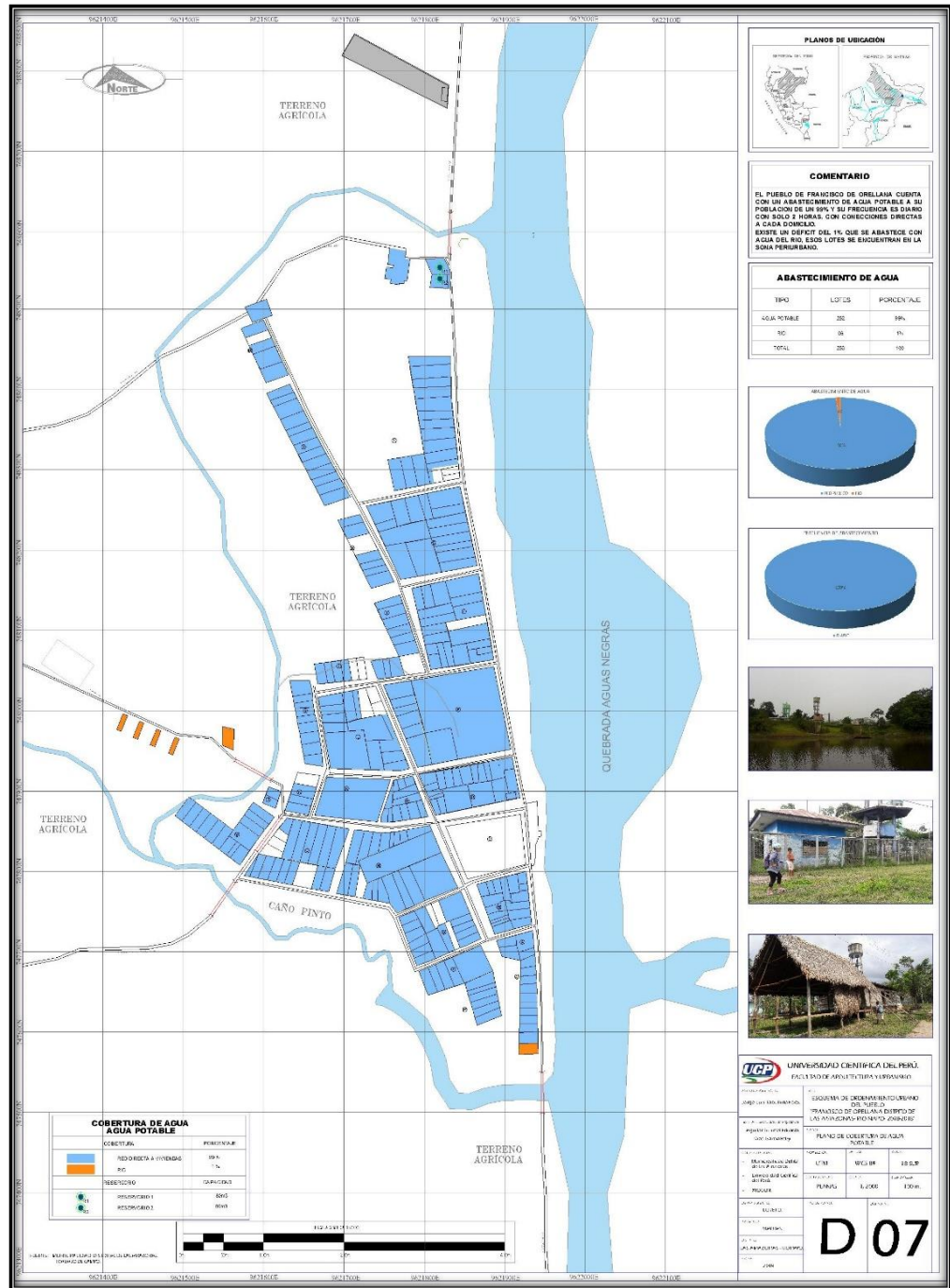
Figura N° 20: Plano de diagnóstico cobertura de agua potable del Pueblo Francisco de Orellana D – 07
