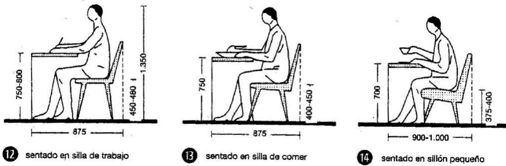
Figura 31 Medidas del cuerpo Humano Fuente: NEUFERT, Arte de proyectar en Arquitectura - edición 16 – 2009
