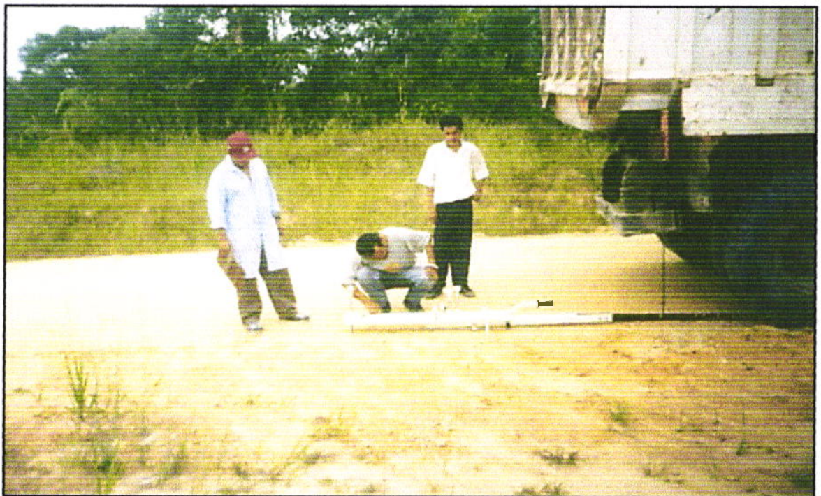
Verificando que el dial de la viga se encuentre en cero.
