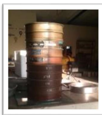
FOTO N° 6 Tamices Análisis Granulométrico de la perla de poliestireno
