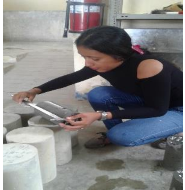
FOTO N° 70: se toma la medida del diametro.
