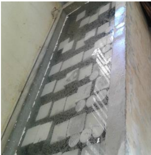
FOTO N° 77: Vista de las vigas en agua para su curado en 28 días.
