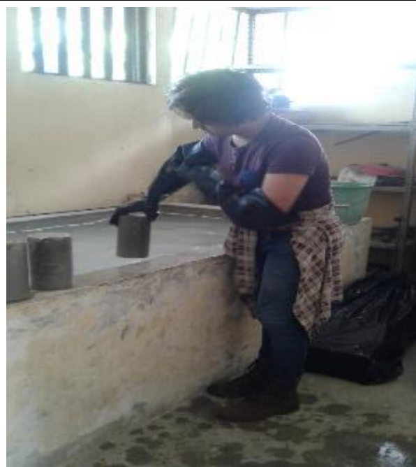
FOTO N° 85: Retiro de las probetas del agua a los 28 días de curado.
