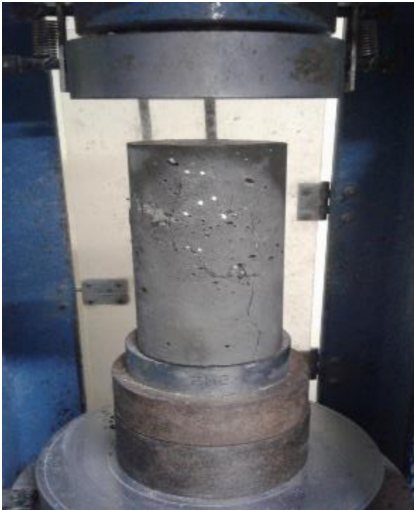
FOTO N° 65: Vista de la probeta despues de rotura. Fuente: Elaboración propia (2019).
