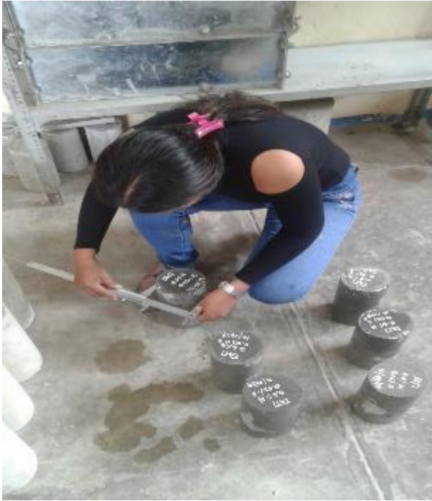
FOTO N° 63: Se retiro las probetas del agua a los 7, 14 y 28 días de curado, para rotura, antes de ello se toma la medida del diametro. Fuente: Elaboración propia (2019).
