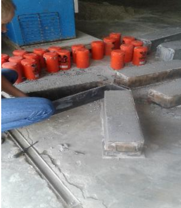
FOTO N° 75: Desmolde de las vigas de los moldes.
