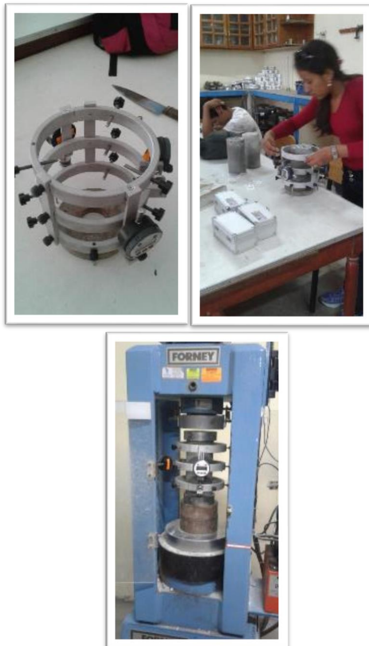
FOTO N° 15 Ensayo de módulo de elasticidad en concreto liviano no estructural
