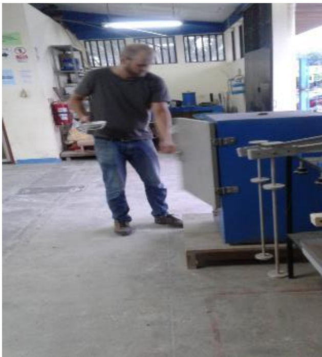
FOTO N° 27: Colocación del material lavado del tamiz N° 200 en el horno.
