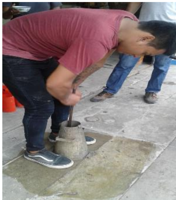
FOTO N° 52: Compactación de la mezcla por capa en 25 golpes con la varilla uniformemente.
