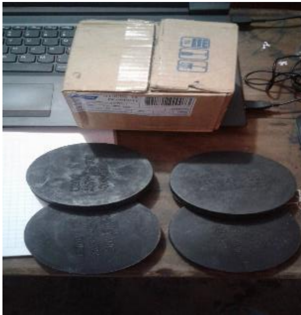
FOTO N° 07: Discos de Desbaste de la marca Forney, que sirven para rotura de probetas.
