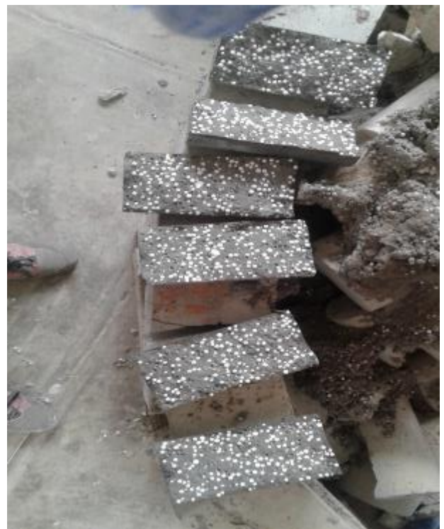
74: Probetas despues de rotura.
