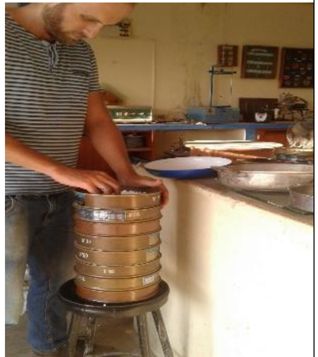
FOTO N° 36: Vista del proceso de granulometria.
