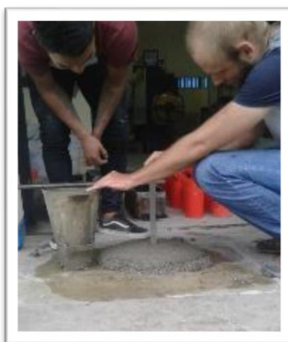
FOTO N° 8 Asentamiento del Concreto Ligero
