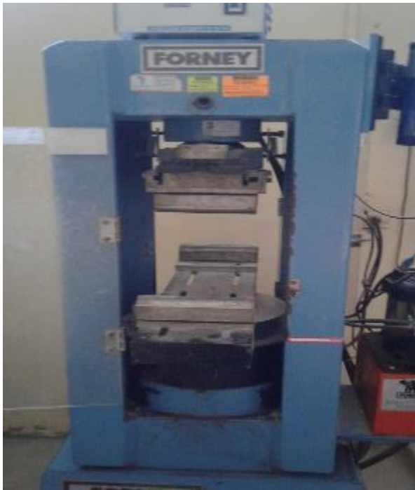
FOTO N° 79: Vista despues del ensamblaje y colocacion de lo instrumentos necesarios para rotura.
