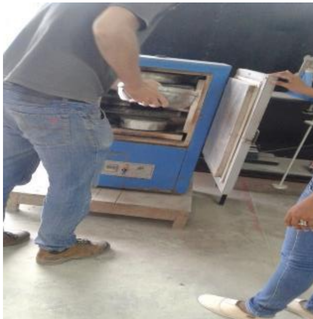
FOTO N° 23: Colocación de los recipientes con las muestras en el horno.
