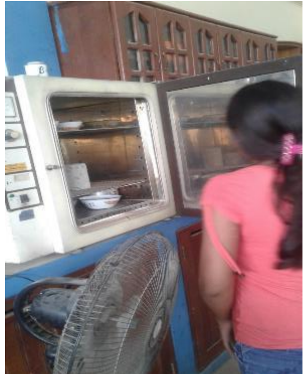
FOTO N° 12: Colocación del agregado fino en horno.
