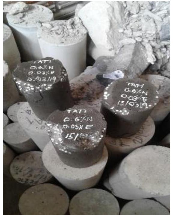
66: Fisuras de la probeta despues de rotura. Fuente: Elaboración propia (2019).
