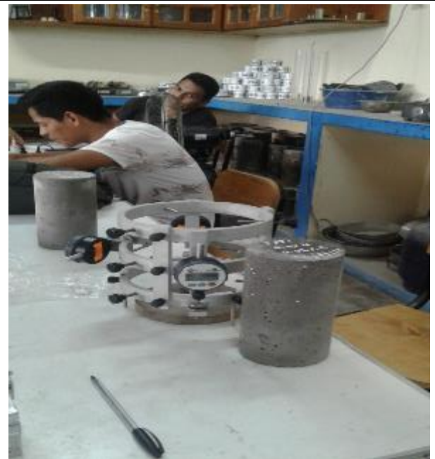
FOTO N° 94: Vista de la probeta luego de ser retirada del aparato medidor.
