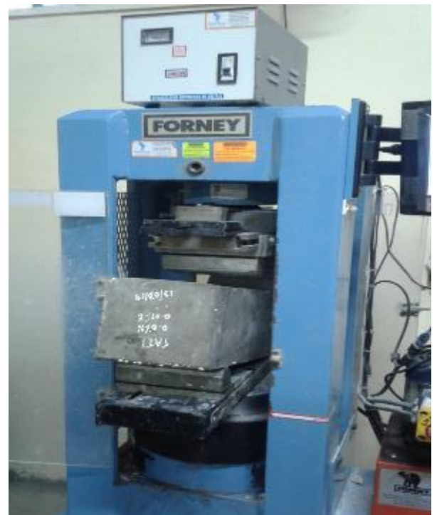
FOTO N° 82: Viga despues de rotura.
