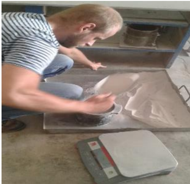
FOTO N° 31: Proceso de llenado en 3 capas, en el molde Fuente: Elaboración propia (2019).
