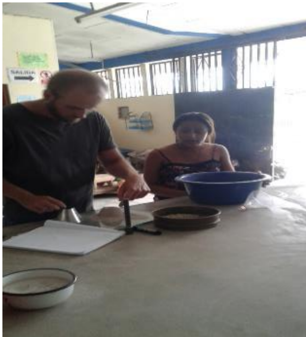
FOTO N° 17: Prueba de cono de absorción, para verificar si las partículas del agregado fino están secas.
