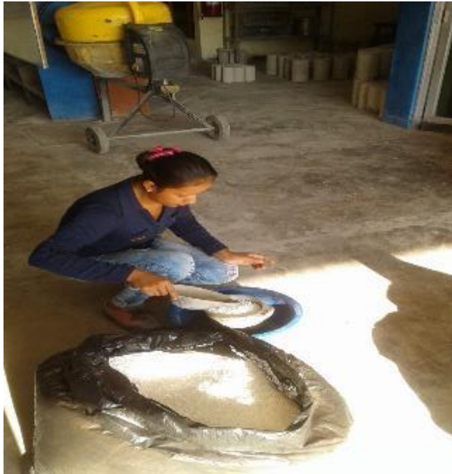
FOTO N° 31: Ensayo del Peso unitario suelto, de las perlas de poliestireno.
