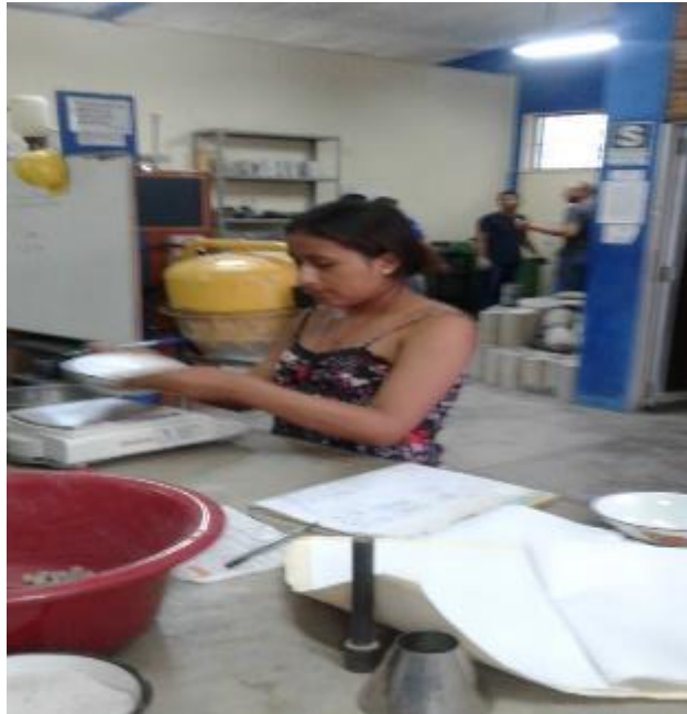
FOTO N° 25: Peso de las taras para la colocación del material.
