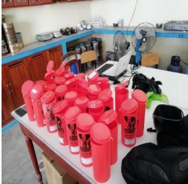
FOTO N° 05: Moldes cilíndricas de 4" x 8" de la marca Forney.
