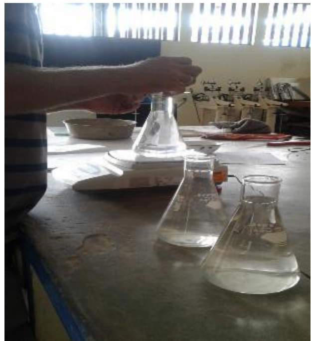
FOTO N° 38: Peso de los frascos volumetricos con agua.
