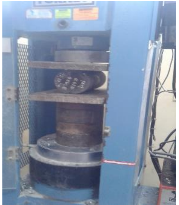
FOTO N° 72: Vista de la forma en que debe ser colocado la probeta para el ensayo.
