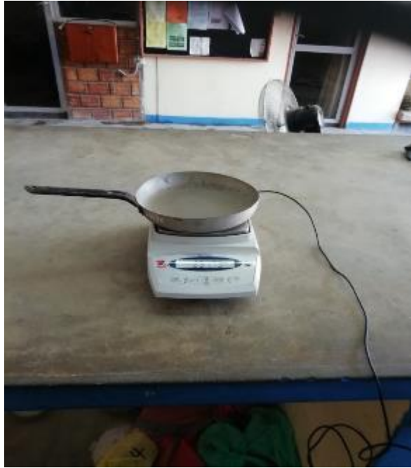
FOTO N° 39: Peso del agregado fino para el contenido de humedad del diseño.
