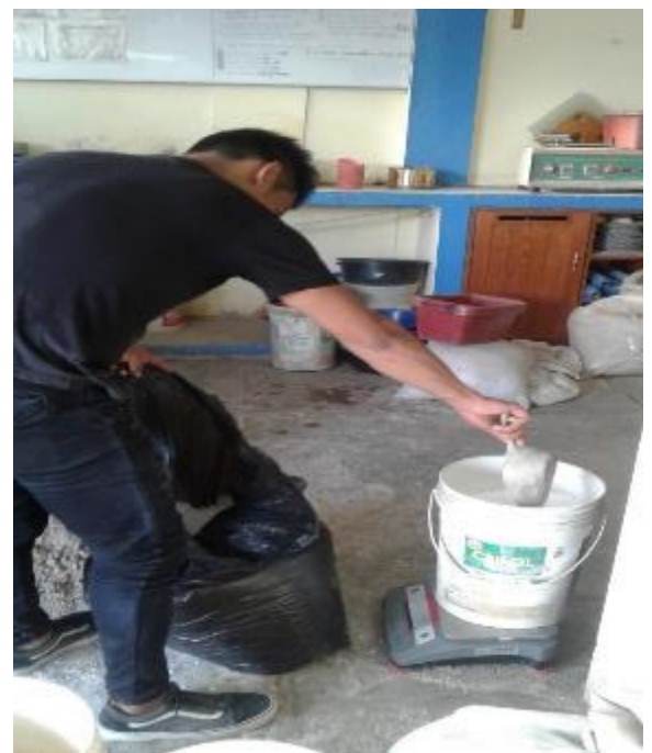
FOTO N° 36: Peso de las perlas de poliestireno para el diseño de mezclas. Fuente: Elaboración propia (2019).
