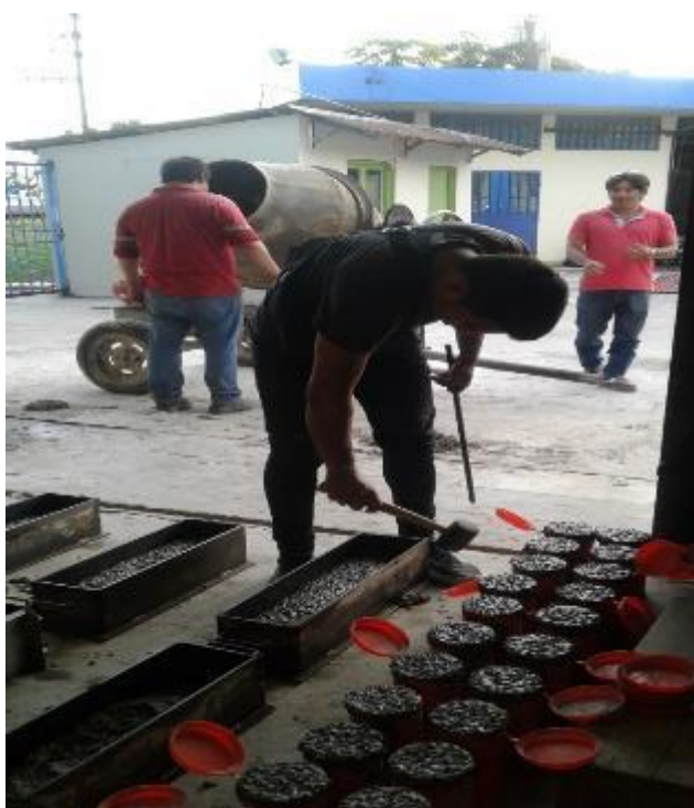
FOTO N° 45: Chuseado de la mezcla en los moldes.
