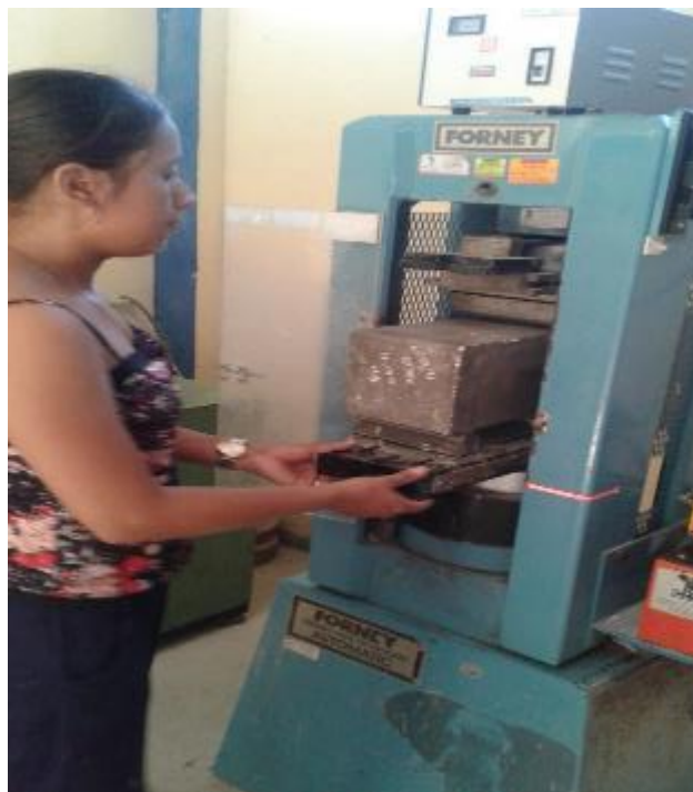
FOTO N° 81: Colocacion de la viga en los instrumentos ya ensamblados.
