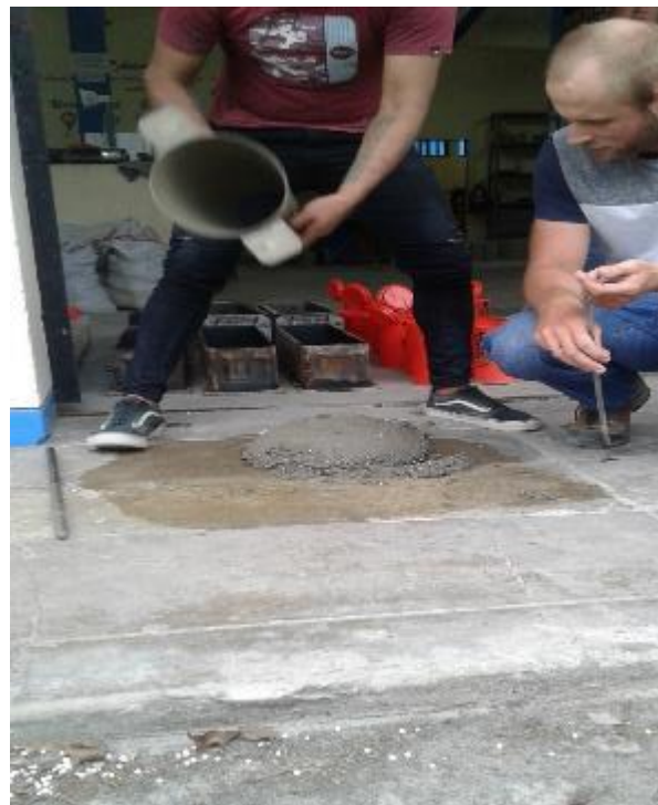
FOTO N° 54: Se procedió a levantar verticalmente el molde en 5 \pm 2 segundos, sin girarlo o moverlo lateralmente.
