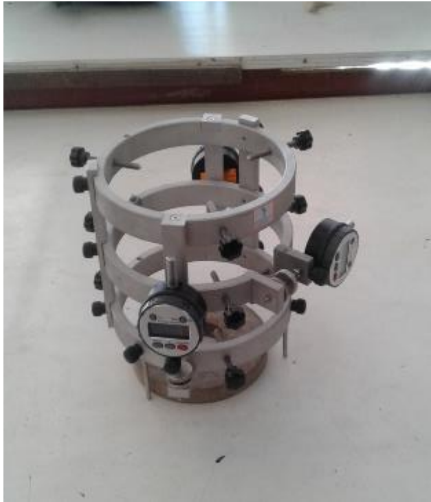
FOTO N° 87: Vista del aparato medidor de las deformaciones mediante un exometro. Fuente: Elaboración propia (2019).
