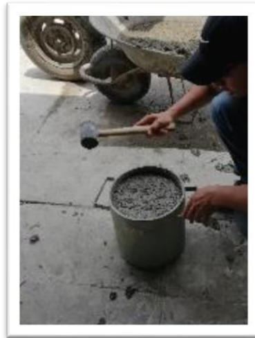
FOTO N° 9 Ensayo de exudación en recipiente de 10" de diámetro
