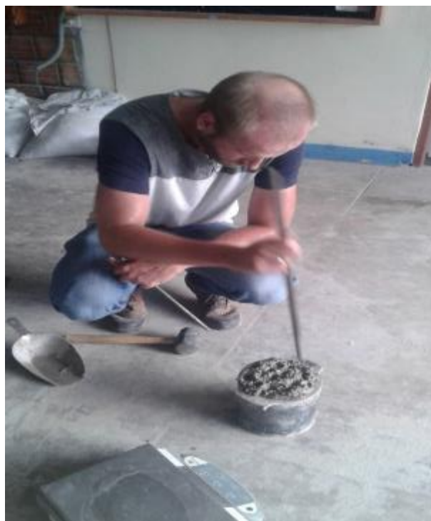
FOTO N° 48: Proceso de ensayo con varilla de 5/8" para obtener el Peso unitario de la mezcla.
