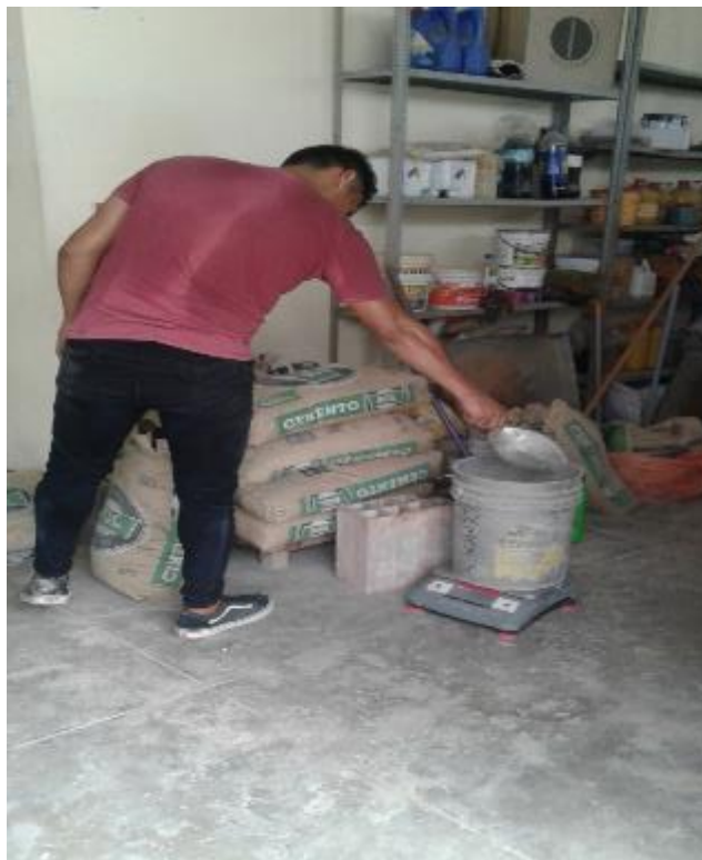
FOTO N° 37: Peso de las perlas de poliestireno para el diseño de mezclas. Fuente: Elaboración propia (2019).
