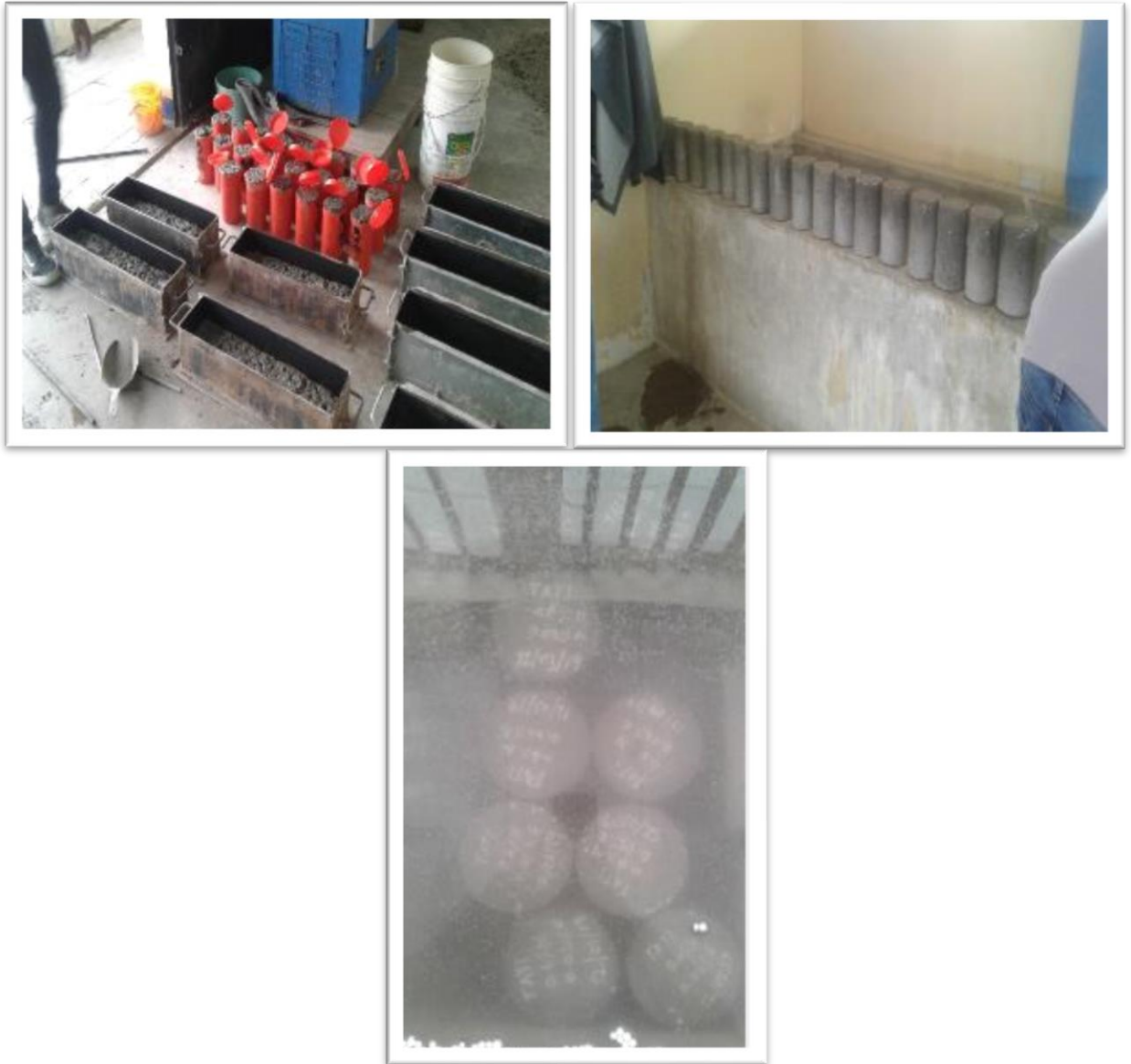
FOTO N° 11 Proceso del Concreto Endurecido y curado
