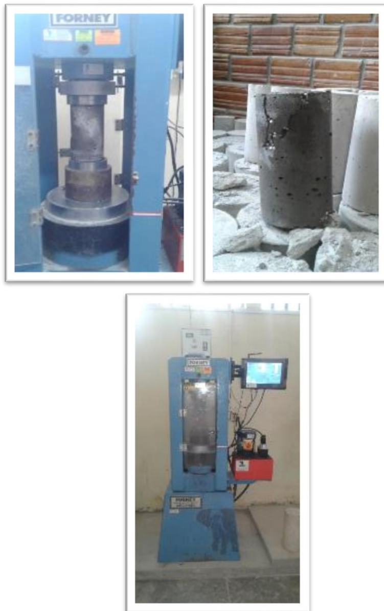
FOTO N° 12 Rotura del Concreto a compresión
