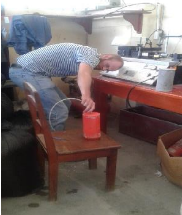
FOTO N° 59: Desmolde de las probetas de los cilindros plasticos.
