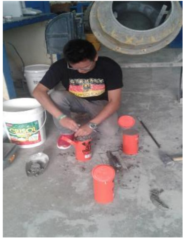
N° 44: Vaciado de la mezcla en los moldes cilindricos.
