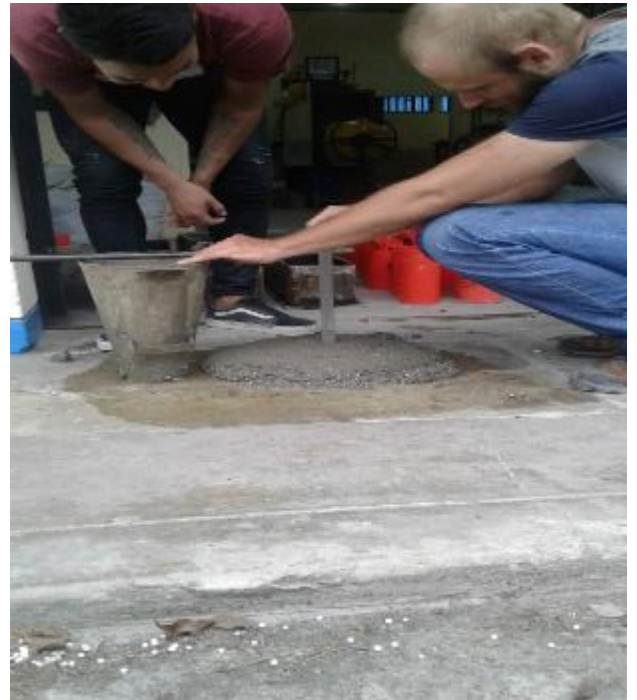
FOTO N° 56: Se tomó la medida del asentamiento desde el centro de la masa asentada del concreto hasta la parte inferior de la varilla.
