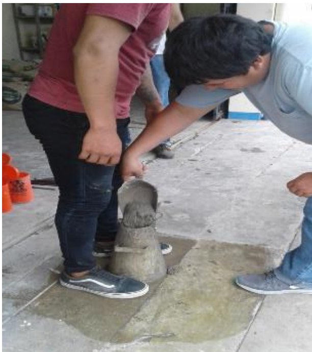
FOTO N° 51: Colocación de la mezcla en el cono, en tres capas de igual volumen.
