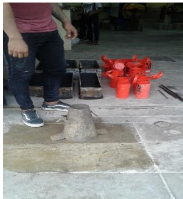
FOTO N° 50: Colocacion del cono de abrahams, para empezar con el ensayo.
