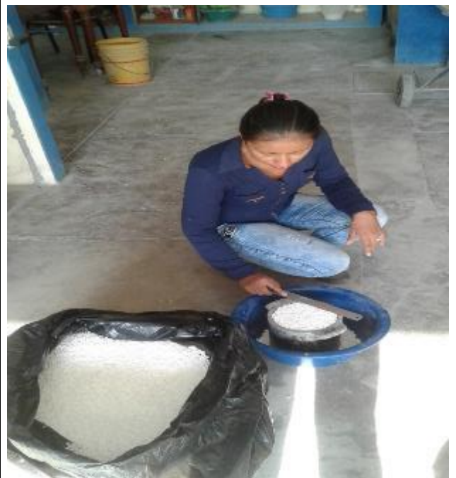
FOTO N° 32: Proceso de nivelacion de la muestra con el molde.
