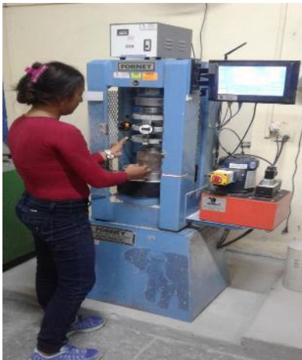
FOTO N° 89: Colocación del aparato medidor y la probeta dentro de la maquina de rotura. Fuente: Elaboración propia (2019).
