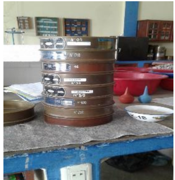
FOTO N° 14: Tamices para el análisis granulométrico.
