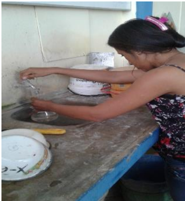
FOTO N° 37: Llenado de agua en los frascos volumétricos.
