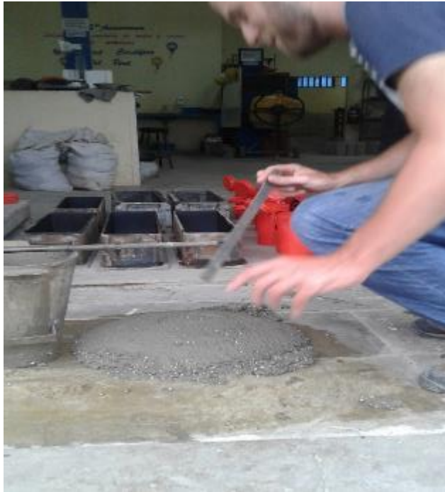
FOTO N° 55: Con la regla metálica se obtendrá el nivel de asentamiento.
