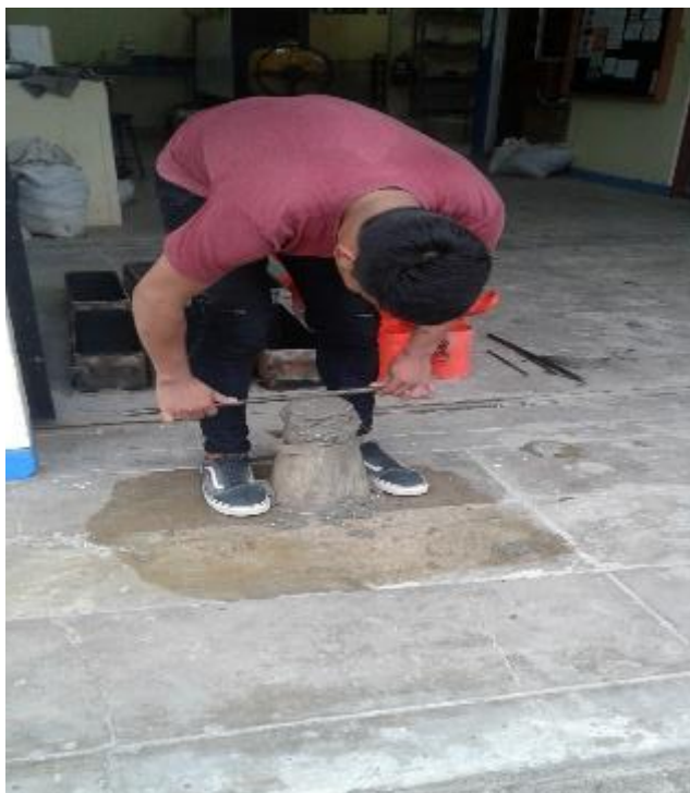
FOTO N° 53: Enrazamos la superficie hasta que la mezcla quede en el nivel del cono.
