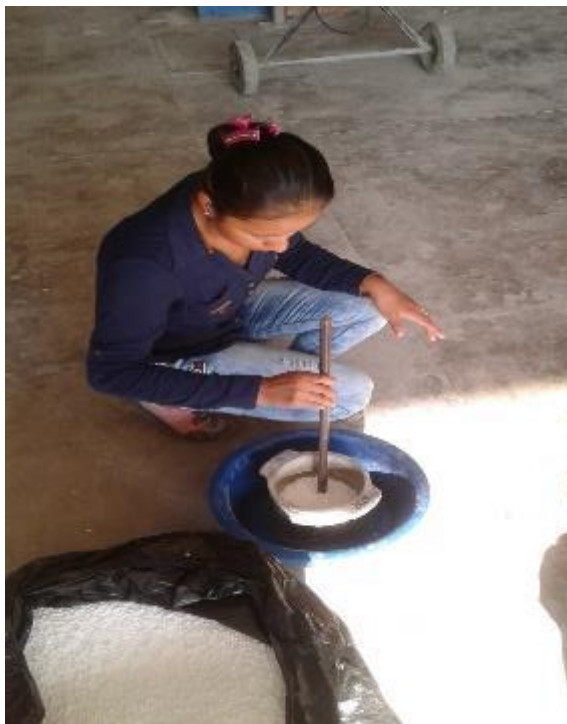
FOTO N° 33: Ensayo del peso unitario compactado, mediante varillado, por 3 capas.
