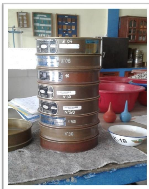
FOTO N° 3 Tamices para el Análisis Granulométrico del agregado fino
