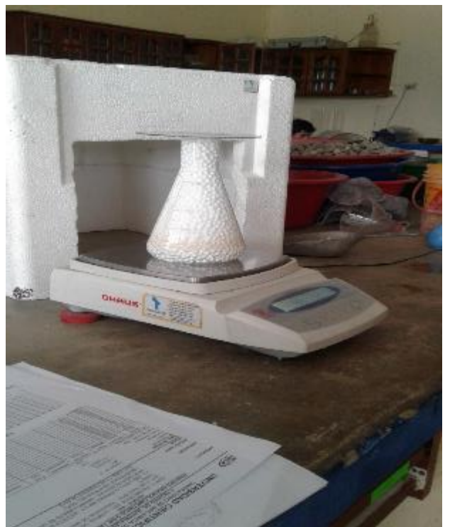
FOTO N° 40: Peso del frasco volumetrico con agua y las perlas de poliestireno
