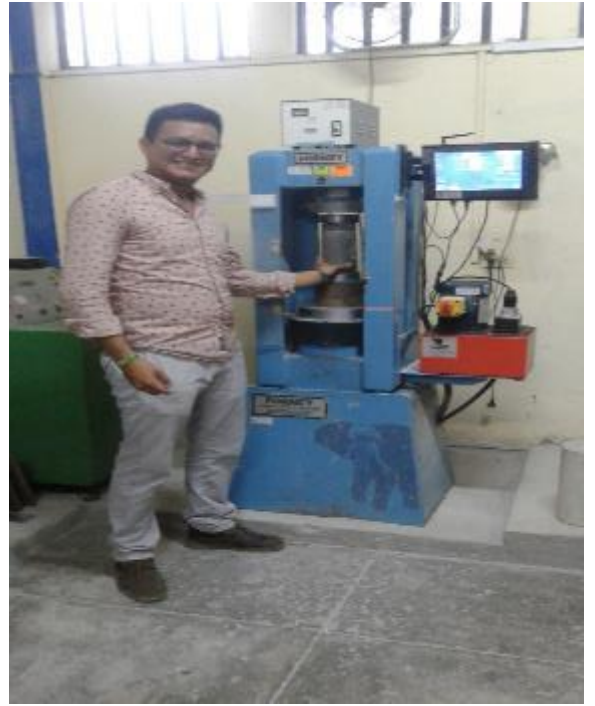
FOTO N° 64: Se colocó la probeta en la maquina para obtencion de la resistencia en los 7, 14 y 28 días, respectivamente. Fuente: Elaboración propia (2019).
