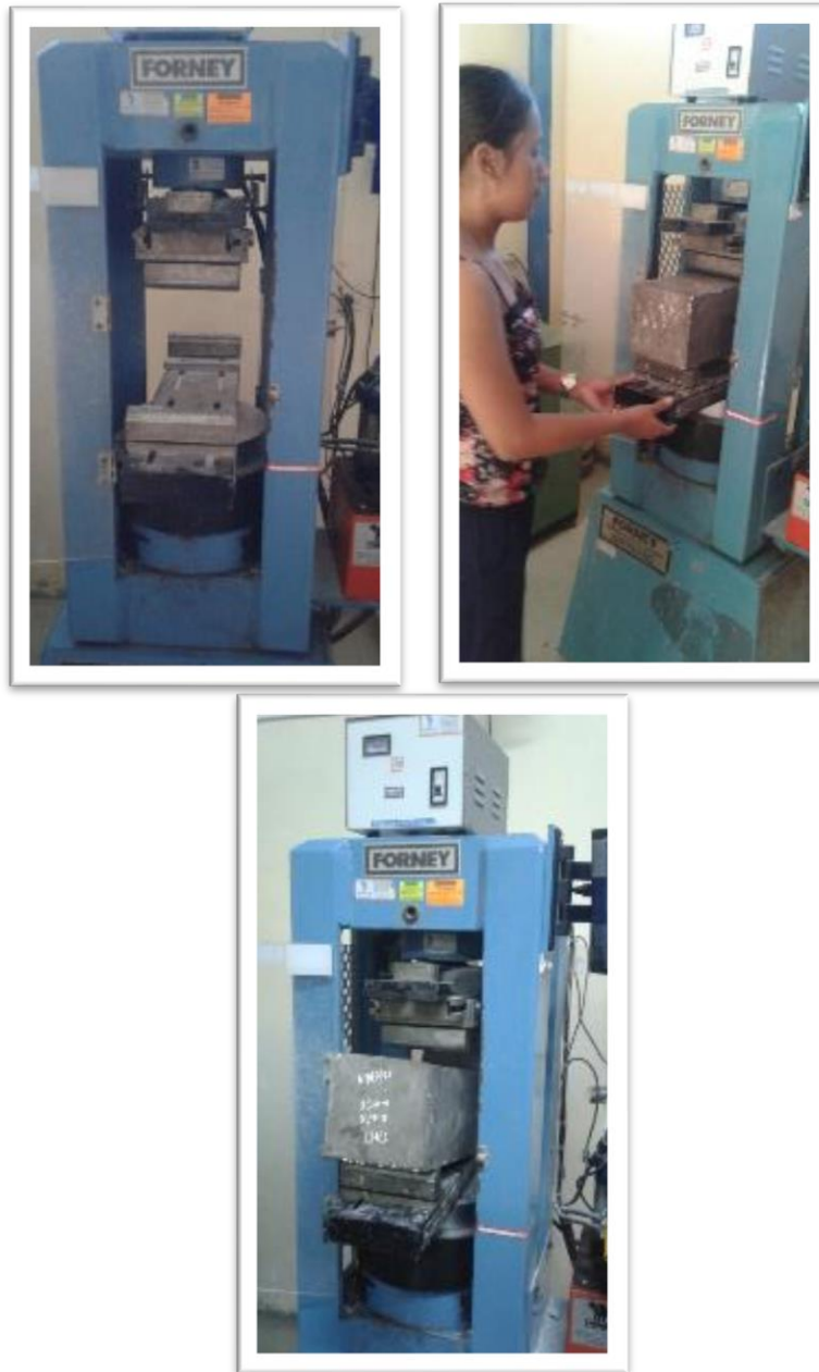
FOTO N° 14 Rotura de concreto liviano por resistencia a la flexión
