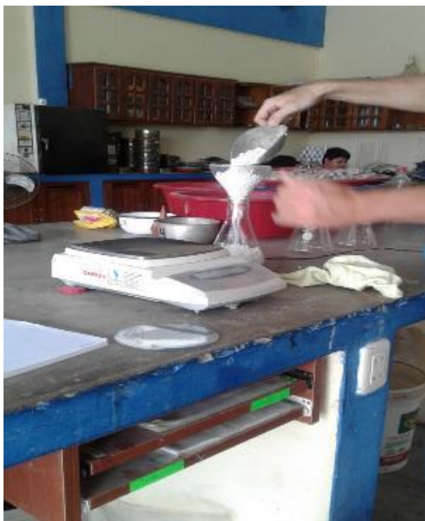
FOTO N° 39: Proceso de llenado de las perlas de poliestireno.
