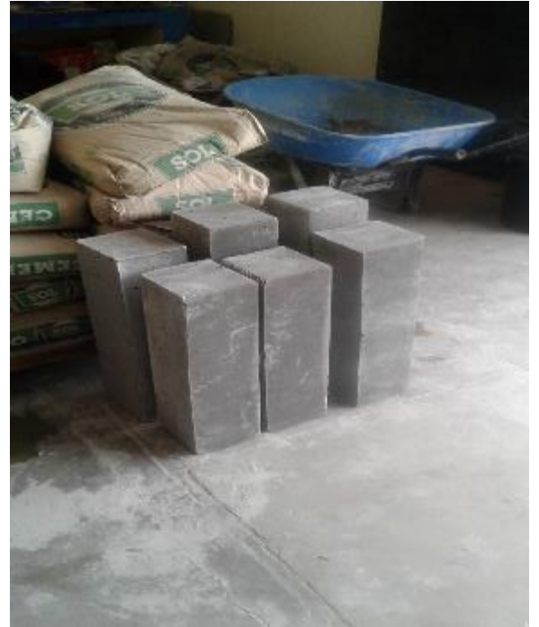
FOTO N° 76: Vista de las vigas desmoldadas.
