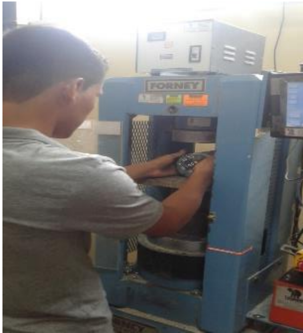
FOTO N° 71: Se colocó la probeta en la maquina para obtencion de la resistencia en los 7, 14 y 28 dias, respectivamente
