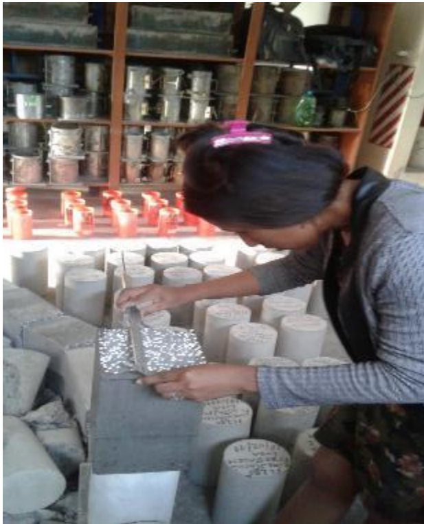
FOTO N° 83: Se toma las medidas ancho y alto de la viga despues de rotura.
