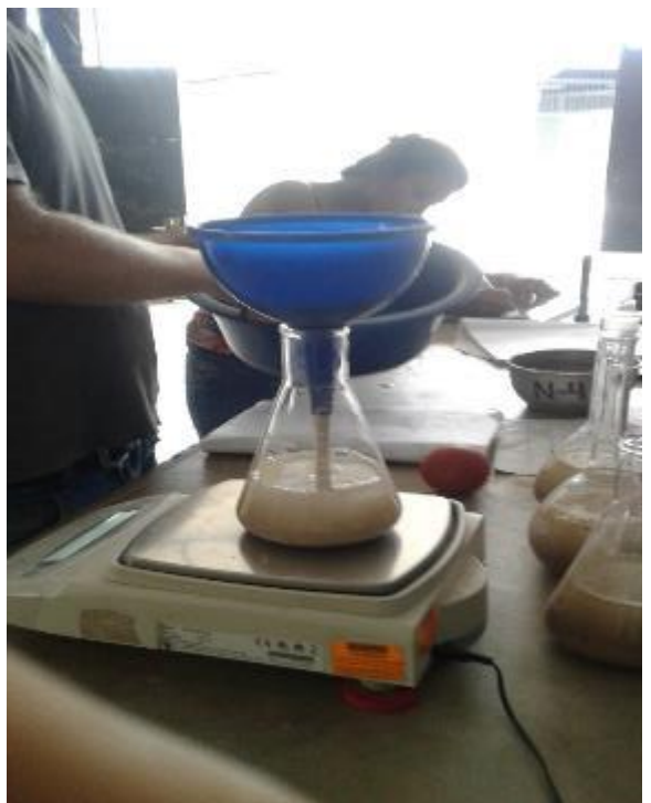
FOTO N° 20: Colocación y peso del agregado fino en el frasco con agua.
