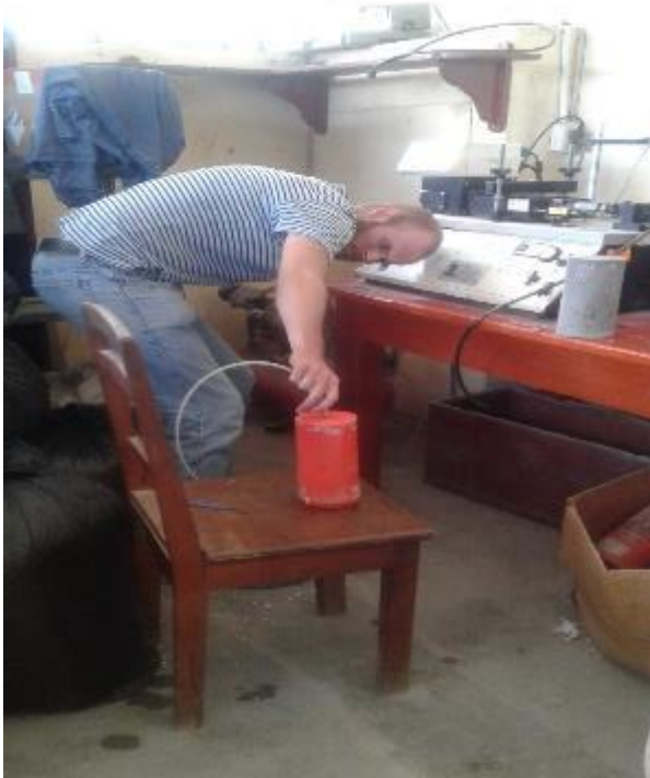
FOTO N° 67: Desmolde de las probetas de los cilindros plasticos.
