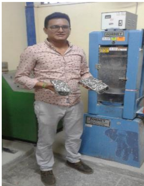
FOTO N° 73: Vista de la probeta despues de rotura.
