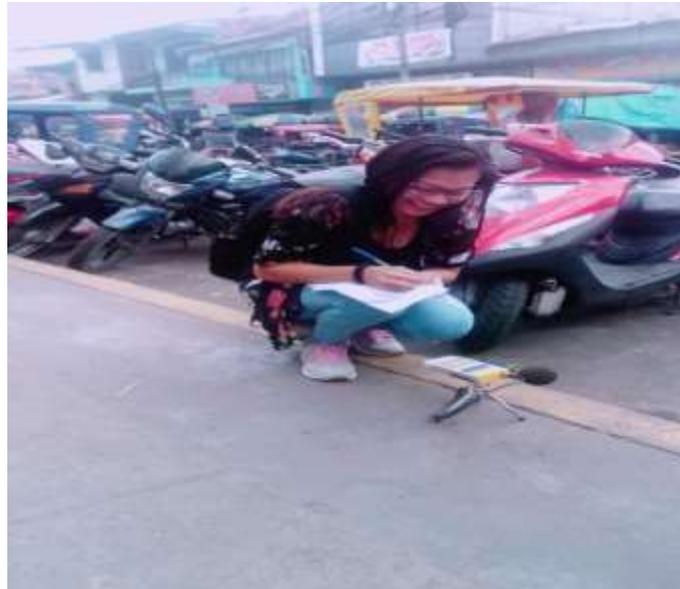
**Figura 3. Monitoreo de las calles utilizando el sonómetro portátil.**
