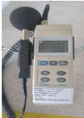
Figura 2. Sonómetro portátil (Sper Scientific)
