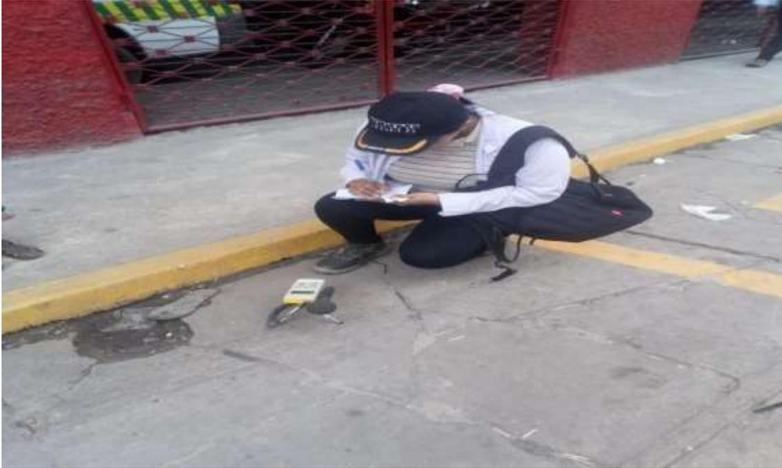
**Figura 5: Monitoreo del ruido utilizando el sonómetro portátil.**
