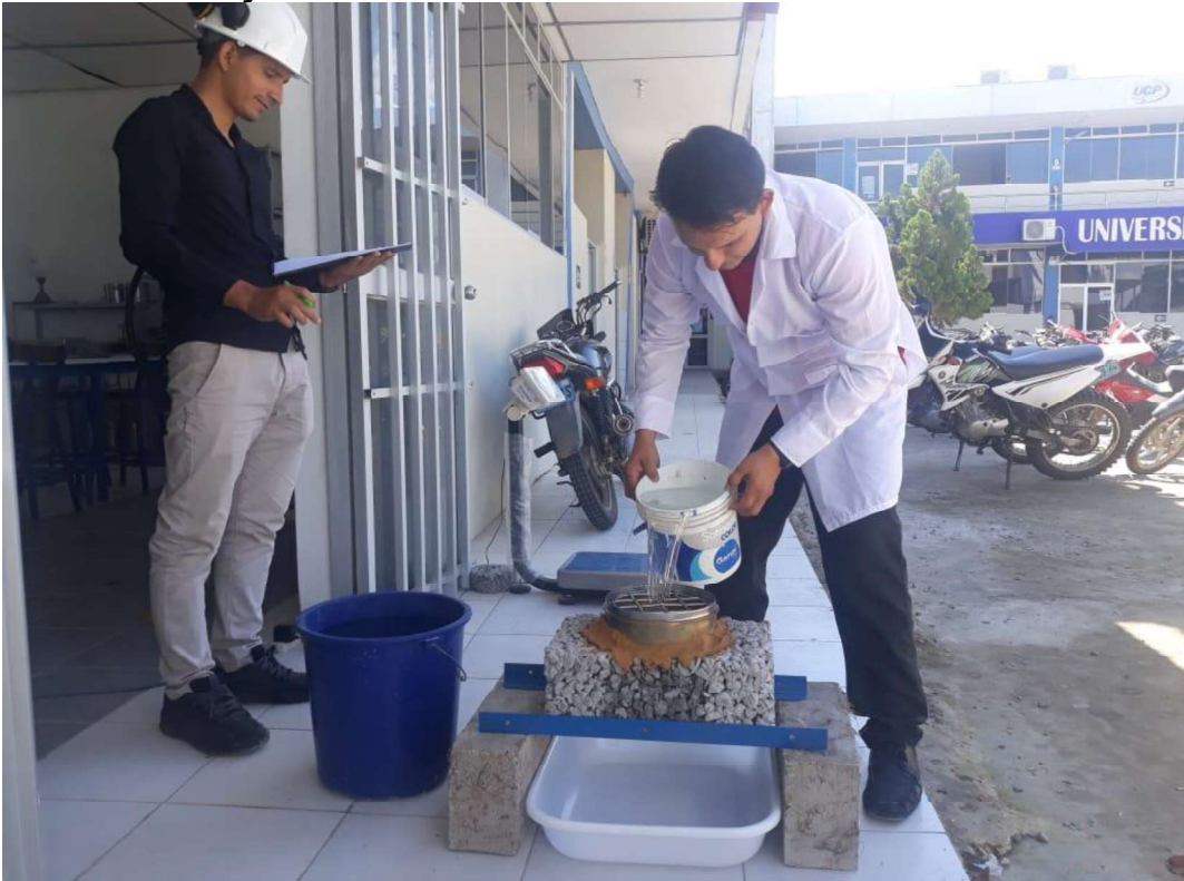
Figura 23. Humedeciendo el testigo de concreto permeable antes de realizar el ensayo de infiltración.
