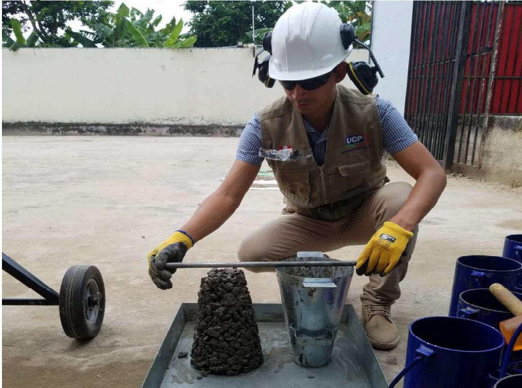
Figura 16. Ensayo de revenimiento del concreto (slump test) para medir la trabajabilidad del concreto en estado fresco.
