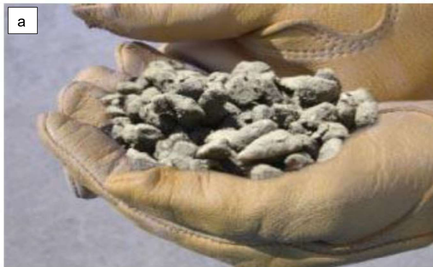
Figura 2. Ejemplos de concretos permeables con diferentes contenidos de agua, formados en una pelota: (a) muy poca agua, (b) cantidad de agua adecuada, (c) Mucha agua. Fuente: Pervious Concrete Pavements (Paul D. Tennis).
