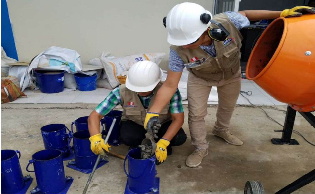
Figura 17. Llenado del concreto en los moldes de probeta para posteriormente realizar el curado.
