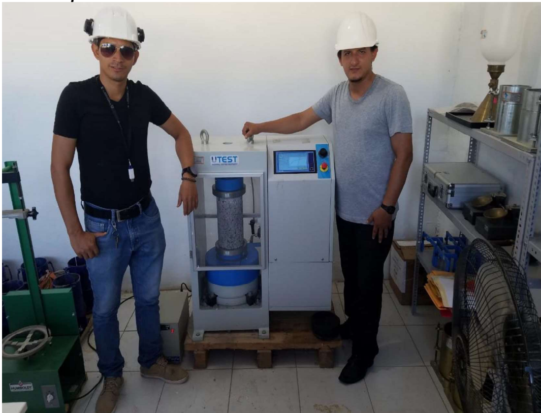
Figura 20. Prueba de resistencia a la compresión de los testigos de concreto permeable.
