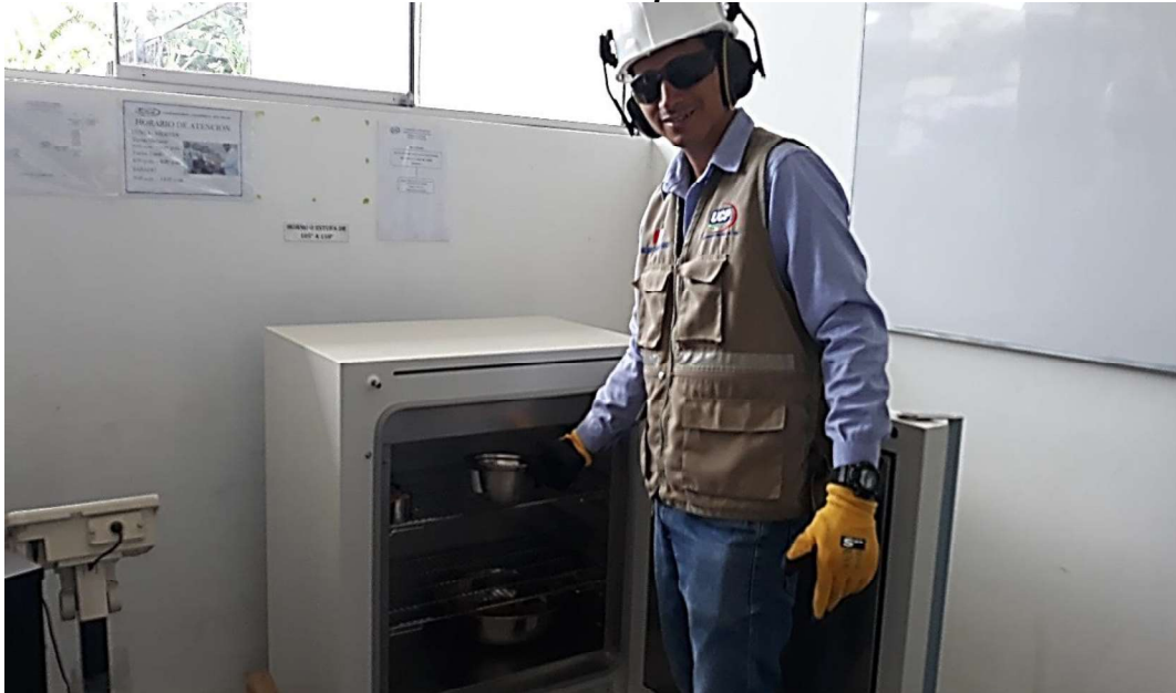
Figura 9. Colocación de la muestra de agregado grueso ensayo de contenido de humedad en el horno a temperatura 110 \pm 5 °C.
