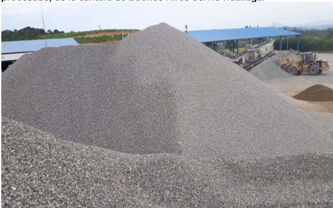
Figura 6. Agregado grueso almacenado después de ser extraído y procesado, de la cantera de Buenos Aires del río Huallaga.
