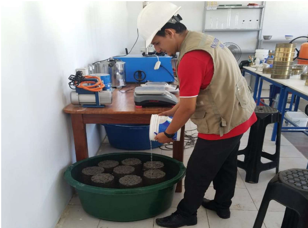
Figura 18. Curado de los testigos de concreto permeable durante 7 y 14 días.
