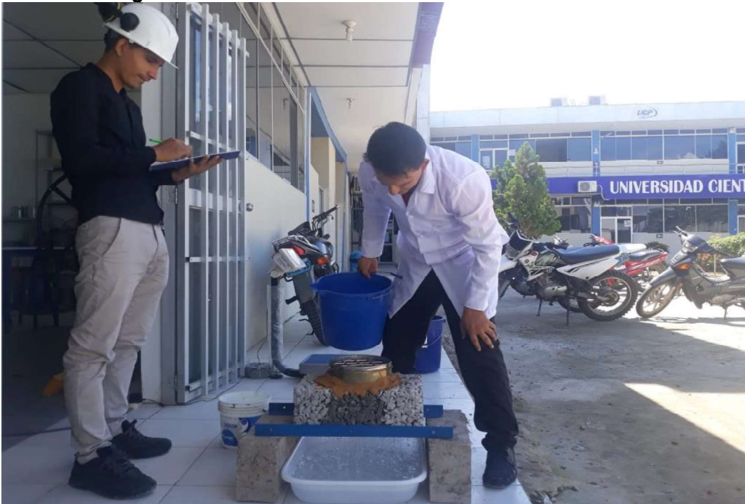
Figura 24. Realizando del ensayo de infiltración y tomando datos obtenidos según la norma ASTM C 1701.
