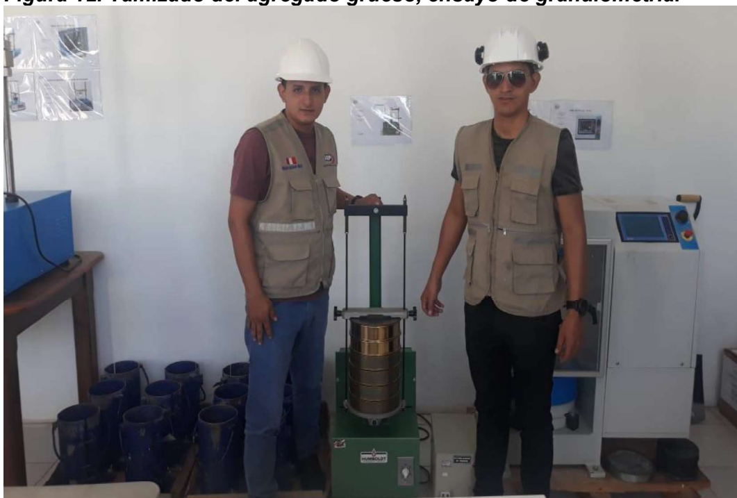
Figura 12. Tamizado del agregado grueso, ensayo de granulometría.
