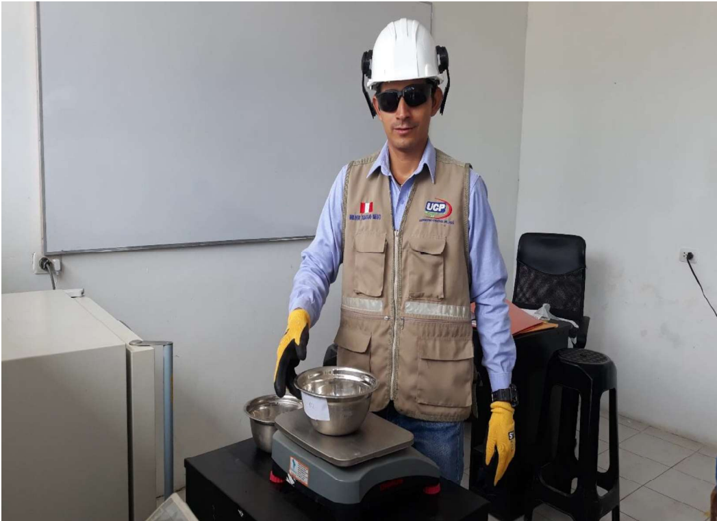
Figura 8. Pesado de muestra del agregado grueso para ensayo de contenido de humedad
