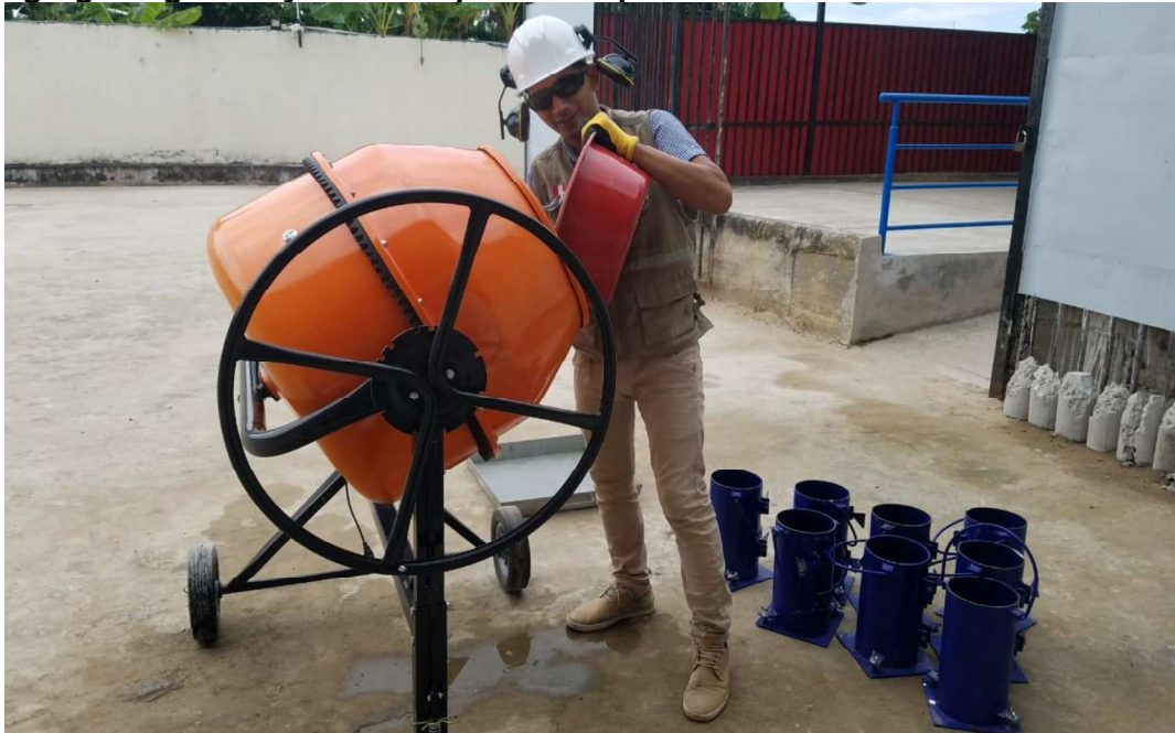
Figura 15. Preparación de la mezcla de concreto agregando agua, agregado grueso y cemento portland tipo I.
