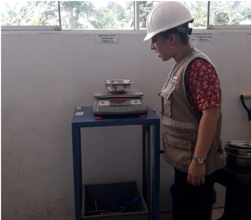
Figura N° 29: Pesado de los agregados.
