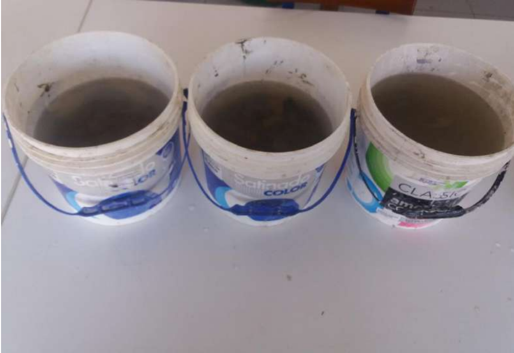
Figura N° 22: Reposo del agregado en agua durante 24 horas
