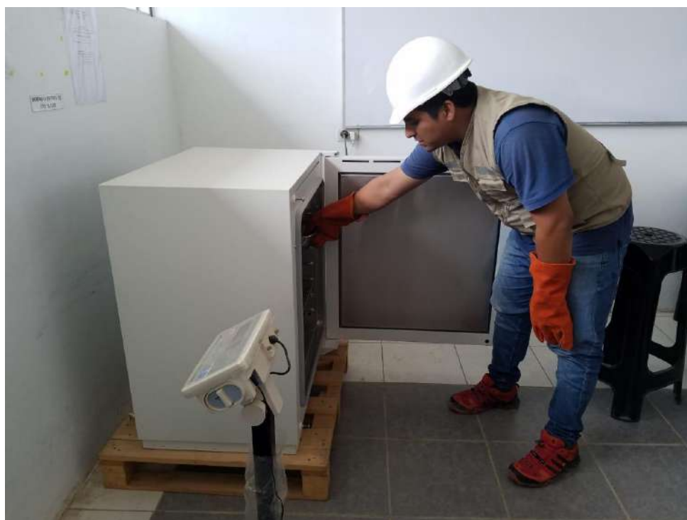
Figura N°11: Puesta de las muestras en el horno para el debido ensayo.
