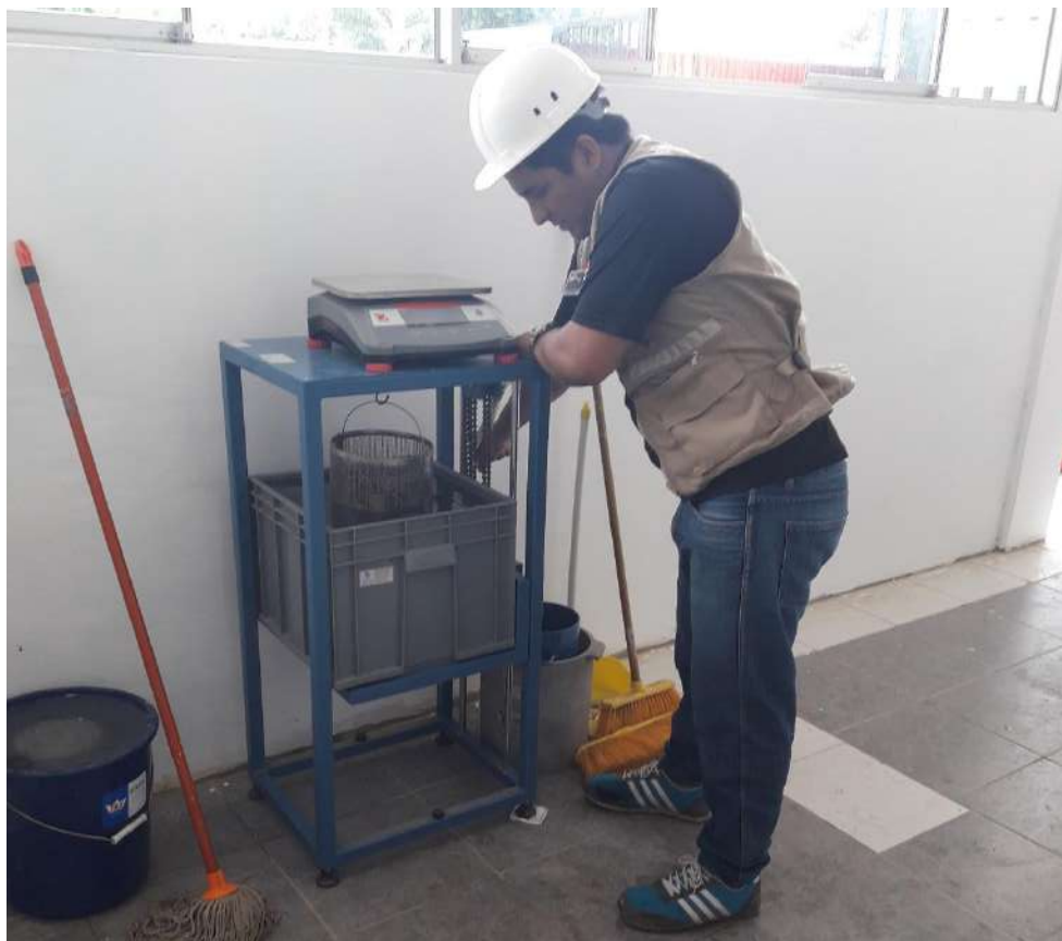
Figura N° 24: Pesado en la balanza hidráulica
