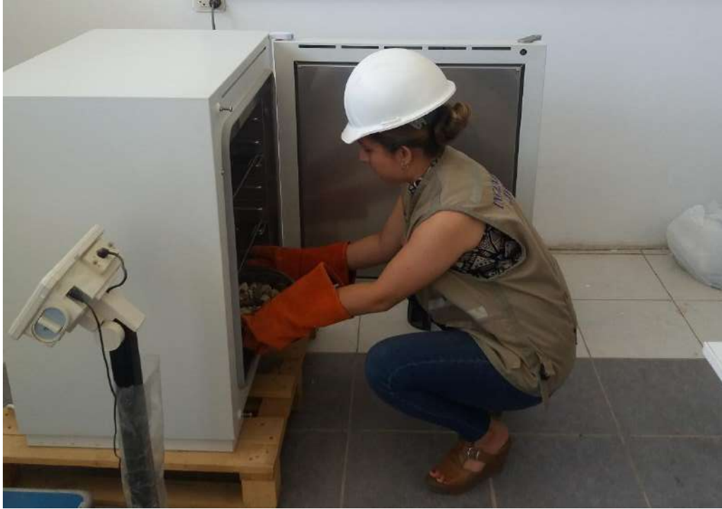
Figura N° 28: Puesta del agregado en el horno
