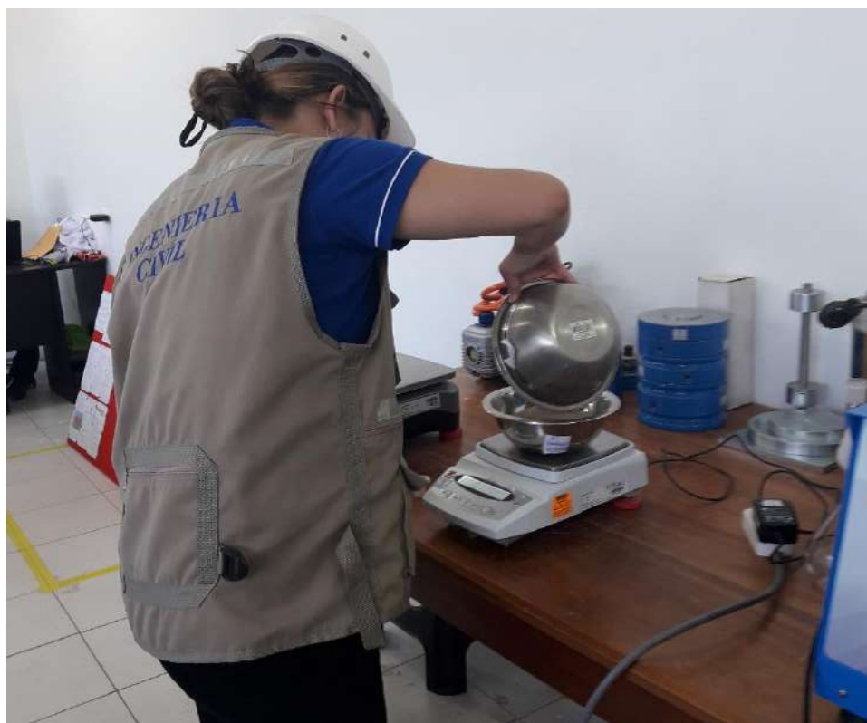
Figura N°10: Pesado de los agregados.
