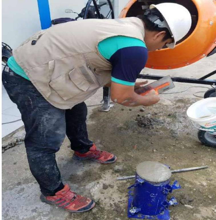
Figura Nº 32: Colocación del concreto en las probetas durante 24 horas y se puede visualizar el enlace.
