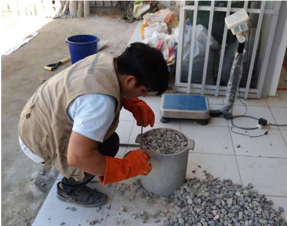
Figura Nº 16: Puesta en molde y enrase para el peso unitario suelto, el cual se hizo para todos los agregados tanto fino y grueso.
