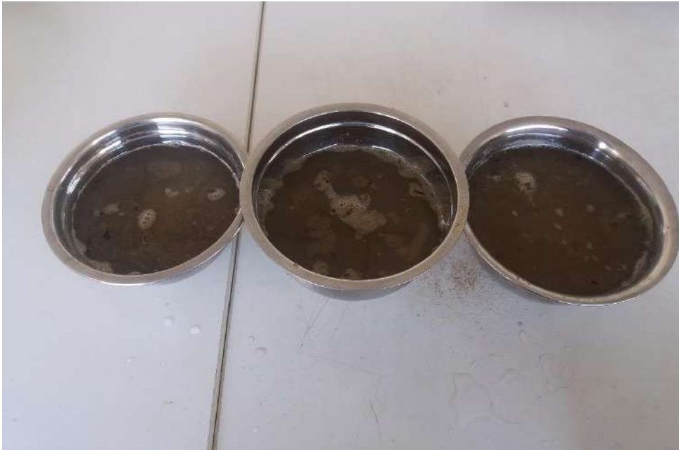
Figura N° 18: Muestras en agua durante 24 horas.
