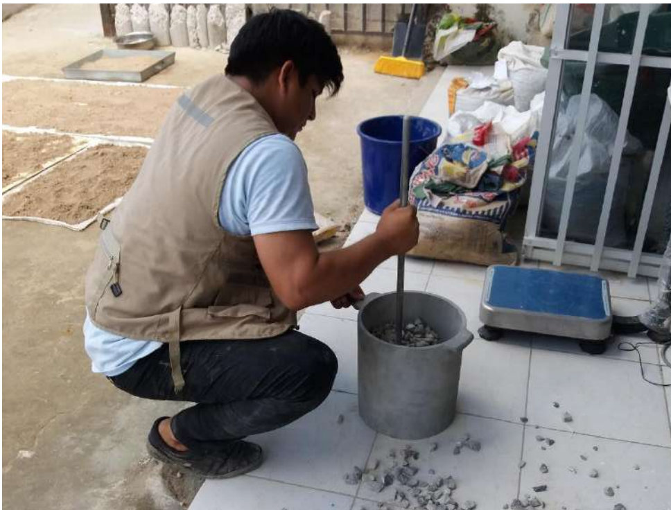
Figura Nº17: puesta en molde del agregado y varillado para el peso unitario compactado se hizo para todos los agregados tanto fino y grueso.
