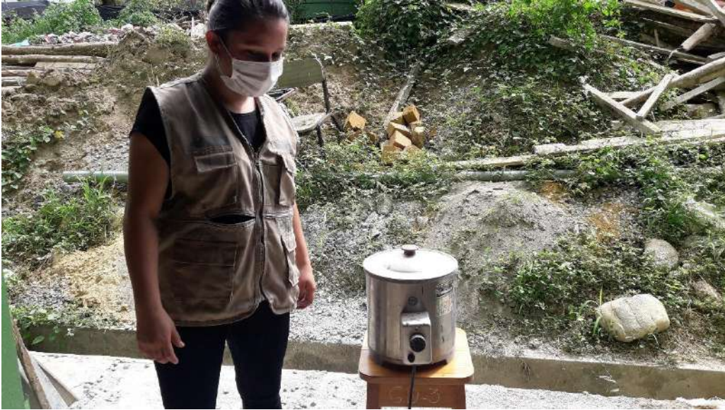
Figura N° 34: Calentamiento del mortero de azufre hasta derretirlo
