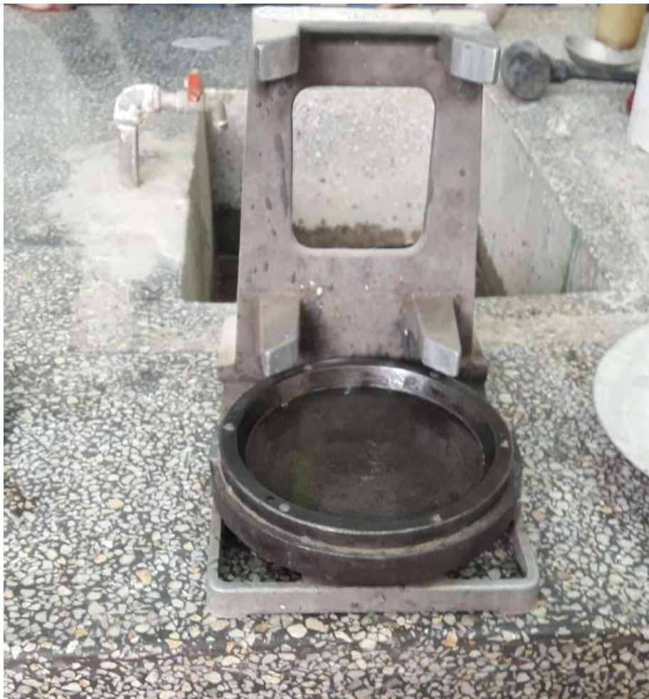
Figura N° 35: Molde para refrentado con mortero de azufre.
