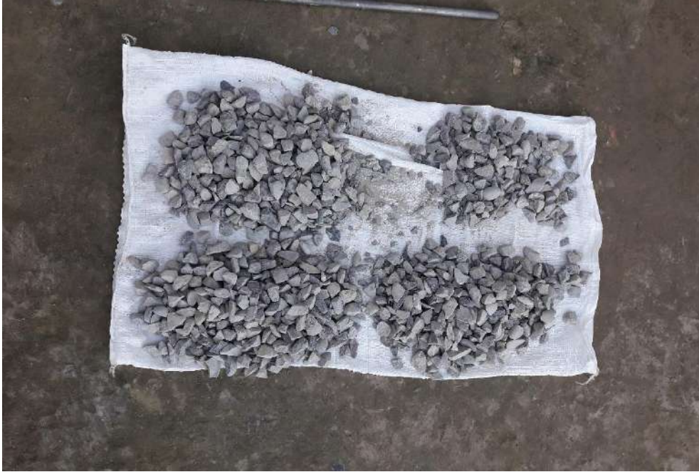
Figura N° 12: Cuarteo del agregado para obtención de muestra, así se elaboró para todos los agregados correspondientes.
