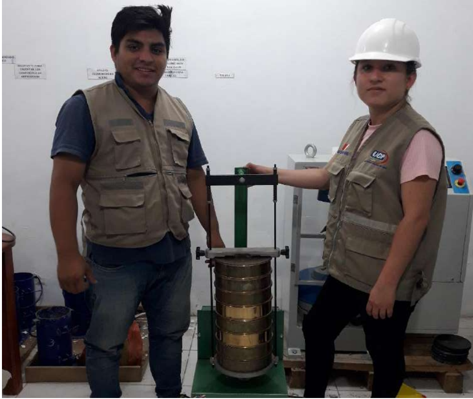
Figura N° 14: Zarandeo de la muestra que pasa por los tamices.
