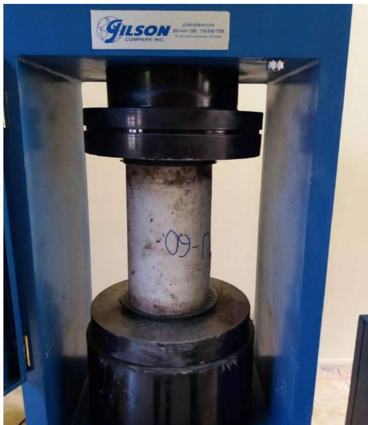
Figura N° 37: Rotura de los especímenes sometidos a las pruebas con cabeceo Mortero de azufre.
