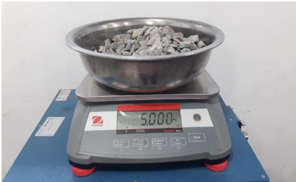
Figura N° 13: Pesado de los agregados.
