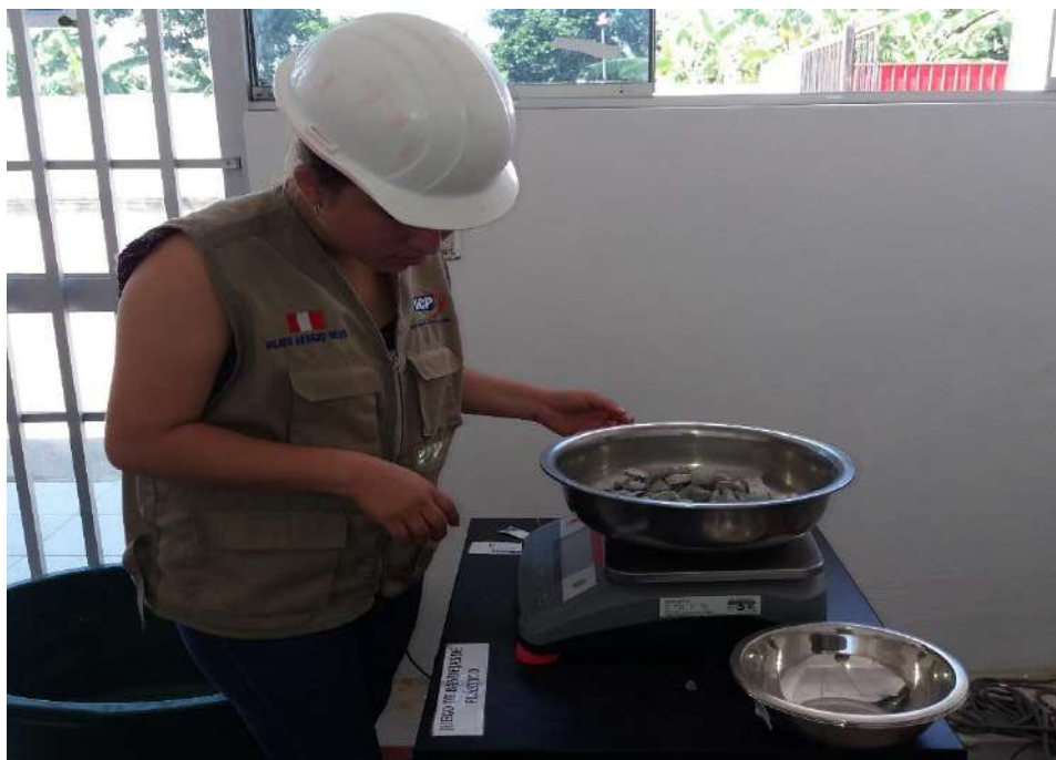
Figura N° 26: Pesado del material, este procedimiento se efectuó también para el agregado fino.
