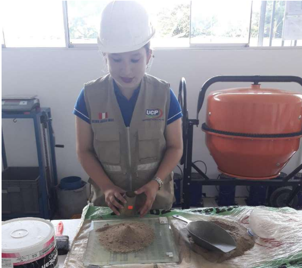
Figura N° 20: Verificación de la arena si está completamente seca
