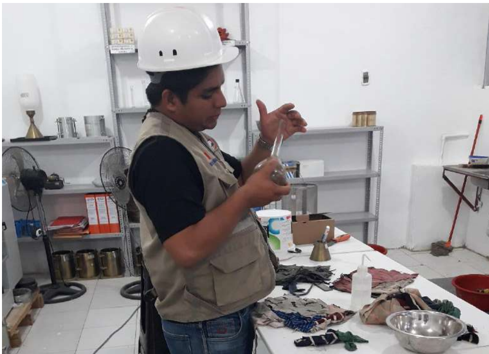
Figura N° 21: Extracción de las burbujas de aire para luego ser secada en horno durante 24.
