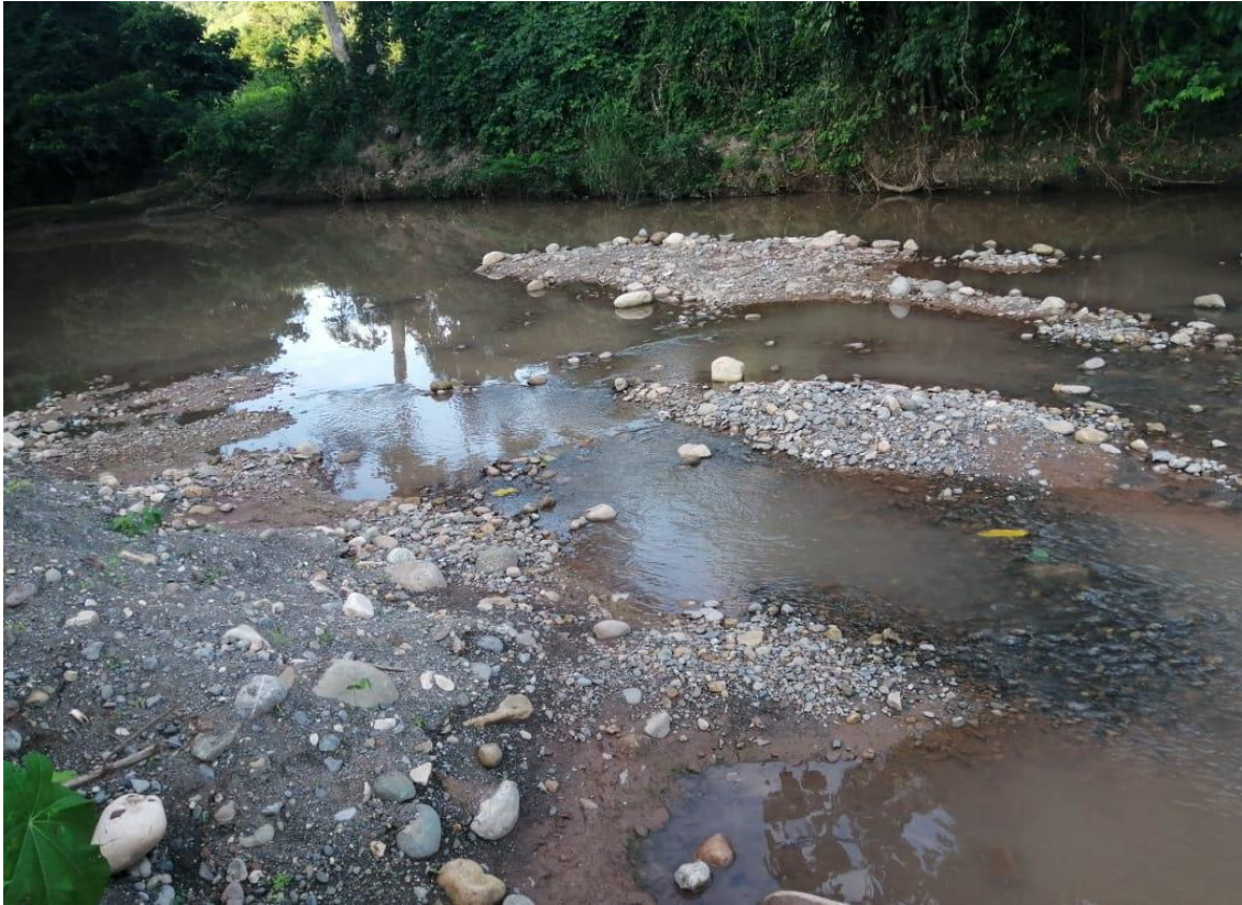
FOTO N°13: LAS CANTERAS PRESENTA LIGANTE JUNTO AL MATERIAL GRANULAR
