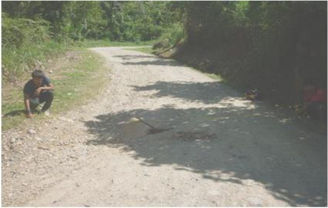
FOTO N°03: EN LA FOTO SE OBSERVA LA DETERMINACION DEL ANCHO DE LA SUPERFICIE DE RODADURA, Y LA TOPOGRAFIA DEL TRAMO.
