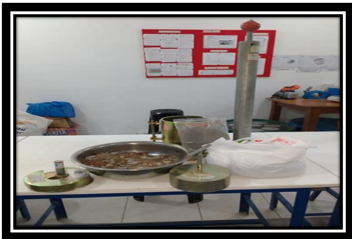
Foto N° 33: Materiales y equipos para ensayo de CBR de Base y Sub Base Granular
