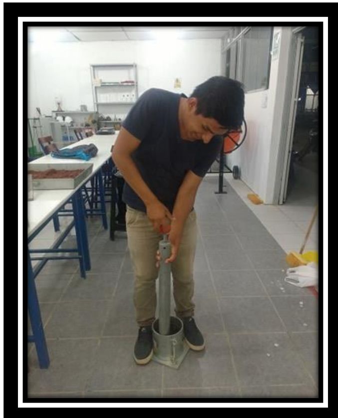
Foto N° 27: Realizando el N° de golpes respectivos del ensayo de proctor
