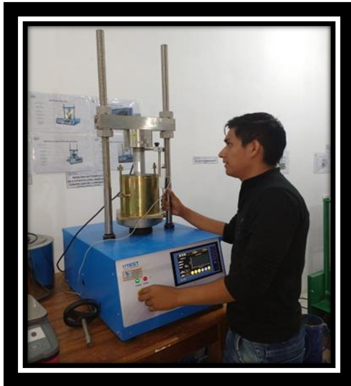
Foto N° 34: Muestra de Base granular sometida a penetración de carga de acuerdo al requerimiento de ensayo
