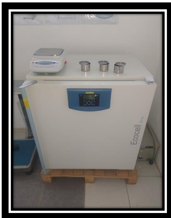
Foto N° 11: Equipos y materiales para ensayo de contenido de humedad
