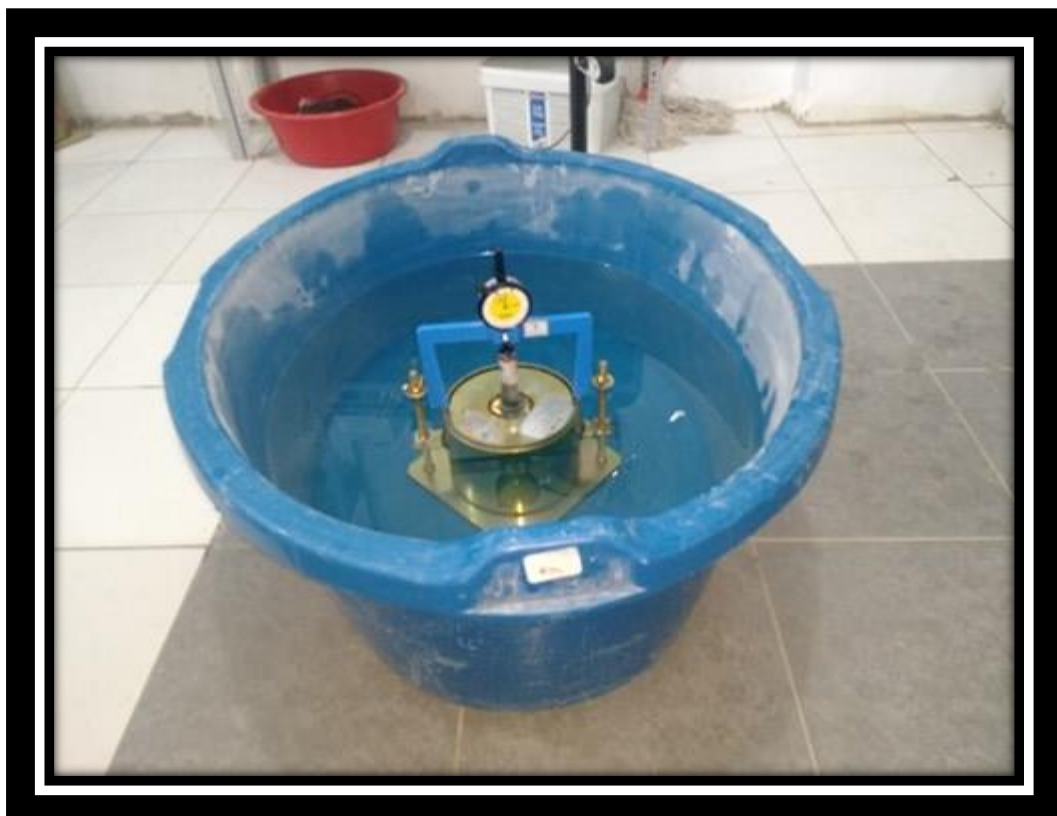
Foto N° 29: Muestra saturada y con su respectiva medida de expansión
