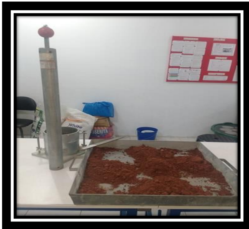
Foto N° 29: Muestra saturada y con su respectiva medida de expansión
