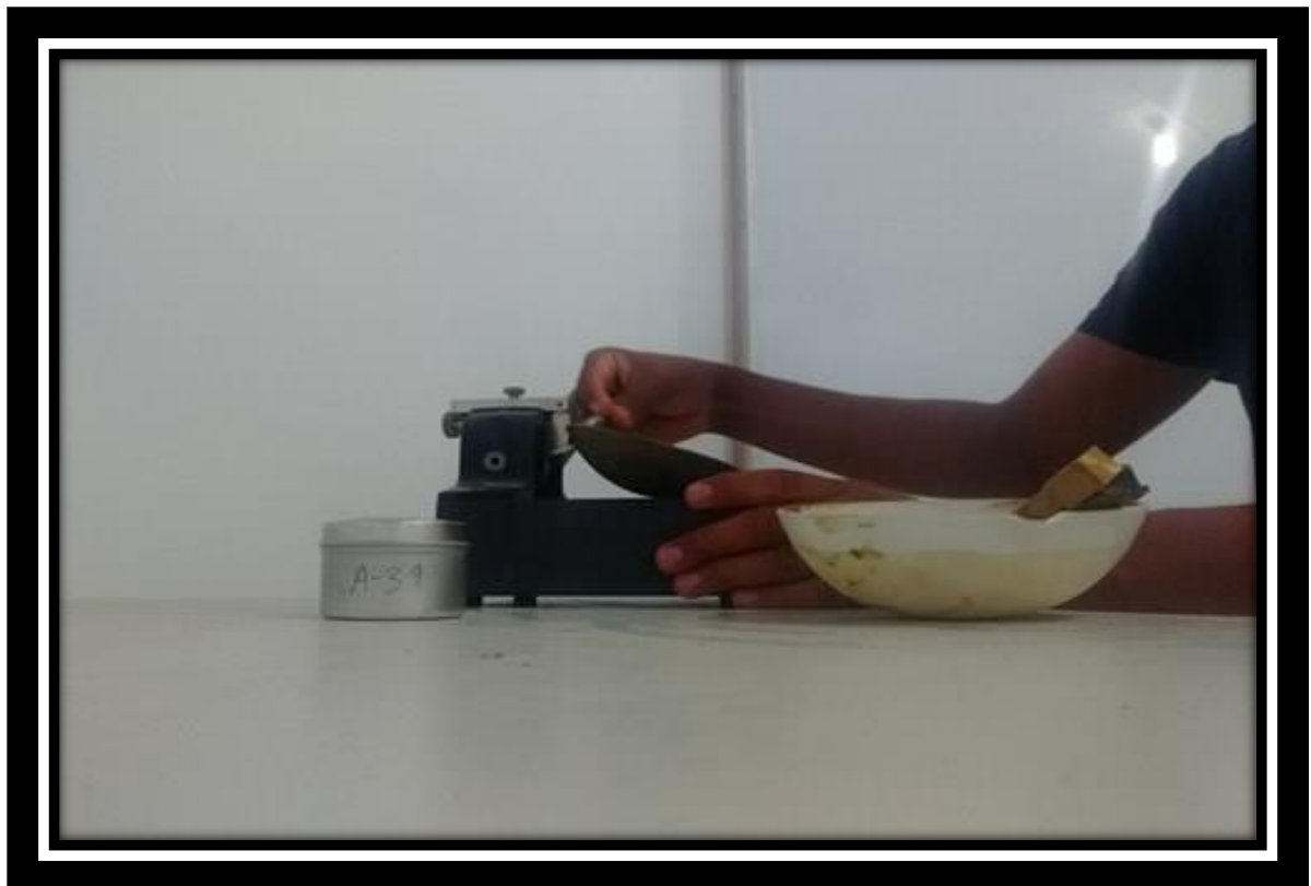
Foto N° 16: determinando el número de golpes en el aparato de Casagrande
