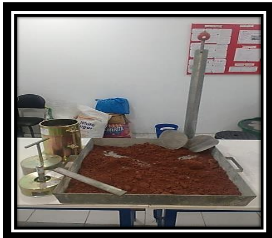
Foto N° 20: Equipos y materiales para ensayo de proctor modificado
