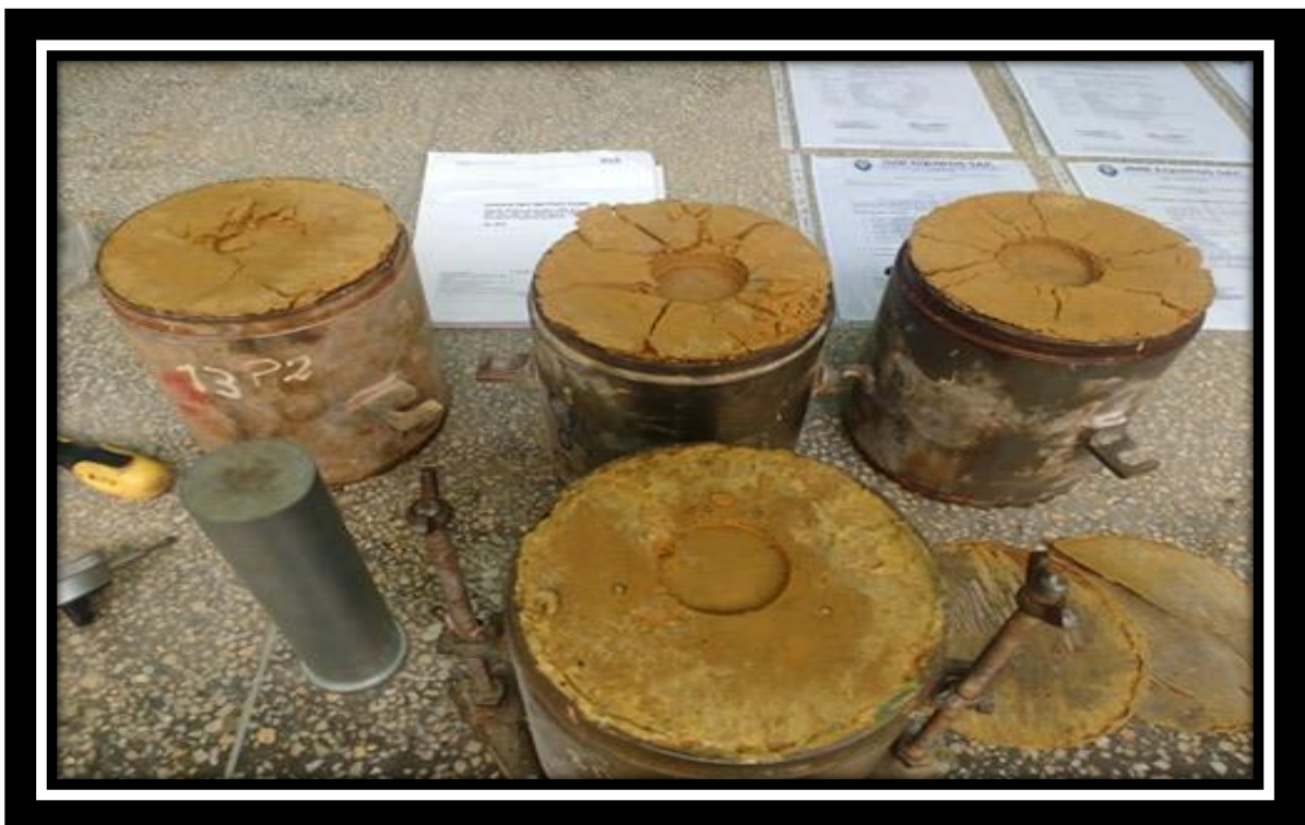
Foto N° 31: Muestras después de haber sido sometido a la compresión
