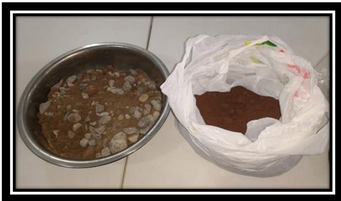
Foto N° 32: Muestras extraídas para las capas de Base y Sub Base Granular
