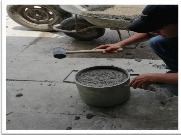
Gráfico N°18. Ensayo de exudación en recipiente de 10" de diámetro Fuente: Elaboración propia (2019)
