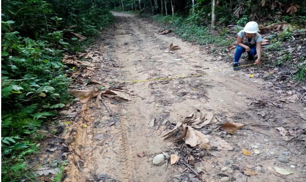
Foto 5: Determinación de ancho de la superficie de rodadura.
