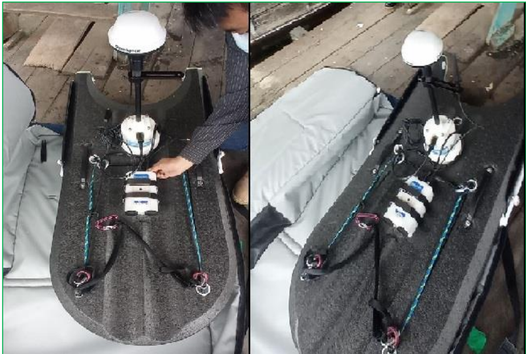
Figura 4. Preparación e instalación del Equipo ADCP
