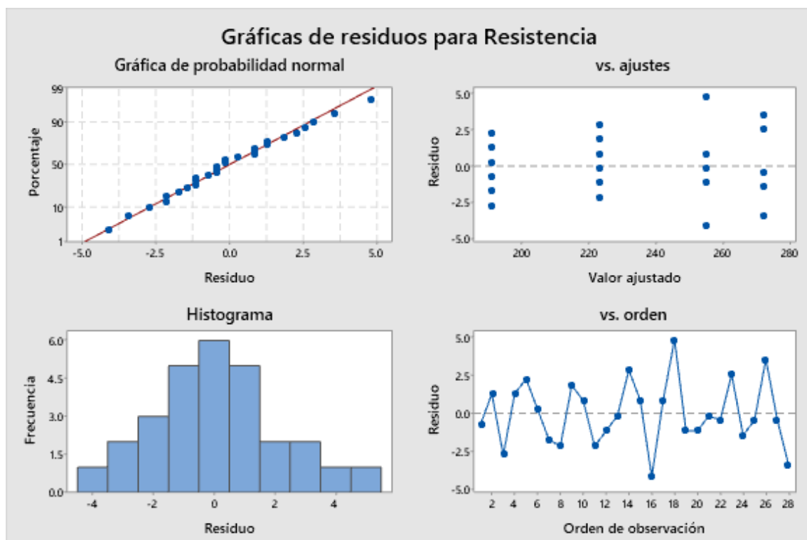
Fig. 3: Grafico de residuos para resistencia a 7 días de curado En la gráfica de probabilidad normal, los puntos se distribuyen linealmente, sugiriendo normalidad en los residuos. El gráfico de Residuo vs. Ajustes no muestra patrones, indicando una varianza constante en los residuos. El histograma presenta una forma de campana, apoyando la suposición de normalidad en los residuos. El gráfico Residuo vs. Orden no muestra autocorrelación en los residuos. Por lo que los gráficos sugieren que el modelo de regresión es adecuado, con residuos normales.
