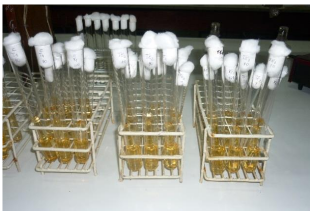
Fig. 20 Diversos tubos con caldo lauril y los tubos de Durham invertidos.
