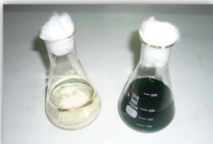
Fig 23 Preparación del caldo E.Coli (izquierda) y caldo Brila (derecha) en la fase confirmativa.
