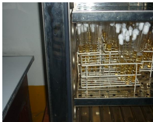
Fig. 21 Tubos con caldo lauril sulfato y la muestra original introducido en la estufa a 37 ° por un lapso de 48 horas.
