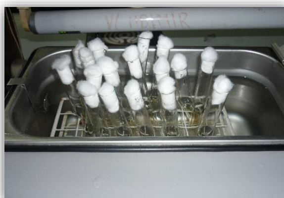
Fig. 26 tubos con caldo E.Coli en baño maria a 44.5°C por un lapso de 48 horas.
