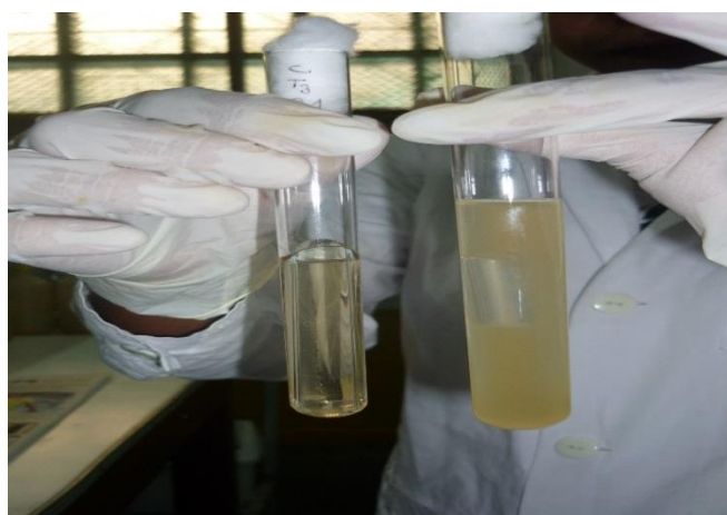
Fig.22 A la izquierda un tubo negativo y a la derecha un tubo positivo (presencia de gas) en fase presuntiva.
