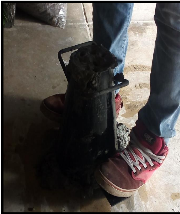
Proceso del cono de Abrams
