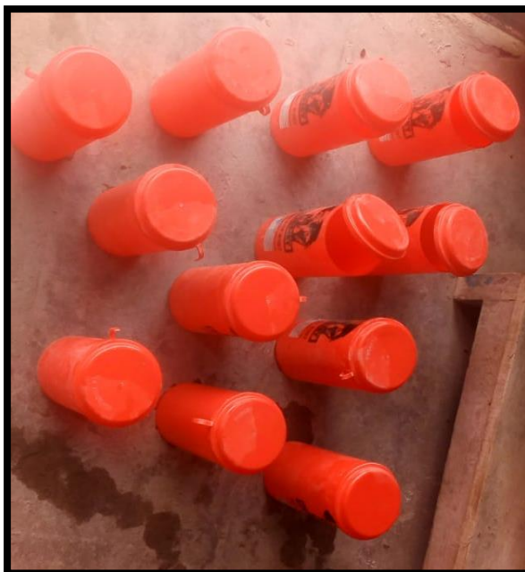
Moldes limpios y pasados con petróleo listo para proceder al moldeo.
