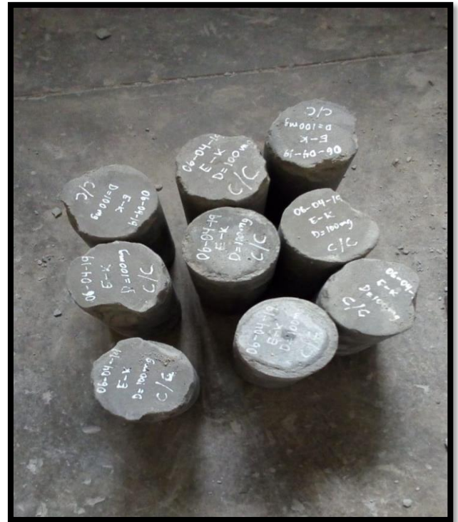
Muestras ya sometidas a Compresión
