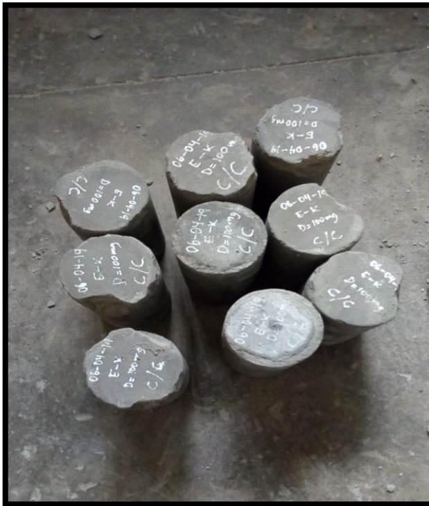
Muestras ya sometidas a Compresión
