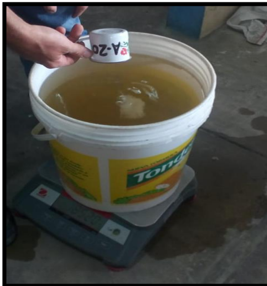
Dosificación de cloro al agua contaminada
