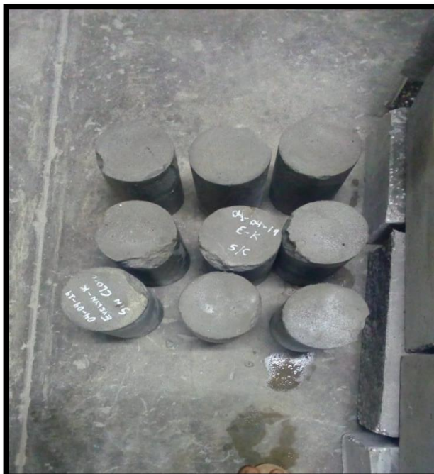
Muestras ya sometidas a Compresión
