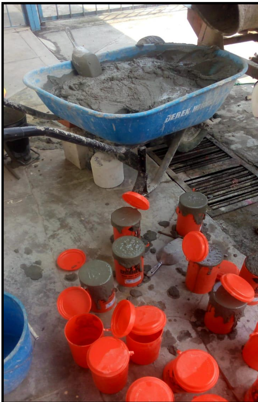
Probetas en proceso de llenado y varillado los 25 golpes por cada capa.
