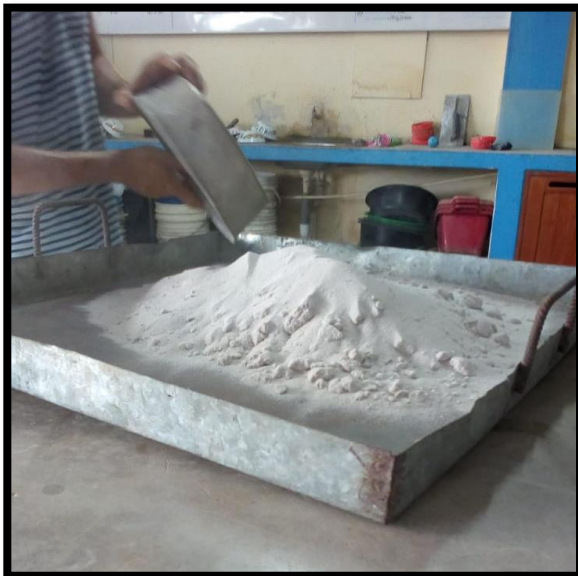
Muestra del P.E. seco del suelo
