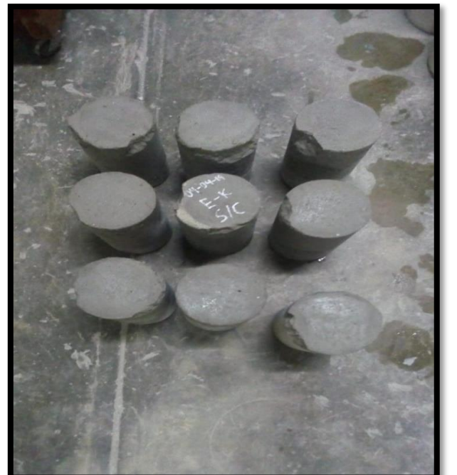
Muestras ya sometidas a Compresión
