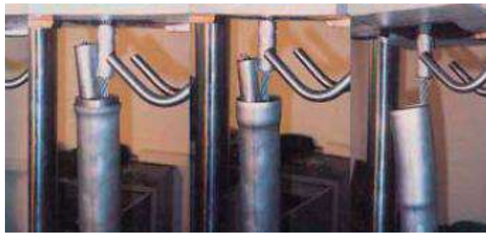
Figura 08. Sistema de frenado a base del ensanchamiento de un tubo de acero.
