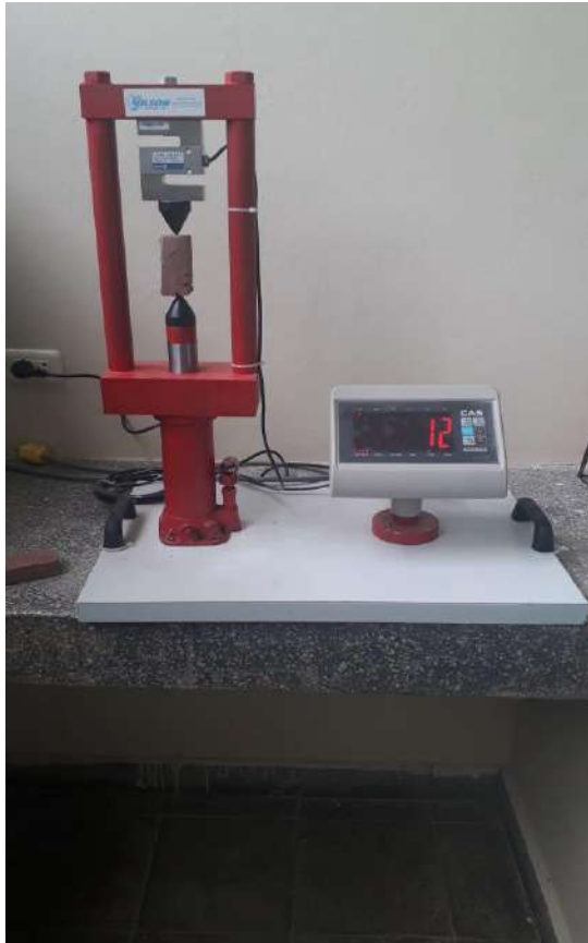
Foto n° 05. Ensayo de Carga Puntual
