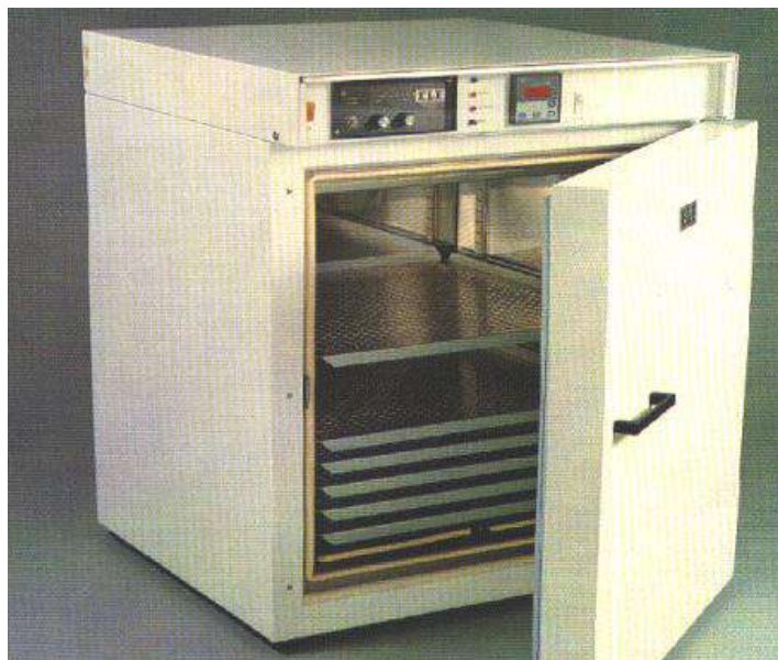
Figura 19. Horno de secado de temperatura regulable. Fuente: ELE Internacional Ltda., 1993.
