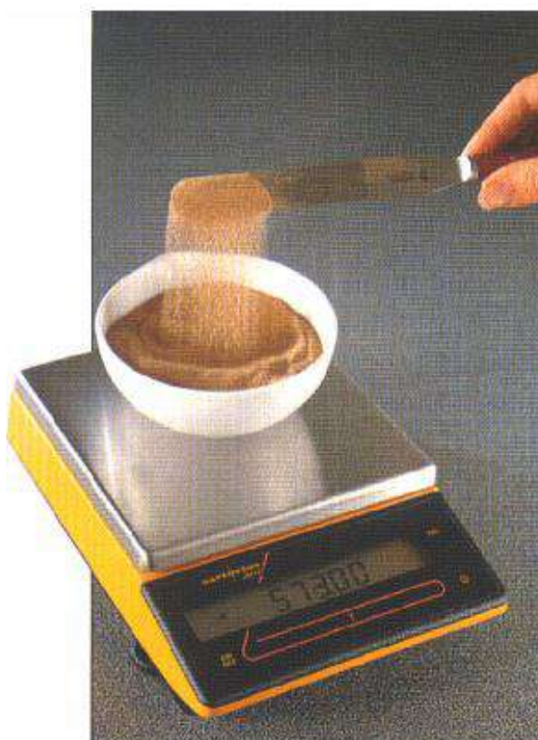
Figura 20. Balanza electrónica de precisión 0.01 gr. Fuente: ELE Internacional Ltda., 1993
