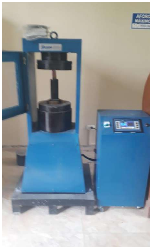
Foto N° 06. Ensayo de compresión uniaxial.
