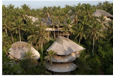
Vivienda de carácter orgánico con estructura de bambú y recubrimiento con hoja de palmeras
