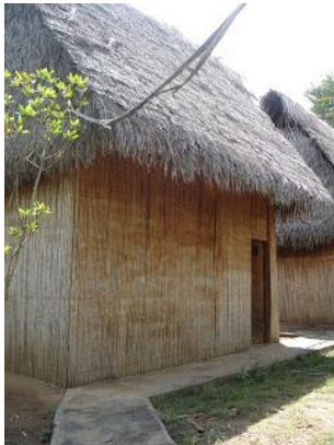
Vivienda Rustica con techo a dos aguas asentado en piso natural y en pilotes de madera
