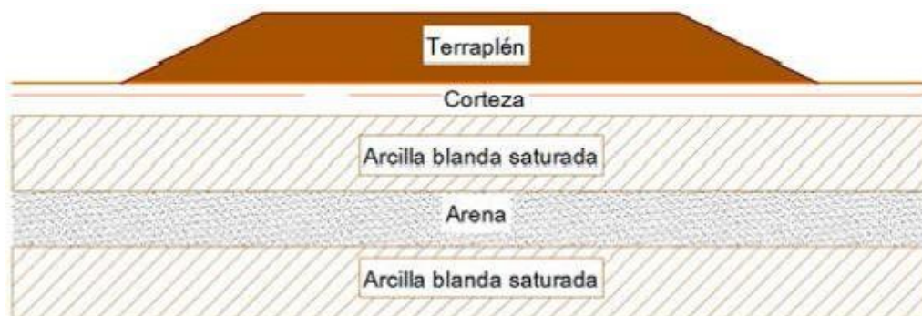
Ilustración 2: Configuración típica de estratos de suelo bajo un terraplén
