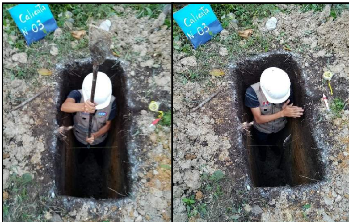
Foto 30: Caída de la barra por efecto de gravedad con la punta hacia abajo desde la altura del hilo en C-03
