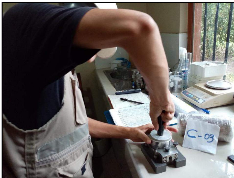
Foto 60: Muestra ya pesada colocada en la caja de corte (C-03)
