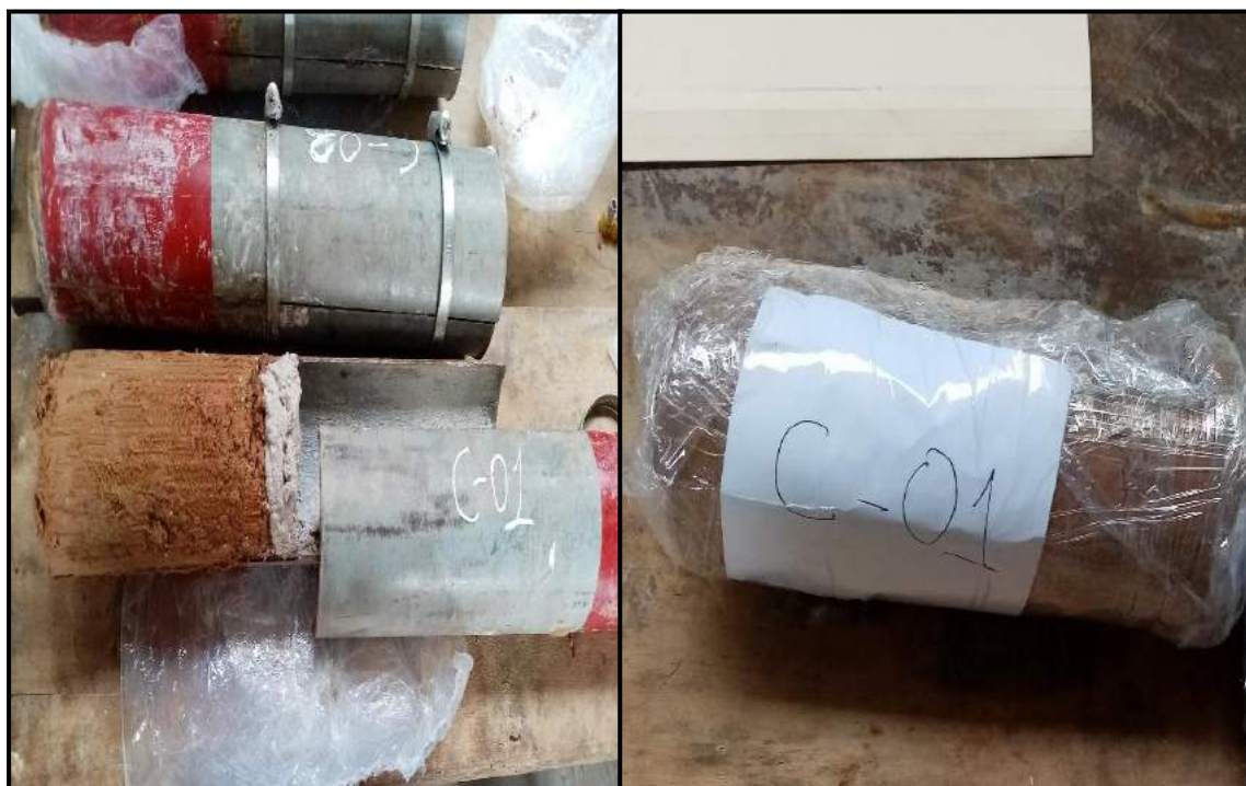
Foto 38: Extrayendo la muestra del molde en el laboratorio (C-01)
