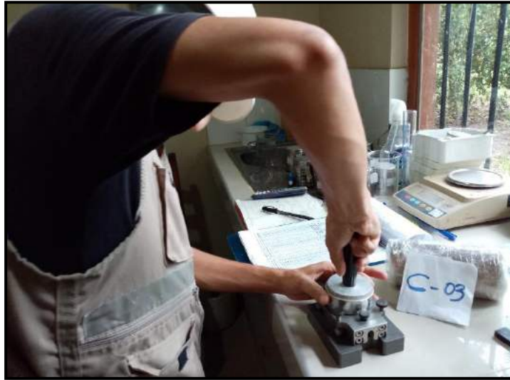
Foto 17: Colocación de la muestra en la caja de corte.
