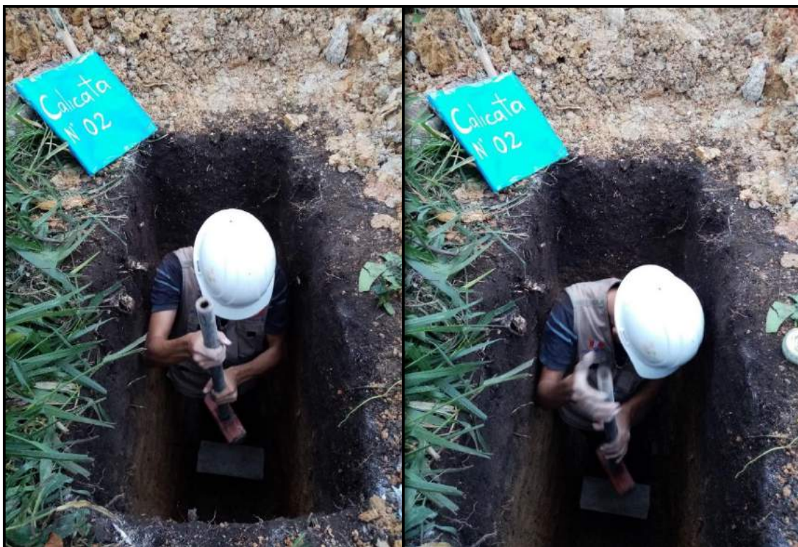
Foto 45: Se ejerce presión en el molde dejando caer la comba por efecto de gravedad para toma de muestra en C-02
