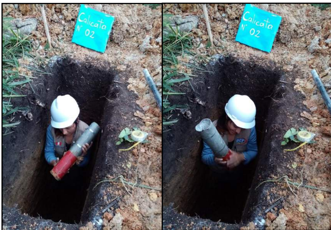
Foto 47: Retiro del molde con la muestra en C-02
