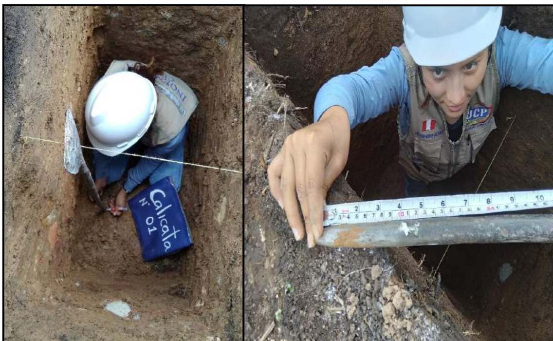
Foto 25: Medición de la profundidad de perforación de la barra en el suelo en C-01
