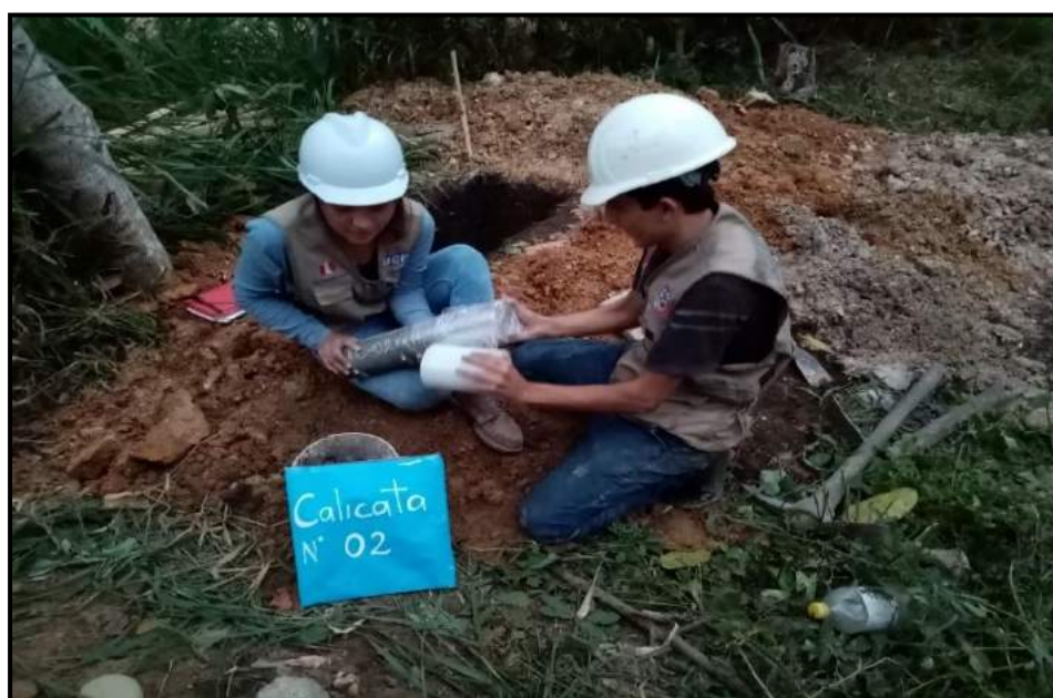
Foto 48: Protección de la parte inferior del molde con film, para que la muestra no se altere (C-02)
