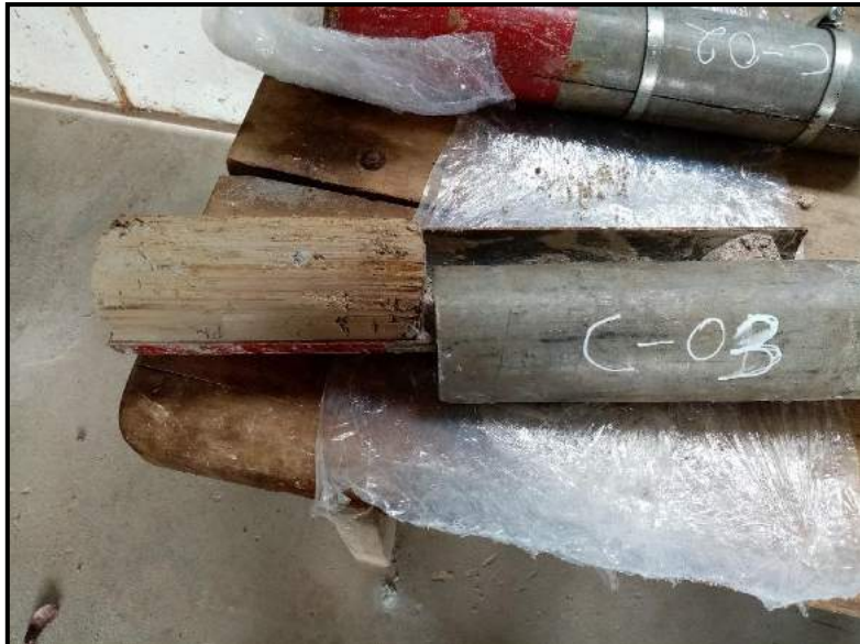
Foto 14: Extracción de la muestra del molde.
