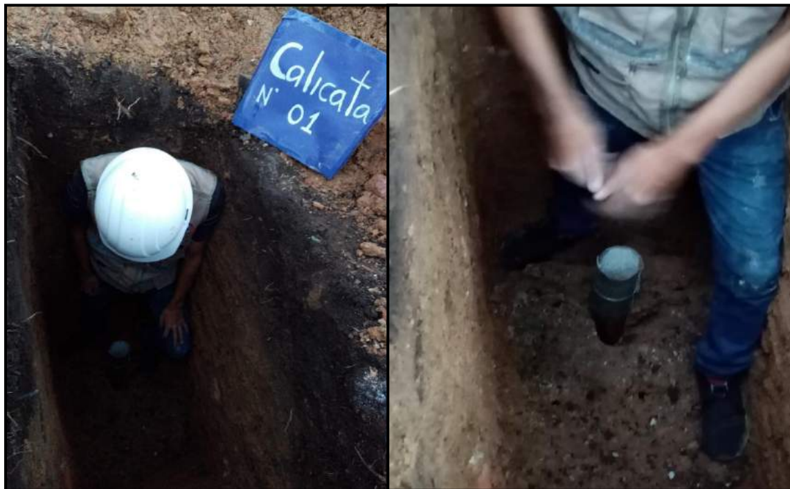
Foto 34: Se coloca mezcla de yeso en la parte superior del molde para que la muestra no se vaya a alterar en C-01
