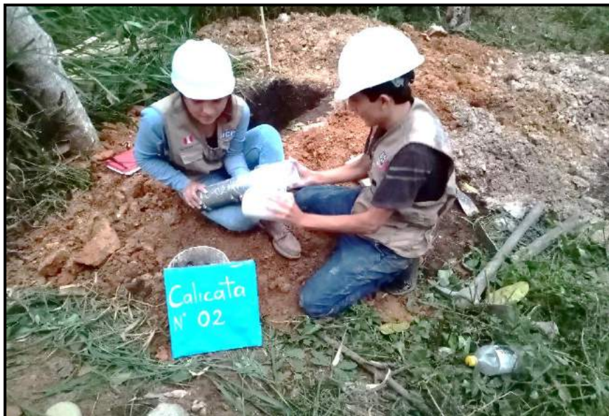
Foto 7: Protección de parte inferior de muestra con film
