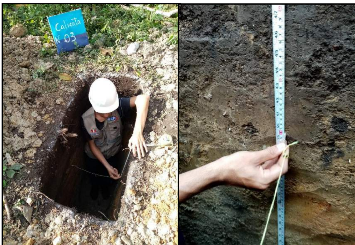
Foto 29: Medición de 1 m desde el fondo de calicata y colocación del hilo con clavos en C-03
