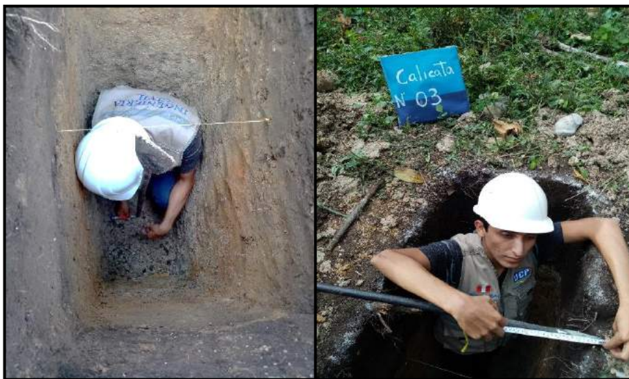
Foto 22: Toma de medida de la profundidad de perforación de la barra en el suelo
