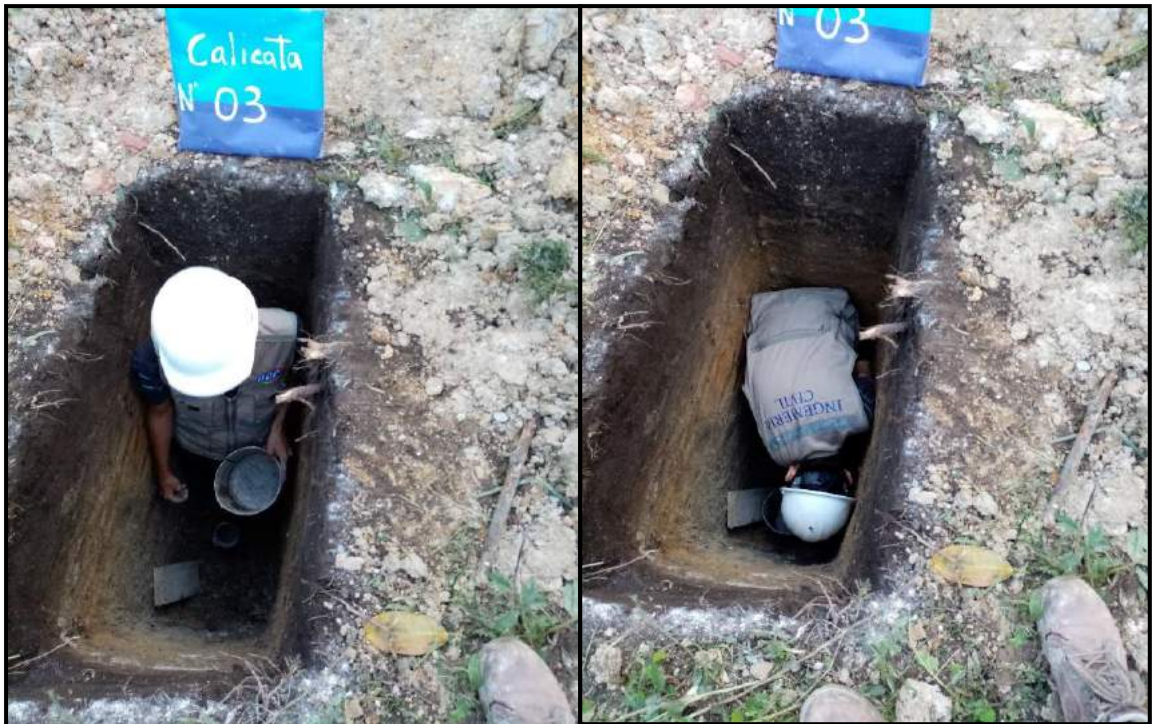
Foto 55: Se coloca mezcla de yeso en la parte superior del molde para que la muestra no se vaya a alterar en C-03
