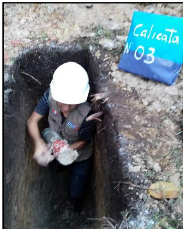
Foto 56: Retiro del molde con la muestra en C-03
