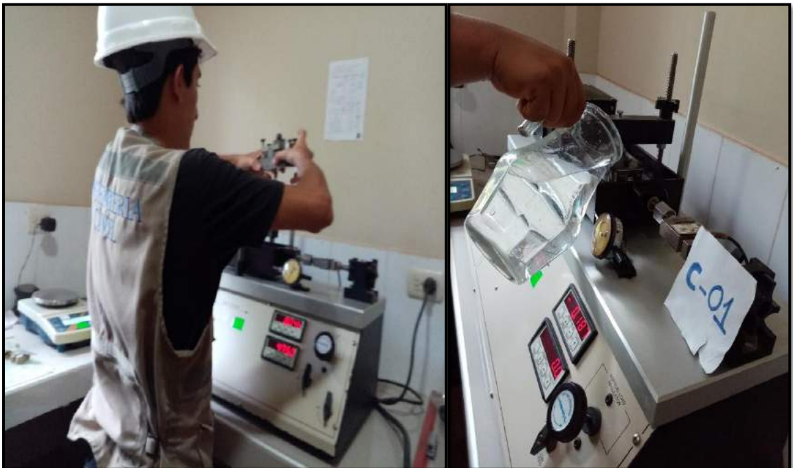
Foto 42: Colocación de la caja de corte con la muestra en la máquina del corte directo (C-01)
