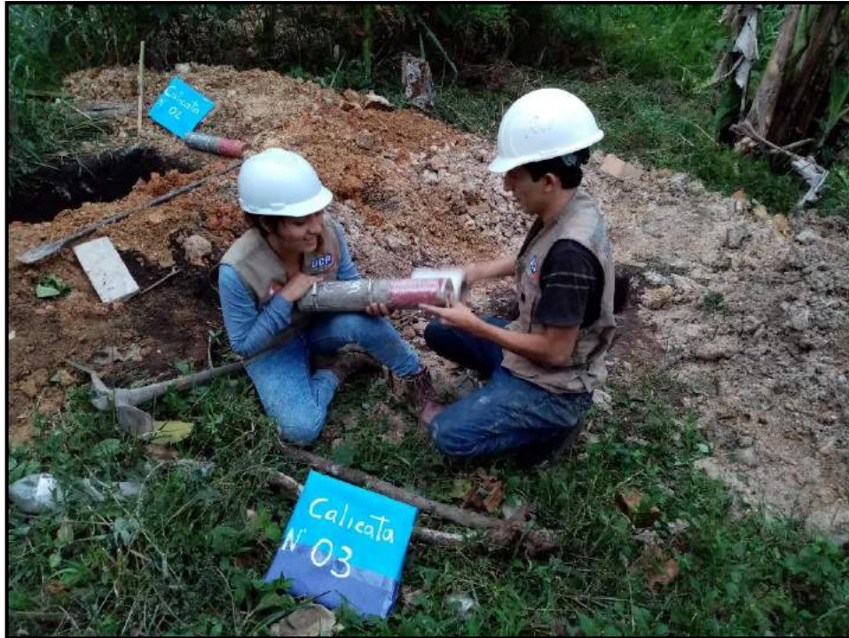
Foto 57: Protección de la parte inferior del molde con film, para que la muestra no se altere (C-03)
