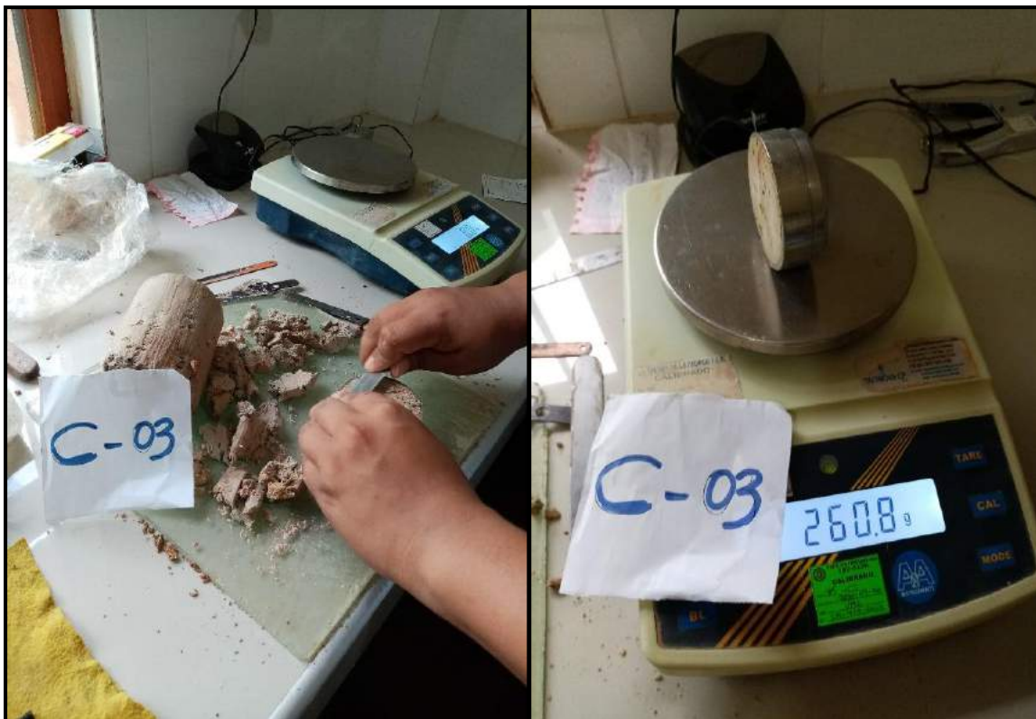
Foto 59: Enrase de las superficies planas de la muestra en el anillo de corte y pesándola (C-03)
