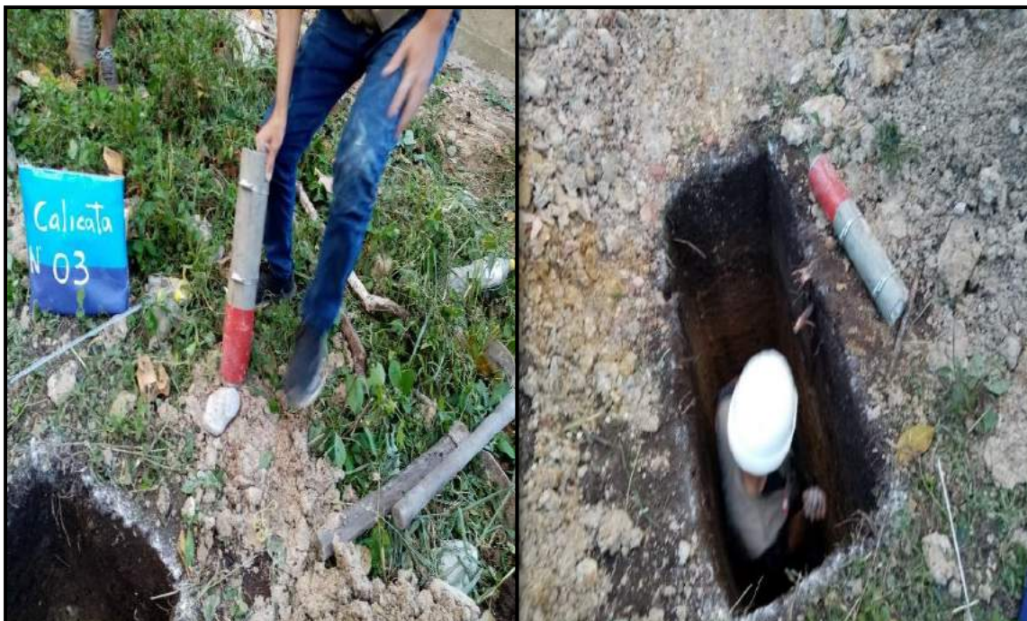
Foto 53: Colocación de molde metálico cilíndrico para extraer la muestra del corte directo (C-03)
