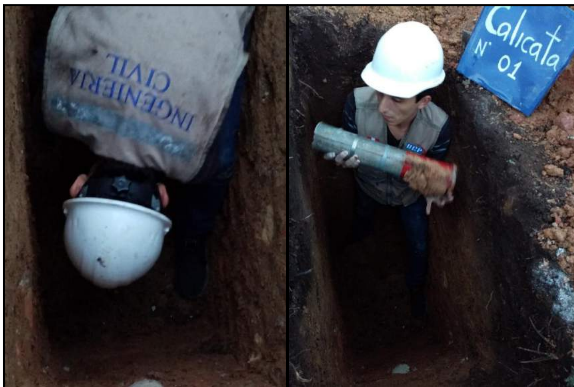
Foto 35: Retiro del molde con la muestra en C-01
