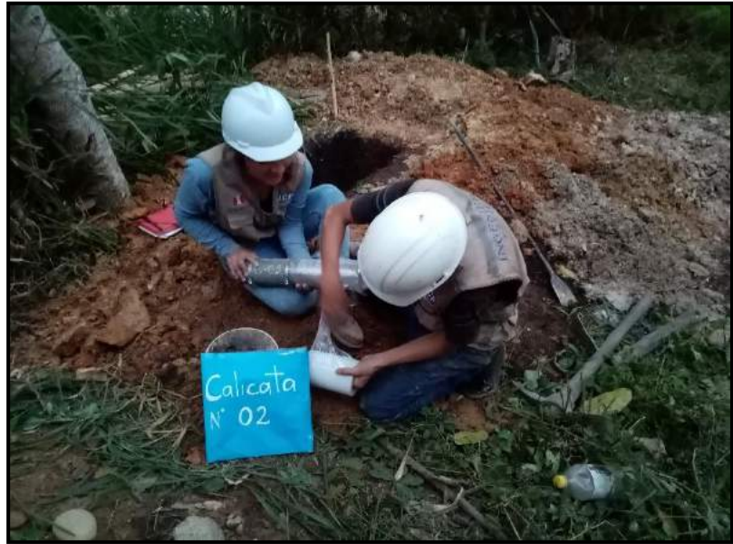
Foto 13: Colocación de film para proteger la muestra.
