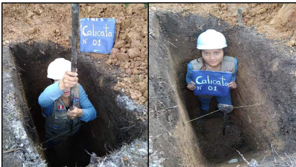
Foto 24: Caída de la barra por efecto de gravedad con la punta hacia abajo desde la altura indicada por el hilo en C-01
