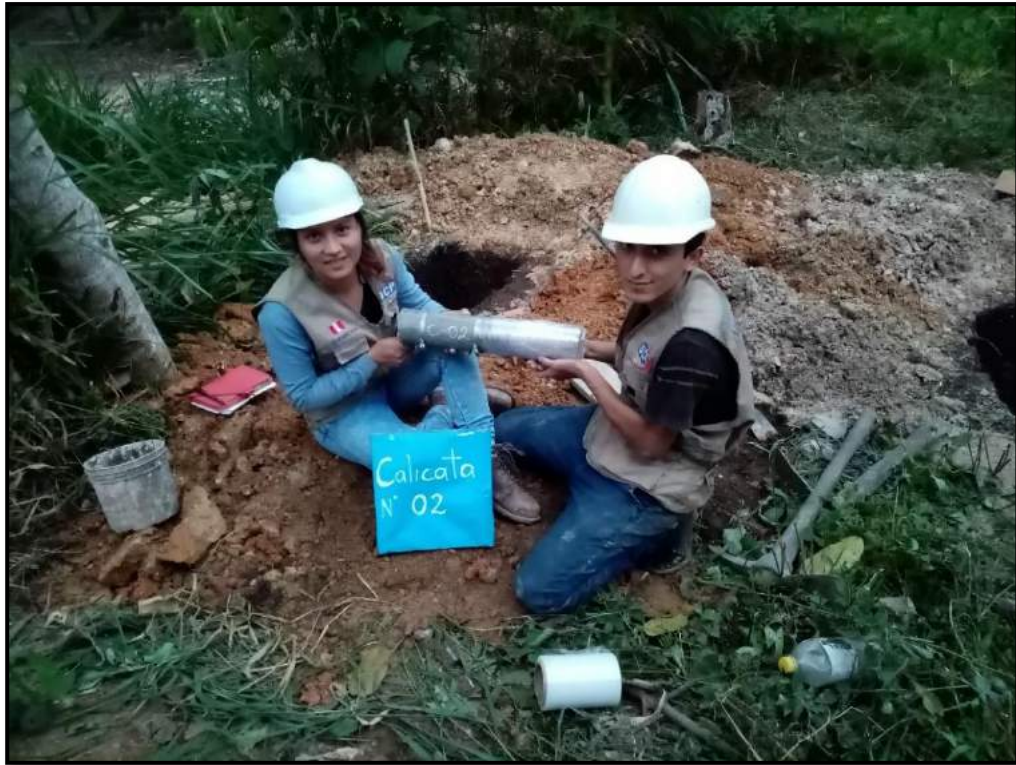
Foto 49: Muestra lista para ser trasladada al laboratorio (C-02)
