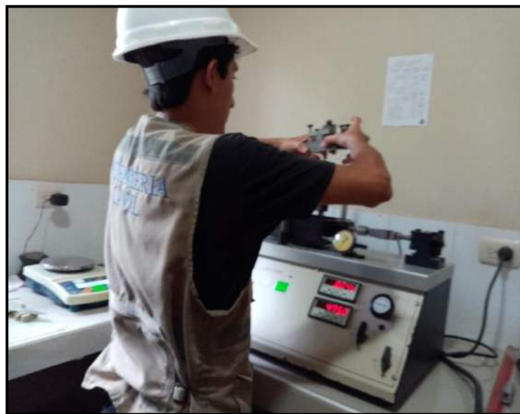
Foto 18: Colocación de la caja de corte en la máquina de corte directo.
