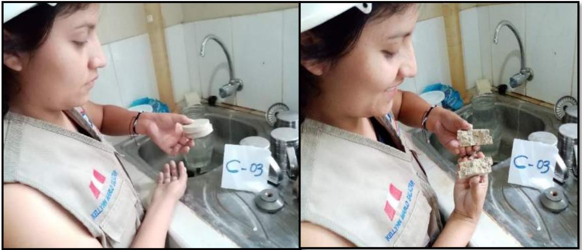
Foto 61: Muestra extraída después del ensayo de corte directo (C-03)
