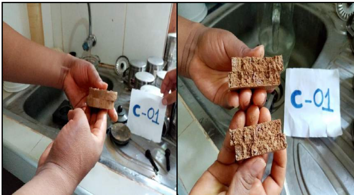
Foto 43: Muestra extraída después del ensayo de corte directo (C-01)
