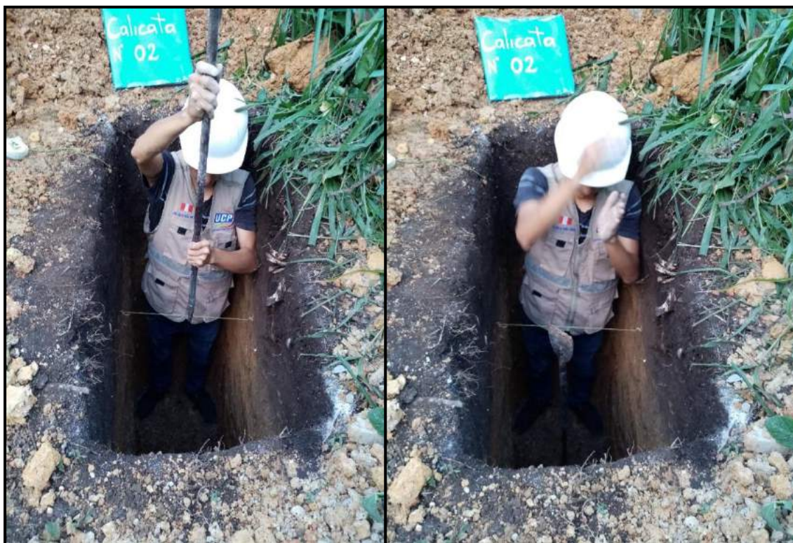
Foto 27: Caída de la barra por efecto de gravedad con la punta hacia abajo desde la altura del hilo en C-02.
