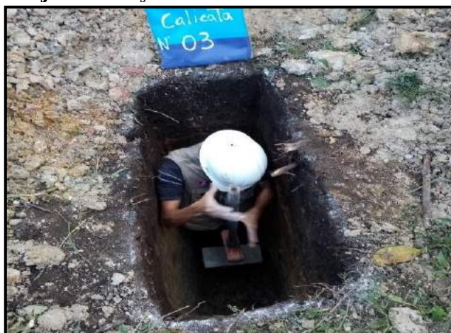
Foto 4: Presión del molde contra el suelo hacia abajo con la ayuda de la comba
