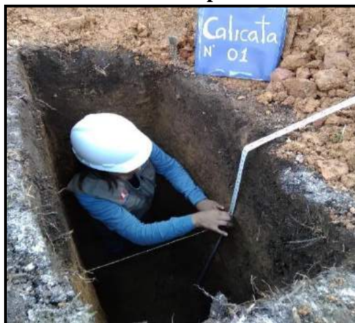
Foto 20: Toma de medición de altura del fondo de calicata a la punta de la barra
