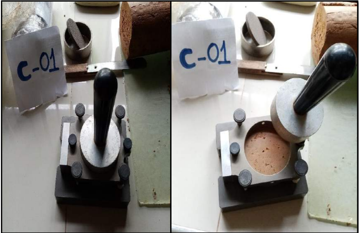
Foto 41: Muestra ya pesada colocada en la caja de corte (C-01)
