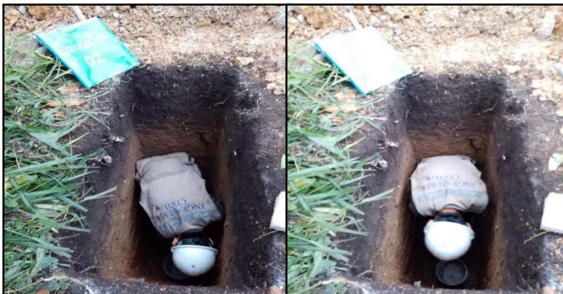
Foto 46: Se coloca mezcla de yeso en la parte superior del molde para que la muestra no se vaya a alterar en C-02
