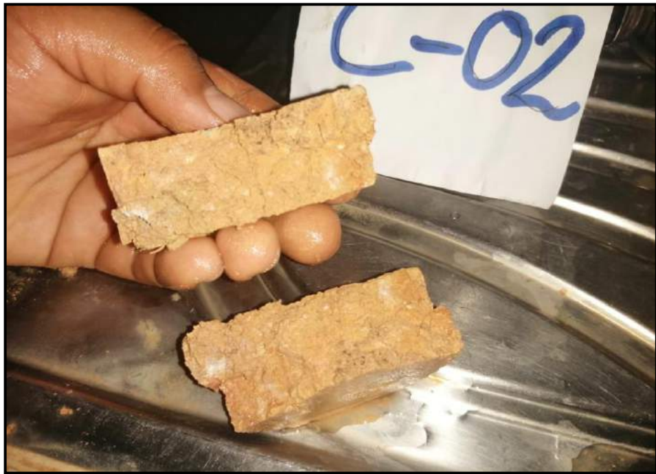
Foto 52: Muestra extraída después del ensayo de corte directo (C-02)
