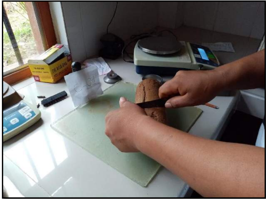
Foto 15: Colocación de la muestra en el anillo de corte.
