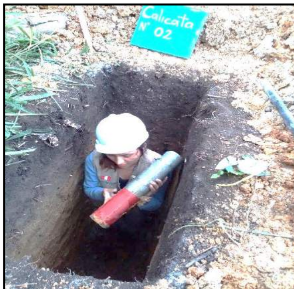
Foto 6: Extracción de muestra
