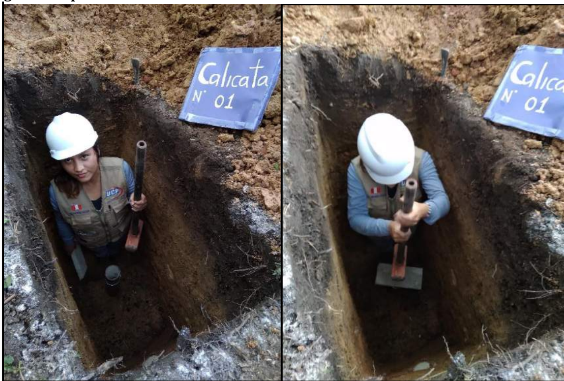
Foto 33: Se ejerce presión en el molde dejando caer la comba por efecto de gravedad para toma de muestra en C-01
