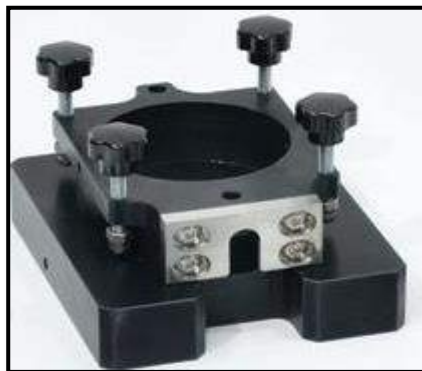
Ilustración 10: Base de la caja de corte
