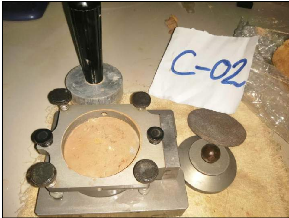
Foto 51: Muestra ya pesada colocada en la caja de corte (C-02)
