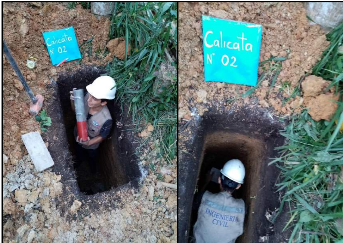
Foto 44: Colocación de molde metálico cilíndrico para extraer la muestra del corte directo (C-02)
