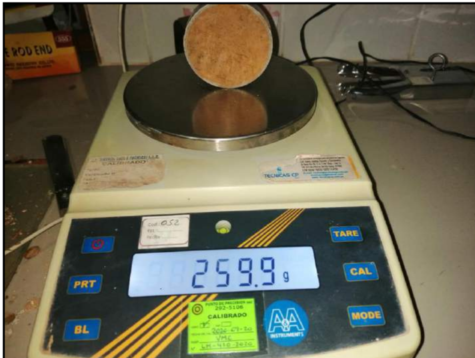
Foto 50: Enrase de las superficies planas de la muestra en el anillo de corte y pesándola (C-02)
