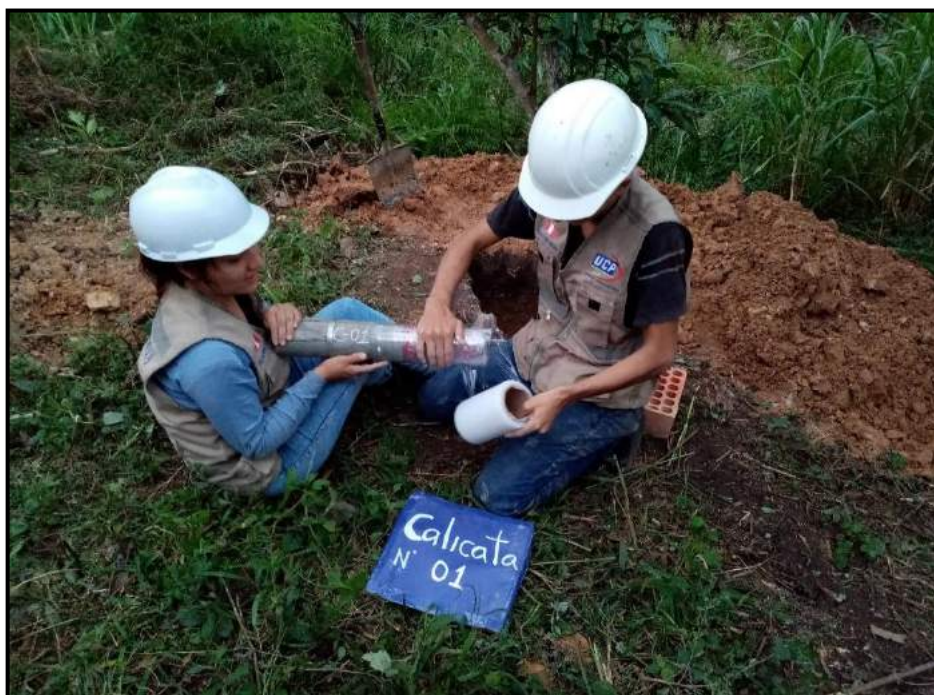
Foto 36: Protección de la parte inferior del molde con film, para que la muestra no se altere (C-01)
