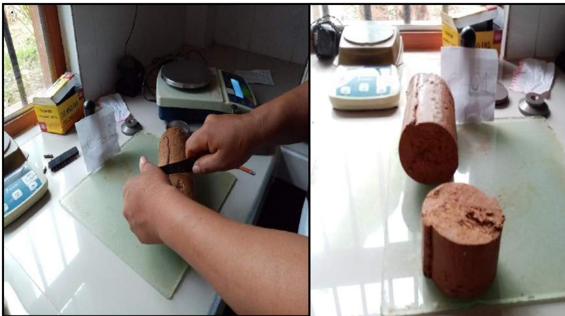
Foto 39: División de la muestra obtenida en 3 bloques para ser colocada en el anillo de corte
