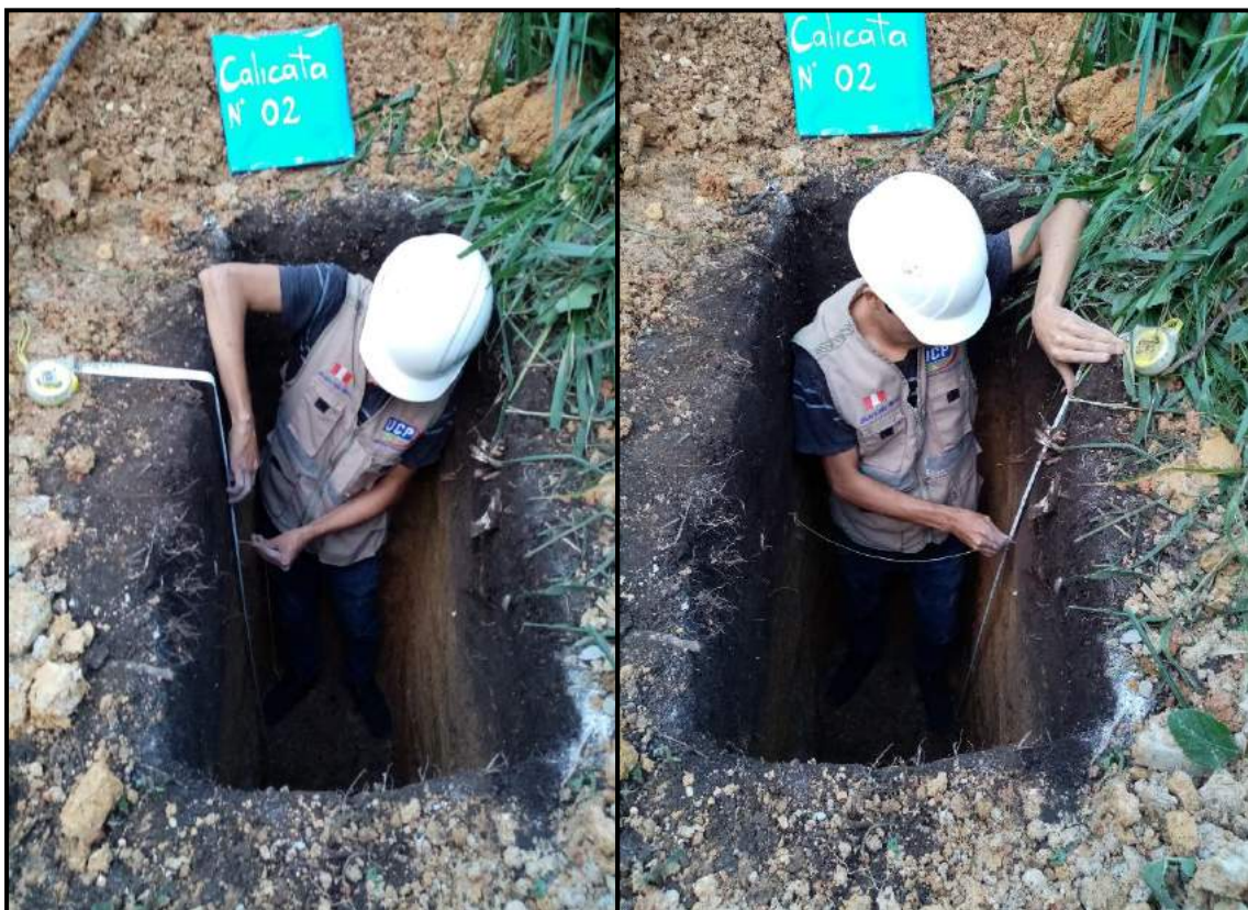
Foto 26: Medición de 1 m desde el fondo de calicata y colocación del hilo con clavos para C-02
