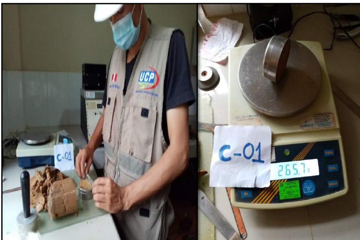
Foto 40: Enrase de las superficies planas de la muestra en el anillo de corte y pesándola (C-01)
