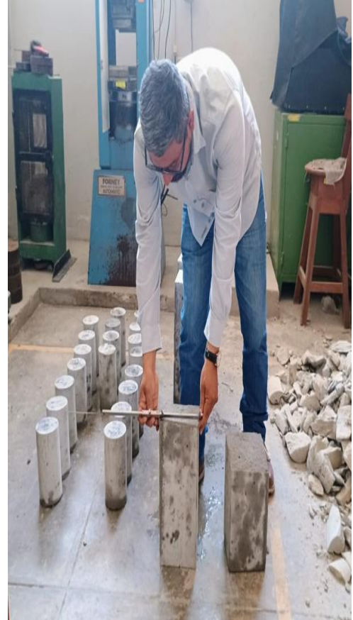
Ensayo de flexión de las vigas de concreto cemento arena
