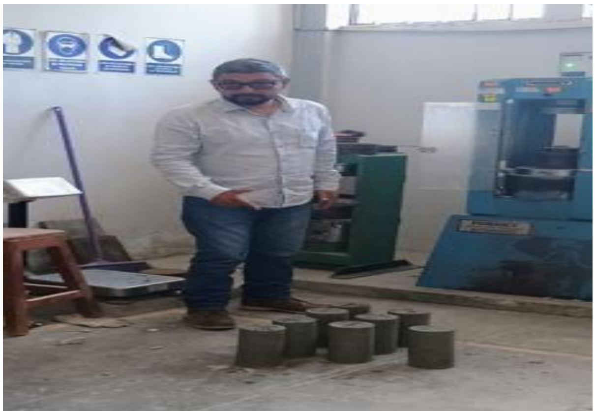
Ensayo a la compresión testigos cilíndricos
