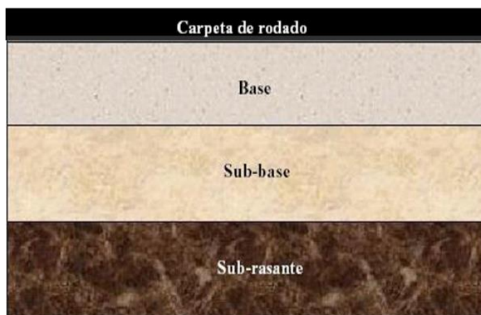
Figura .N°02 estructura típica de un pavimento flexible
