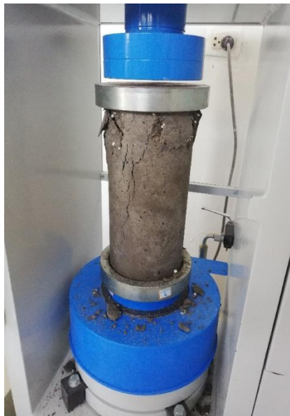
GRÁFICO N°08: Rotura de concreto liviano no estructural
