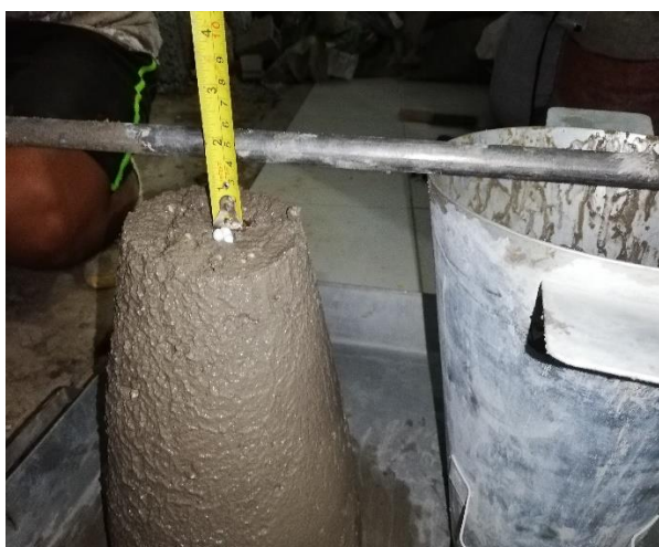
GRÁFICO N°07: Asentamiento del concreto liviano no estructural-CL01
