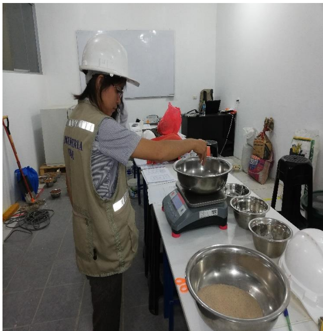
FOTO N° 01: CONTENIDO DE HUMEDAD AGREGADO FINO.
