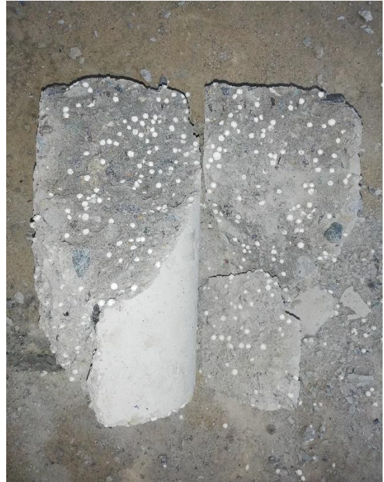
FOTO N° 22: MUESTRA DE CONCRETO CON SUSTITUCIÓN DEL 30% DE AGREGADO GRUESO POR PERLAS DE POLIESTIRENO EXPANDIDO.
