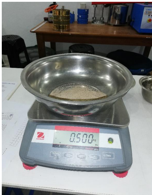
FOTO N° 02: CONTENIDO DE HUMEDAD AGREGADO FINO.
