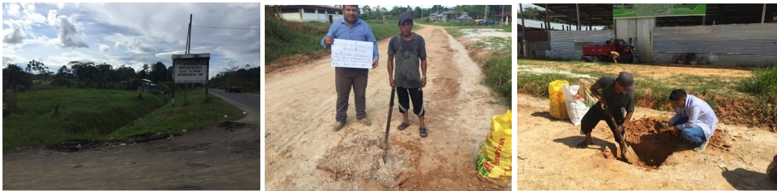
Figuras 25: Proceso de Extracción de Muestra - Calicata Exploratoria N°01
