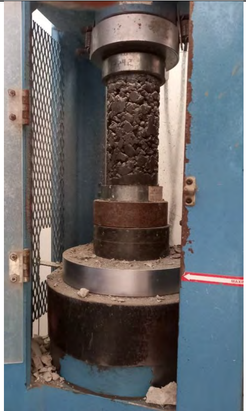
Foto 42: ENSAYO DE RESISTENCIA A COMPRESIÓN
