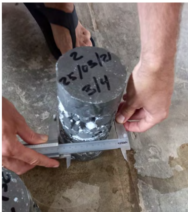
Foto 47: MEDICIÓN DE PROBETA 4" x 8". DISEÑO N°02
