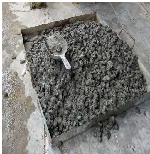
Foto 20: MEZCLA DE CONCRETO PERMEABLE
