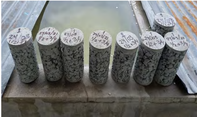
Foto 31: PROBETAS DE 4" x 8" AL DÍA SIGUIENTE DEL VACIADO DISEÑO 1
