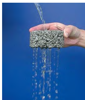
Figura 1: Textura de una muestra de concreto permeable.
