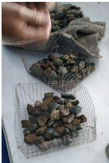
Foto 9: ENSAYO DE GRAVEDAD ESPECÍFICA DEL AGREGADO.
