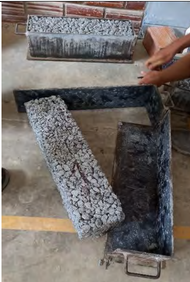
Foto 33: DESMOLDE PARA RESISTENCIA A LA FLEXIÓN
