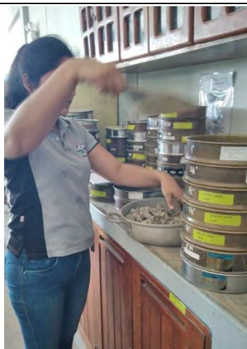
Foto 4: TAMIZADO DEL AGREGADO GRUESO, ENSAYO DE GRANULOMETRÍA
