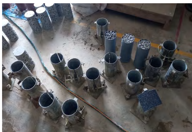
Foto 30: DESMOLDE DE PROBETAS DE 4" x 8"
