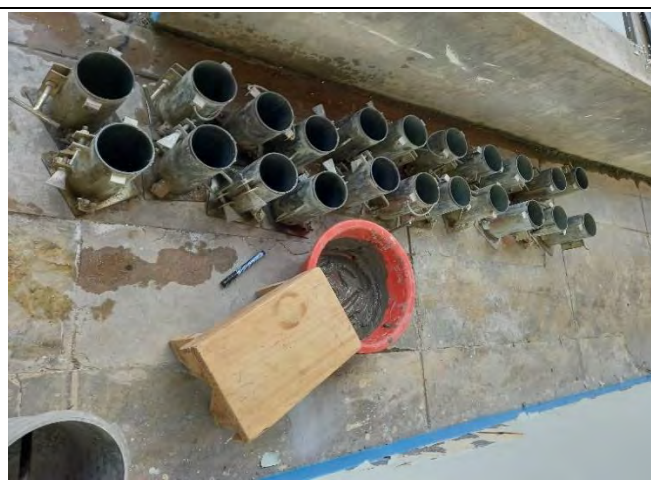
Foto 24: LLENADO DE CAPPING EN LA PARTE INTERIOR DE LAS PROBETAS 4" x 8"
