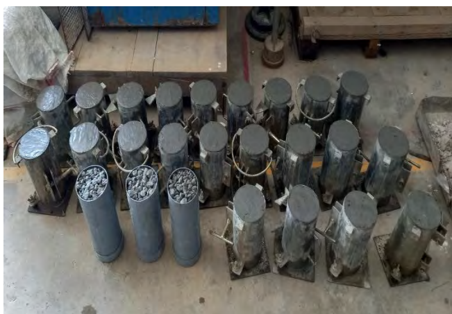
FOTO 27: RELLENO DE CAPPING EN LA PARTE SUPERIOR DE LAS PROBETAS 4" x 8".
