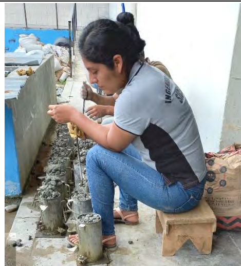
Foto 26: COMPACTADO DE PROBETAS DE 4" x 8"
