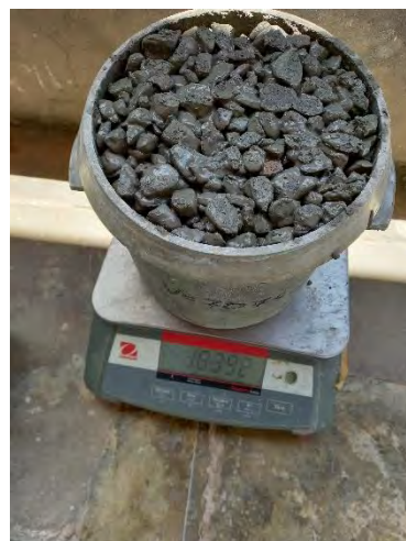
Foto 22: PESO UNITARIO DEL CONCRETO
