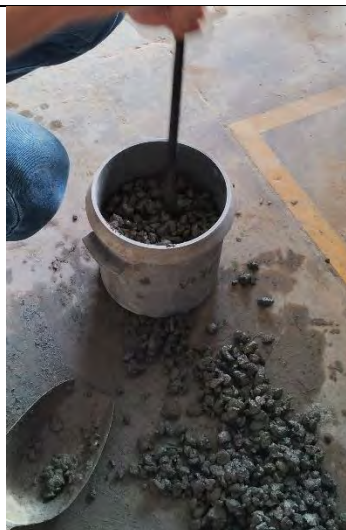
Foto 21: COMPACTADO PARA PESO UNITARIO
