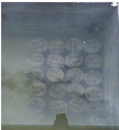
Foto 35: SUMERGIDO DE PROBETAS
