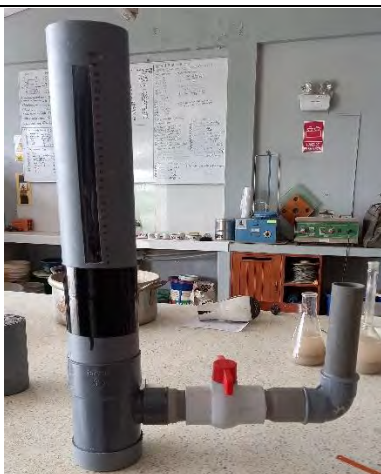
Foto 57: PARA MEDIR LA INFILTRACIÓN DEL CONCRETO PERMEABLE
