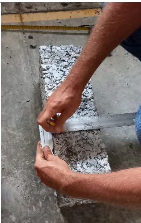
Foto 51: MEDICIÓN DE MOLDE PARA RESISTENCIA A LA FLEXIÓN
