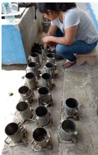
Foto 25: VACIADO DE PROBETAS DE 4" x 8"
