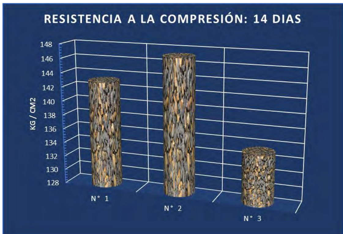
Gráfica 10: Resistencia a la Compresión Diseño N°02: 14 Días
