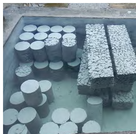
Foto 40: POZA DE CURADO DE PROBETAS Y MOLDES
