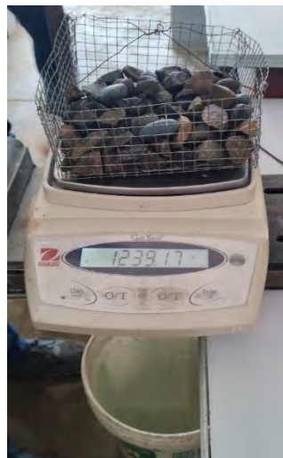
Foto 10: PESO DE LA MUESTRA DEL AGREGADO \frac{3}{4} " EGE
