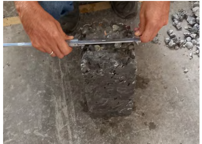
Foto 54: MEDICIÓN DE MOLDE SOMETIDO A ENSAYO
