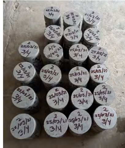
Foto 32: PROBETAS DE 4" x 8" AL DÍA SIGUIENTE DEL VACIADO DISEÑO 2
