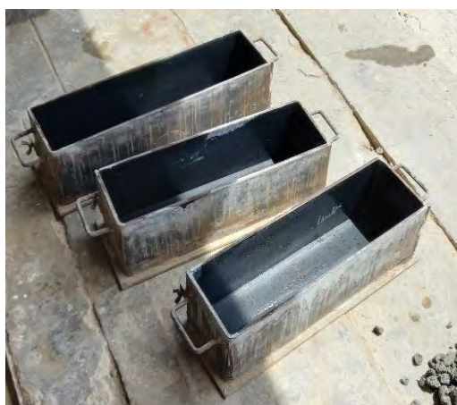
Foto 28: MOLDES PARA RESISTENCIA A LA FLEXIÓN
