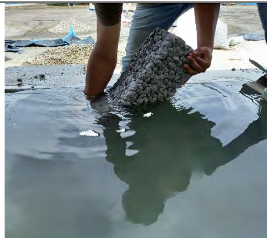
Foto 36: SUMERGIDO DE MOLDES
