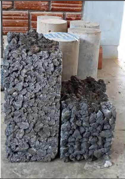
Foto 53: MOLDE SOMETIDO A ENSAYO DE FLEXIÓN.
