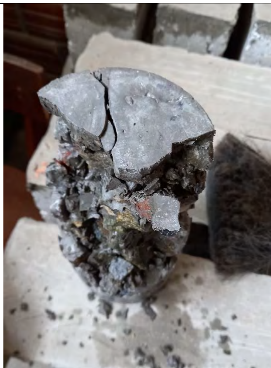
Foto 50: PROBETA SOMETIDO A ENSAYO DE COMPRESIÓN. DISEÑO N°02.
