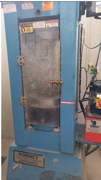
Foto 43: ENSAYO DE RESISTENCIA A COMPRESIÓN: DISEÑO N°01 A LOS 7 DIAS
