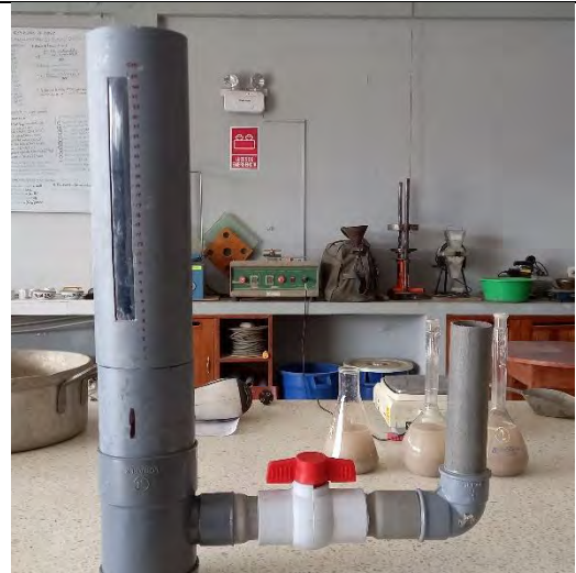
Foto 56: PERMEÁMETRO DE CARGA VARIABLE DE NEITHALATH
