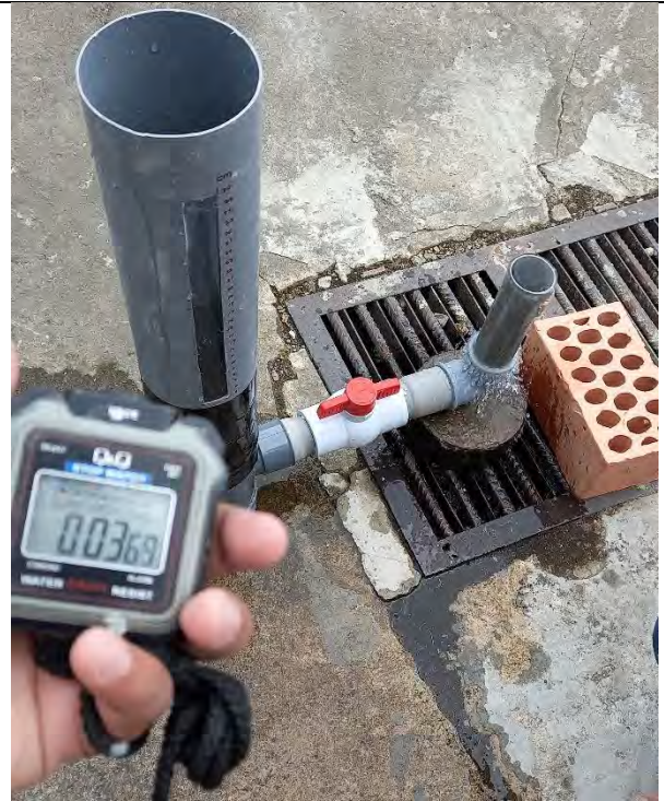
Foto 60: ENSAYO DE PERMEABILIDAD DE NEITHALATH
