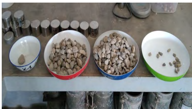
Foto 5: PESAJE PARA EL ANÁLISIS GRANULOMÉTRICO
