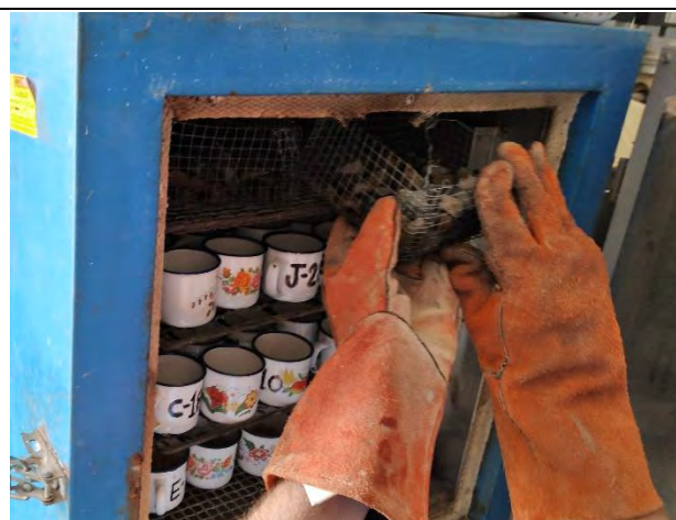
Foto 12: SECADO DE LA MUESTRA DEL AGREGADO \frac{3}{4} " EGE
