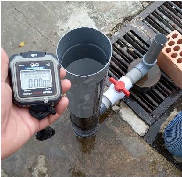
Foto 59: ENSAYO DE PERMEABILIDAD
