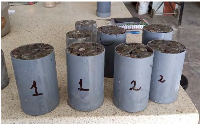
Foto 55: MUESTRAS PARA ENSAYO DE PERMEABILIDAD
