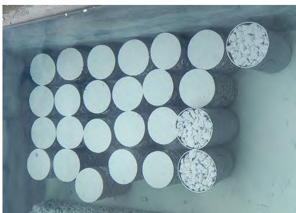
Foto 39: POZA DE CURADO DE PROBETAS Y MOLDES
