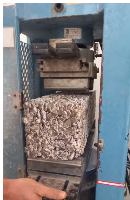
Foto 52: ENSAYO DE RESISTENCIA A LA FLEXIÓN
