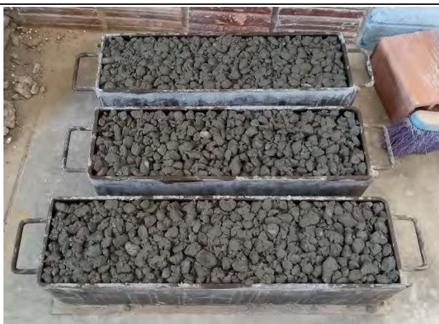
Foto 29: MOLDES PARA RESISTENCIA A LA FLEXIÓN
