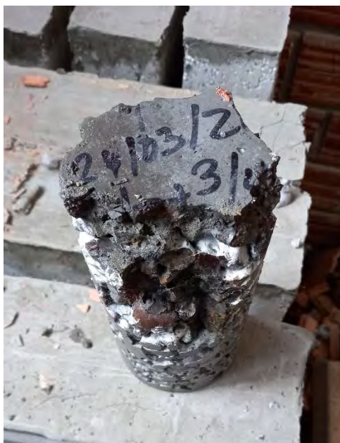
Foto 45: PROBETA SOMETIDO A ENSAYO DE COMPRESIÓN. DISEÑO N°01
