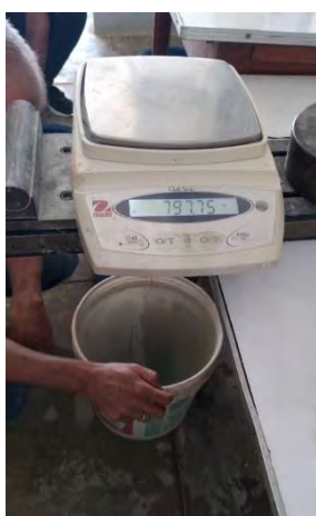
Foto 11: PESO EN AGUA DE LA MUESTRA DEL AGREGADO \frac{3}{4} " EGE
