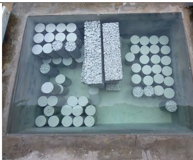
Foto 38: POZA DE CURADO DE PROBETAS Y MOLDES:
