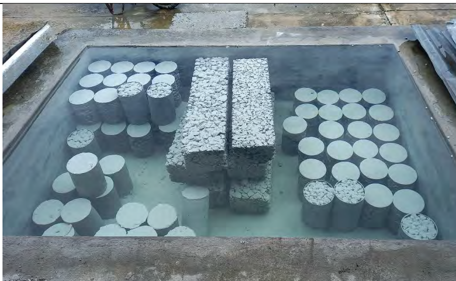
Foto 37: POZA DE CURADO DE PROBETAS Y MOLDES
