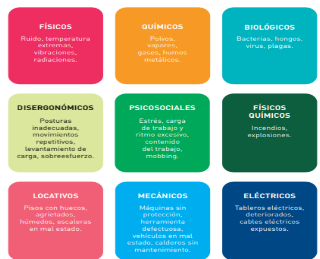
FIGURA 1 : CATEGORIZACIÓN DE PELIGROS
