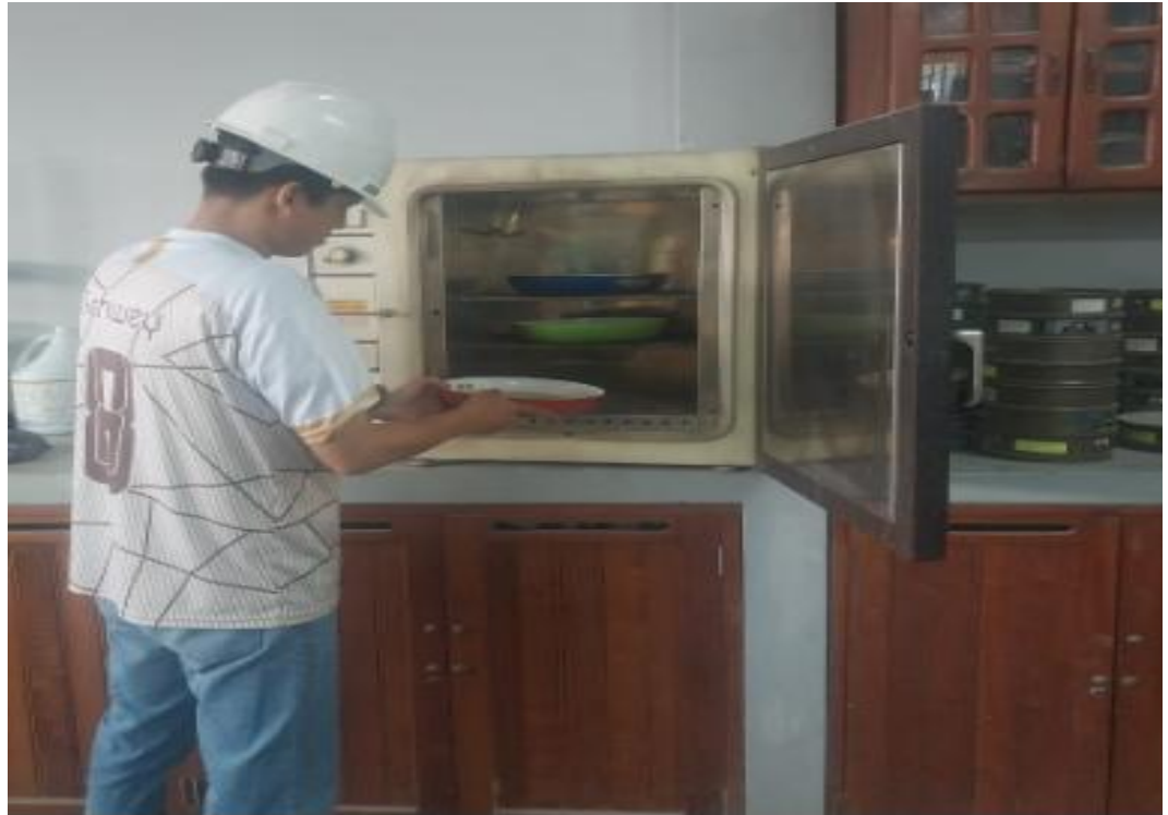
Secado de material agregado fino
