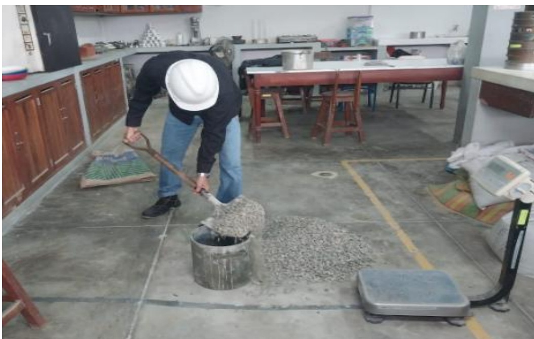
Control de material agregado grueso
