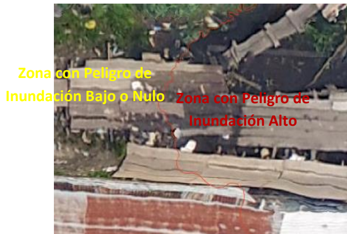
Imagen 10.- Discretización del nivel de peligro por inundación en base a las curvas de nivel, sector inundado – sector seco.
