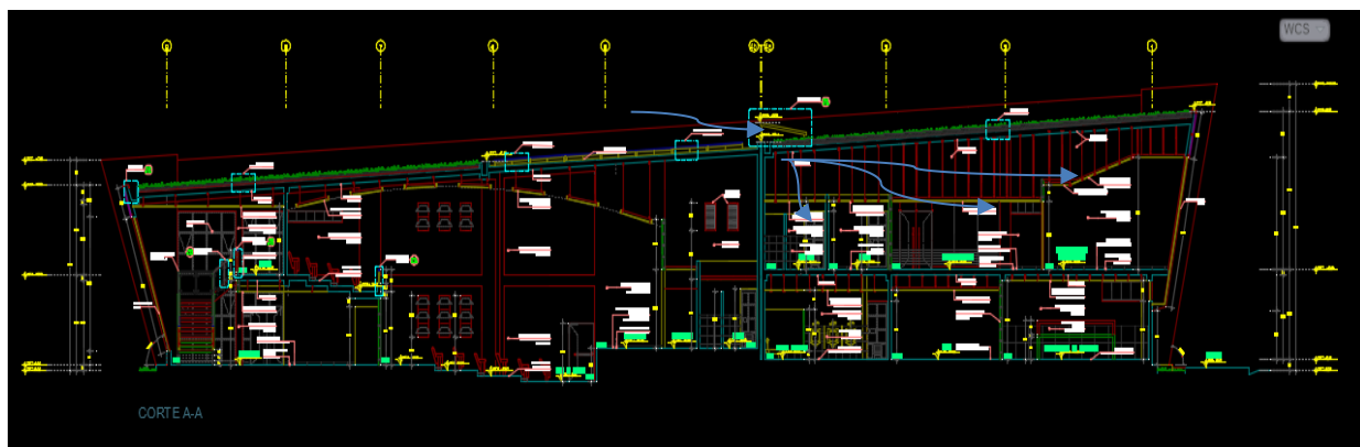
Figura 94. Tipo de ventilación – Chimenea Invertida
