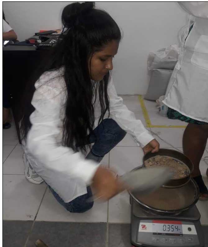
Figura 44: La muestra secada se tamizo por la malla N°40 y se pesó 500 gramos para después realizar los ensayos de granulometría.
