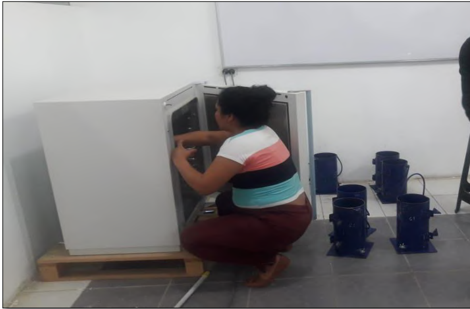
Figura 41: Se dejó secar la muestra a temperatura de 110 \pm 5^{\circ}\text{C} .
