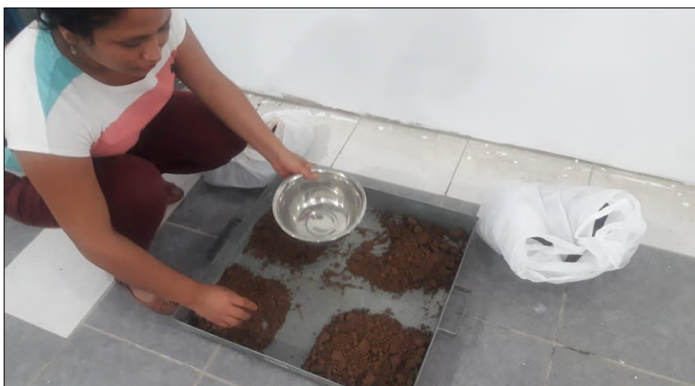
Figura 40: Se extrajo una cuarta parte del suelo cuarteado para realizar los respectivos ensayos.
