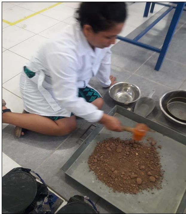
Figura 43: Muestra molida por un martillo de goma, antes de realizar el ensayo de Limites de Consistencia.
