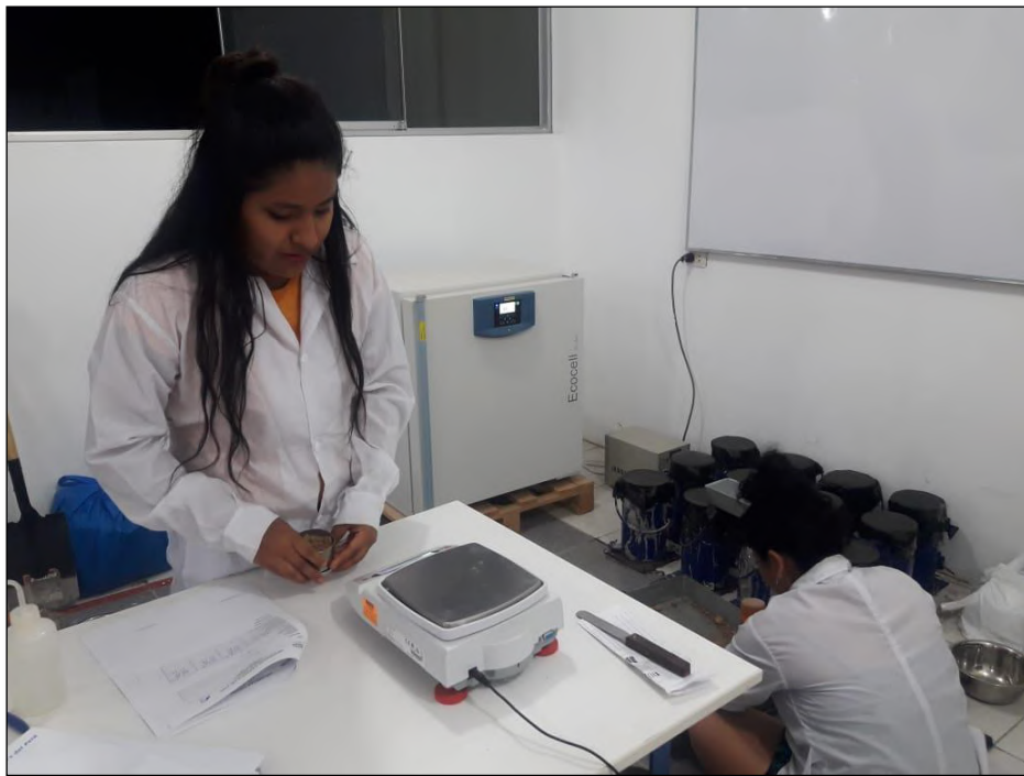
Figura 45: Realizando los ensayos de Limite Liquido y Limite Plástico.
