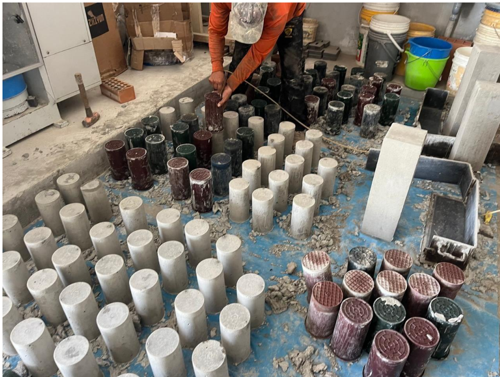
FOTO N° 10: Preparación de los especímenes de concreto para su codificación.
