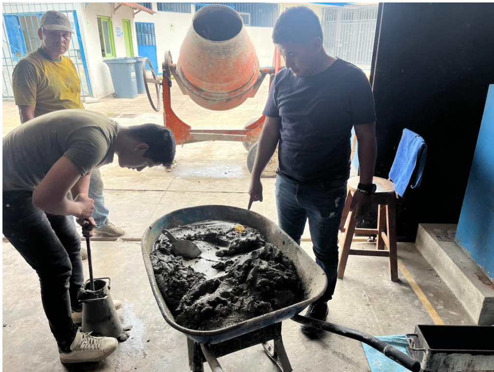
FOTO N° 08: Verificación y control de temperatura del concreto fresco.
