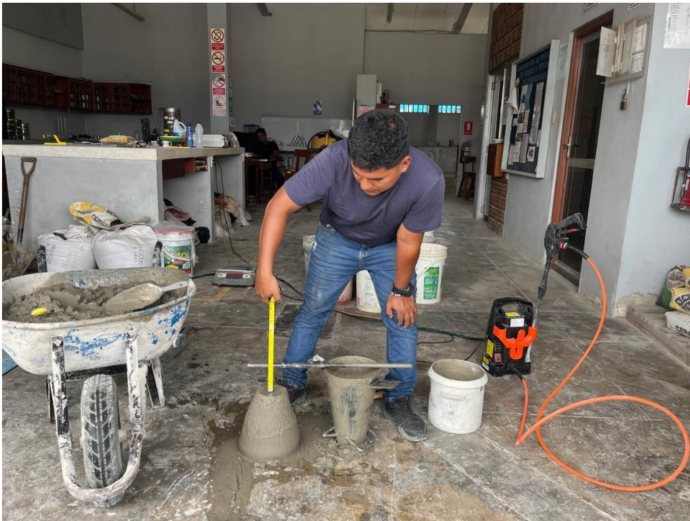
FOTO N° 06: Ensayo de asentamiento del concreto fresco (slump).
