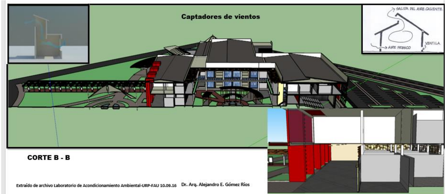
IMAGEN N° 16: SISTEMAS DE CAPTACION DE VIENTOS
