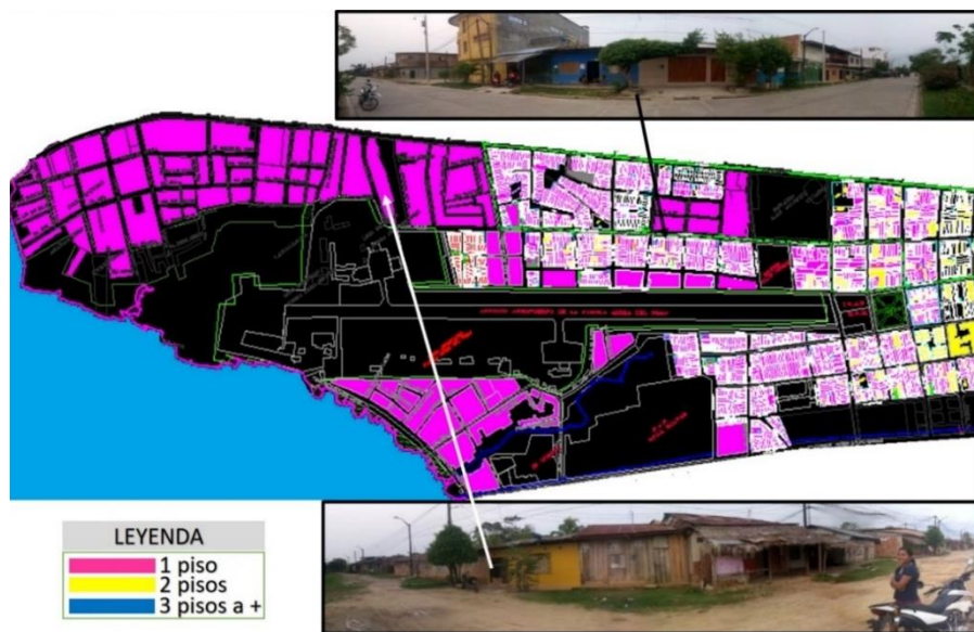
IMAGEN Nº 04: ALTURA DE PISOS DE LAS VIVIENDAS
