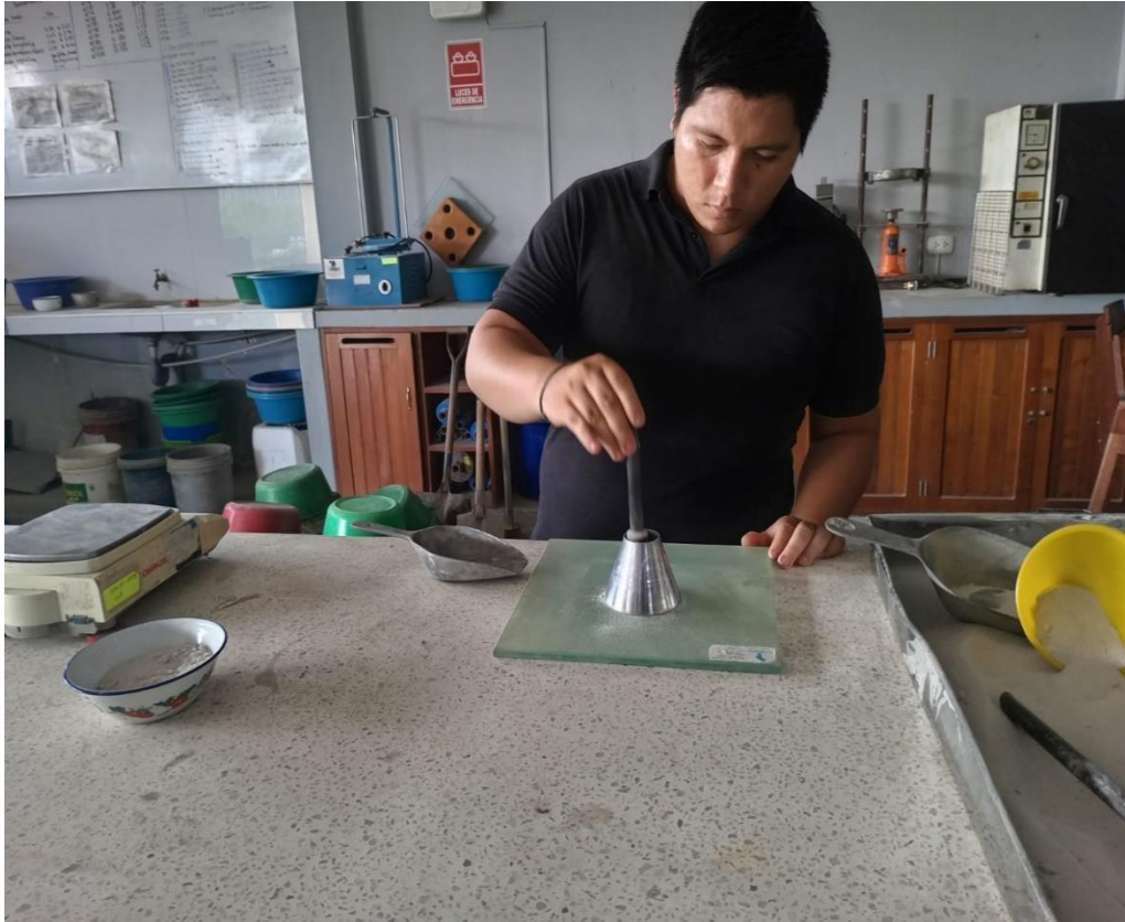
Imagen 5 Ensayo de peso específico y absorción.
