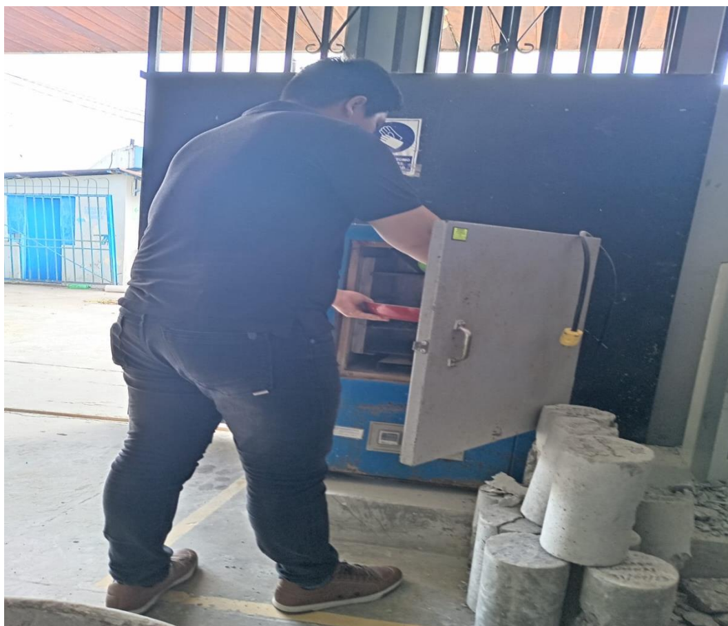
Imagen 4 Ensayo de los agregados ( secado del agregado)
