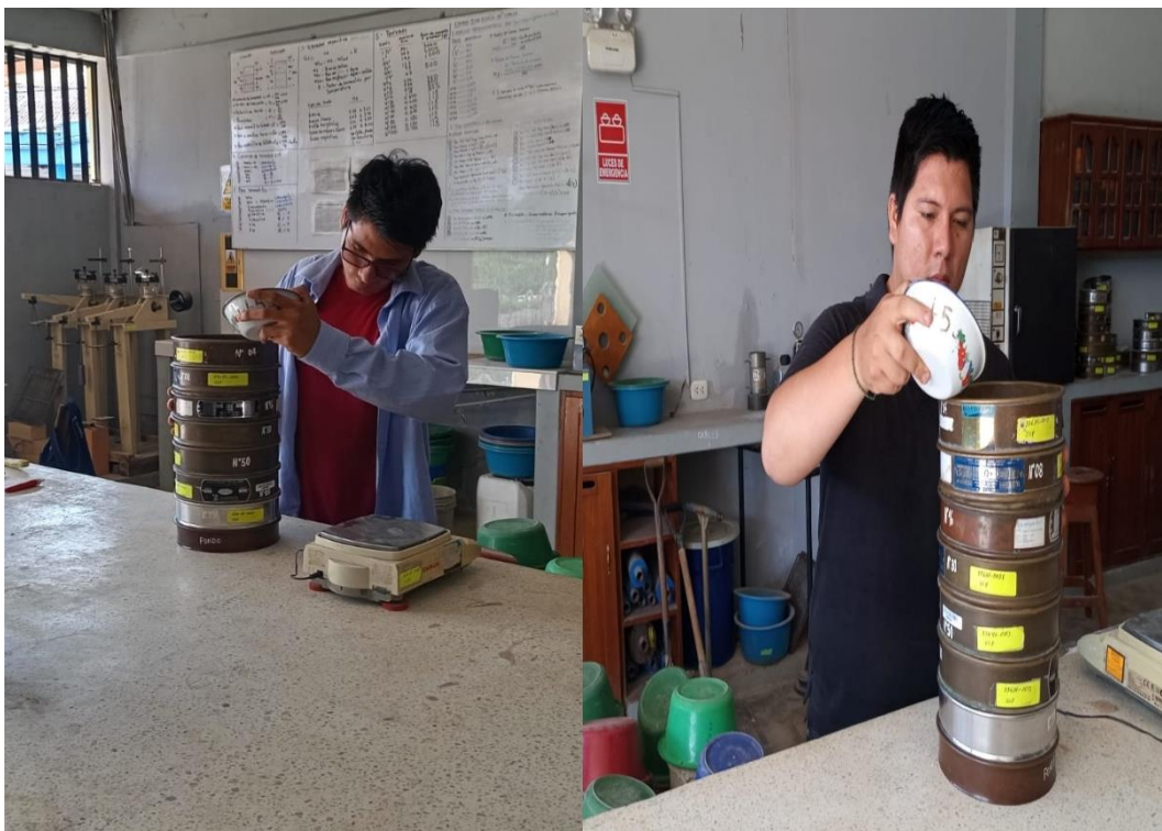
Imagen 1 Colocacion del agregado Fino en los tamices.
