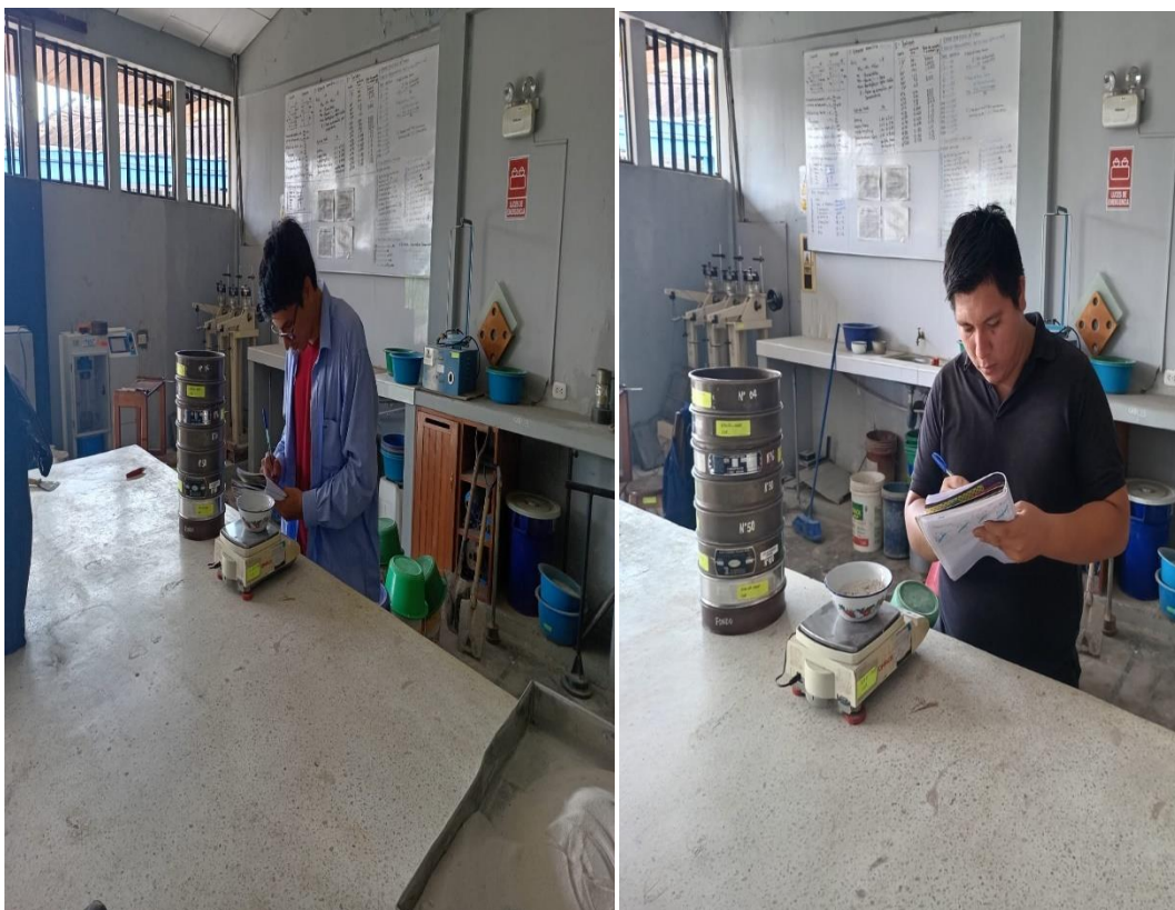
Imagen 2 Ensayos de los agregados ( pesado del agregado seco).
