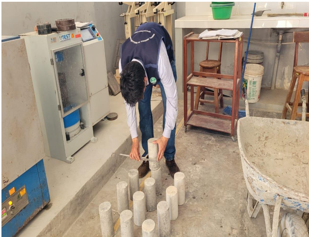
Imagen 6 Toma de datos de las probetas antes de la prueba de resistencia a la compresión.
