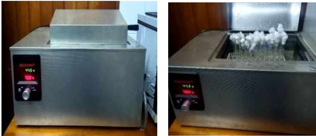
Fig. 19 Coliformes Termotolerantes: Incubación a 44.5 °C
