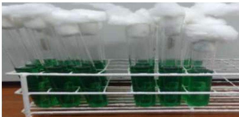
Fig. 18 Caldo E. coli para coliformes termotolerantes
