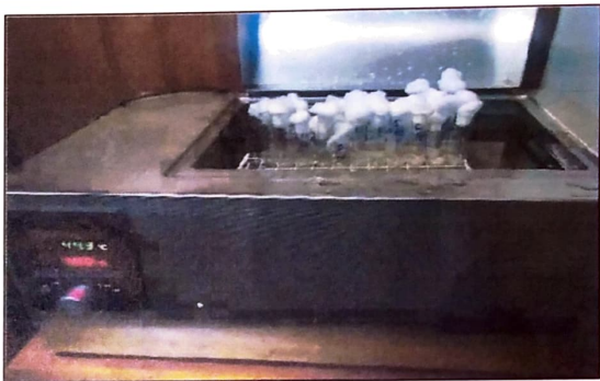
Fig 5. Coliformes Termotolerantes: Incubación a 44.5 °C
