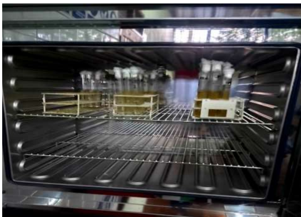
Fig. 16 Incubación a 37°C: Identificación presuntiva: Siembra en Caldo Lauril Sulfato
