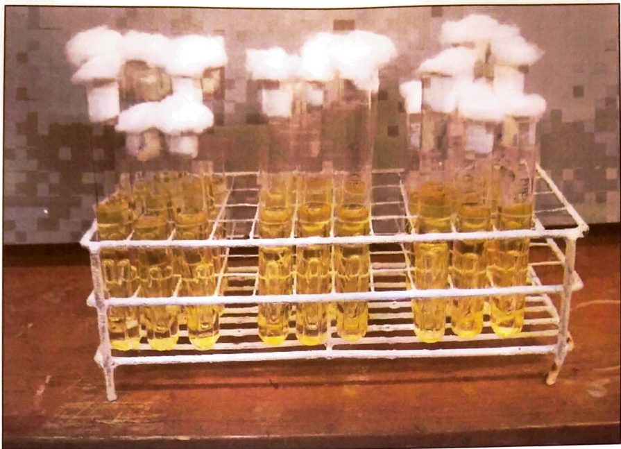
Fig 5. Coliformes Termotolerantes: Incubación a 44.5 °C
