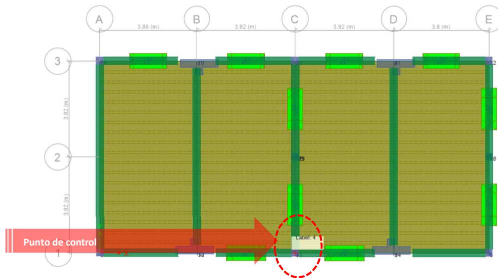
Figura 37. Monitoreo de desplazamiento del Bloque 101A
