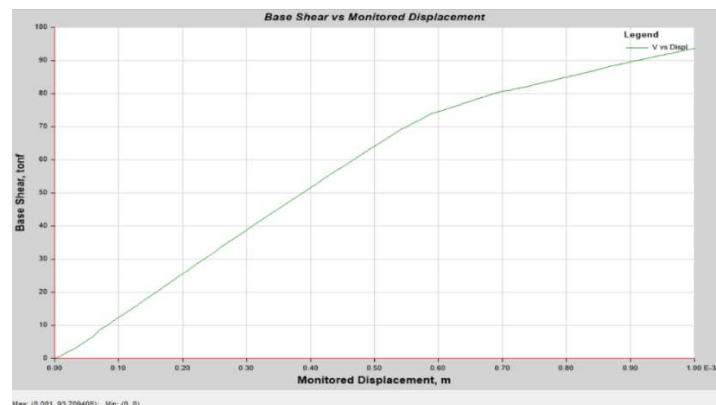
Figura 75. Curva de Capacidad en Y-Y –Bloque 101A
