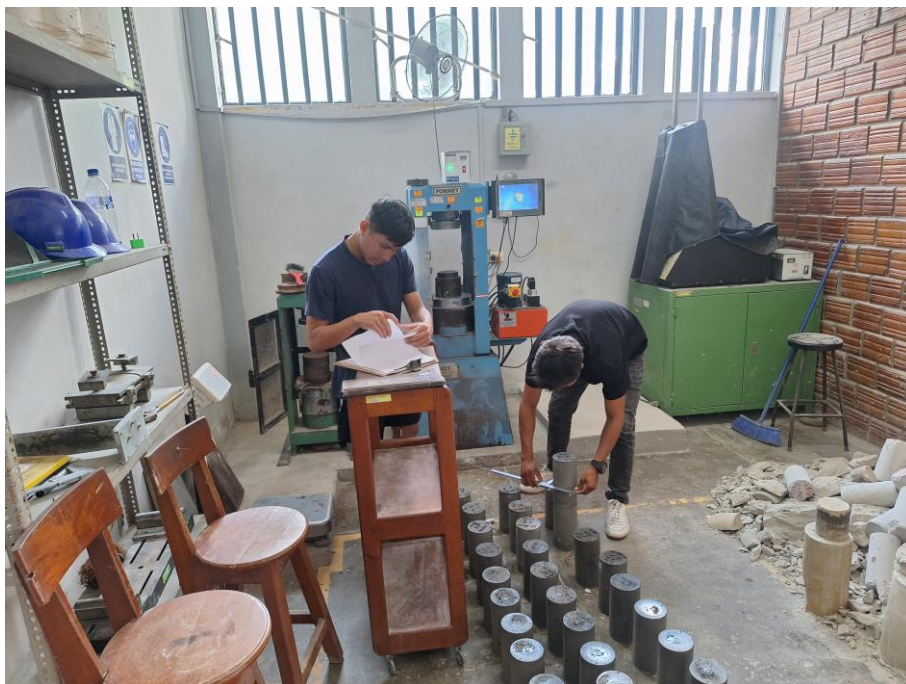
FOTO N° 12: Registro de los diámetros de los especímenes.
