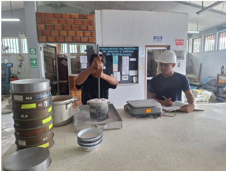
FOTO N° 05: Apisonado del agregado fino para el peso unitario compactado.
