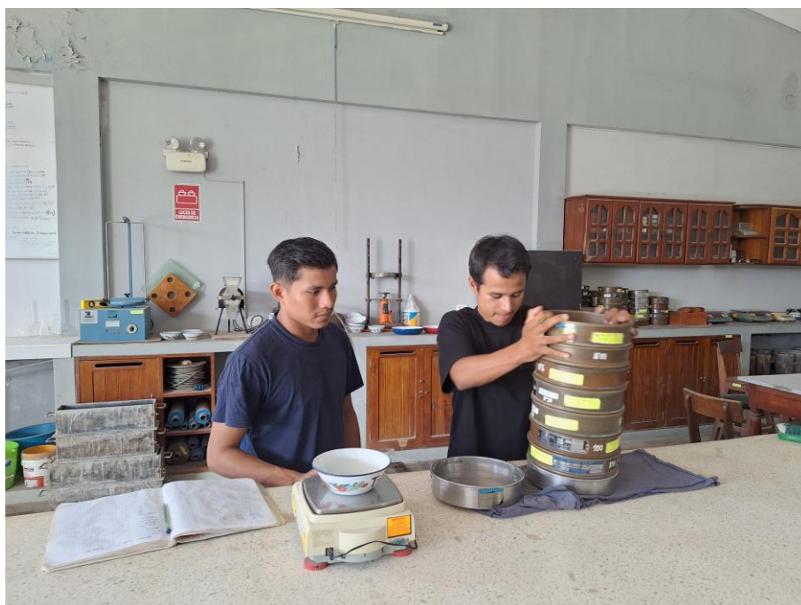
FOTO N° 08: Tamizado de forma manual de la muestra de agregado fino.
