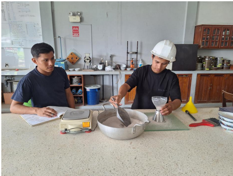
FOTO N° 01: Determinación del estado S.S.S. (Saturado superficialmente seco).
