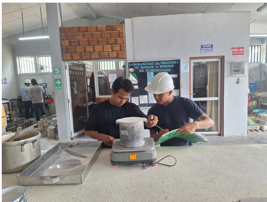
FOTO N° 07: Determinación y registro del peso para el ensayo de peso unitario.
