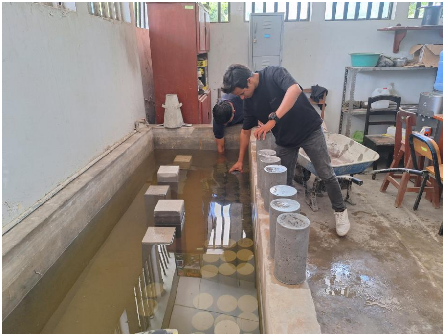
FOTO N° 11: Inmersión y curado de especímenes de concreto de 4x8 pulg.
