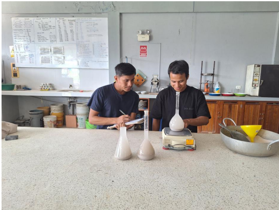
FOTO N° 03: Ensayo del agregado fino para la gravedad específica.
