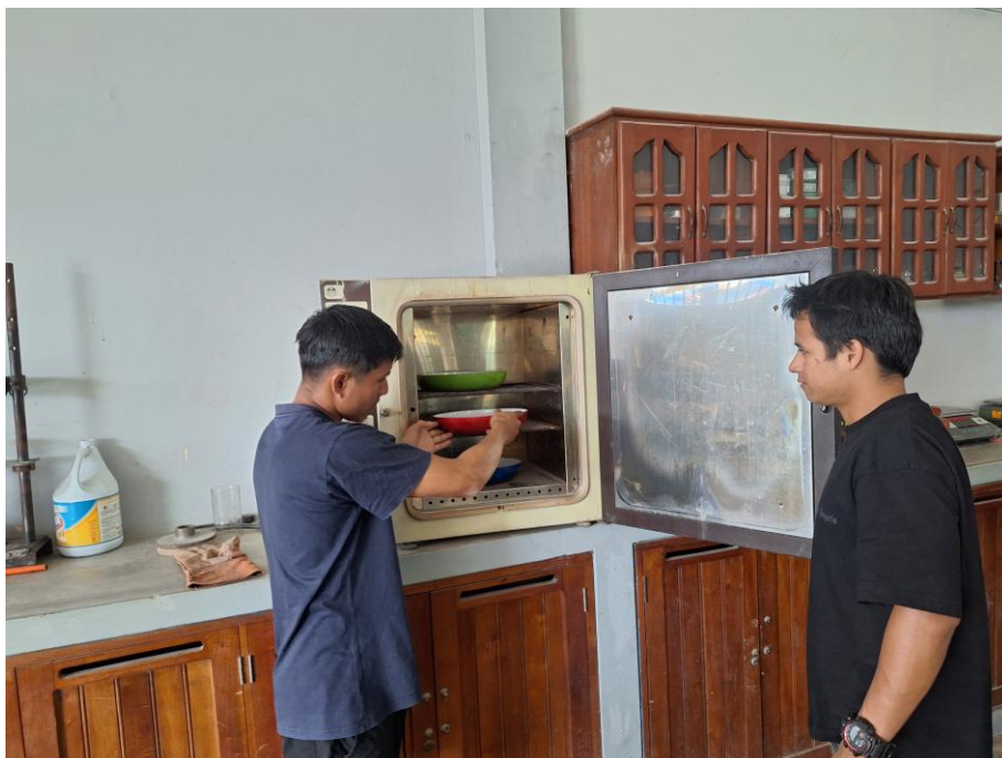
FOTO N° 04: Secado en horno del agregado a temperatura constante (Absorción).
