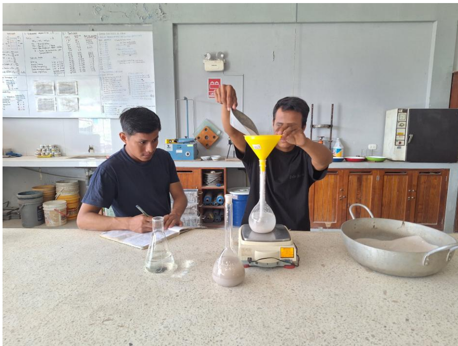
FOTO N° 02: Registro del peso de material en su estado S.S.S.
