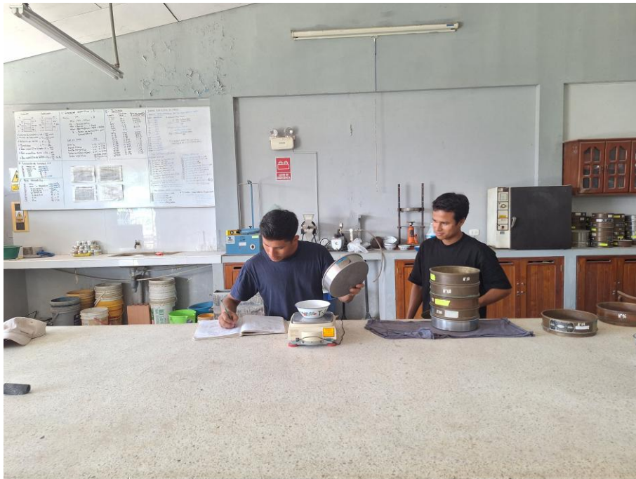
FOTO N° 09: Registro y pesaje de la cantidad de material retenido en los tamices.
