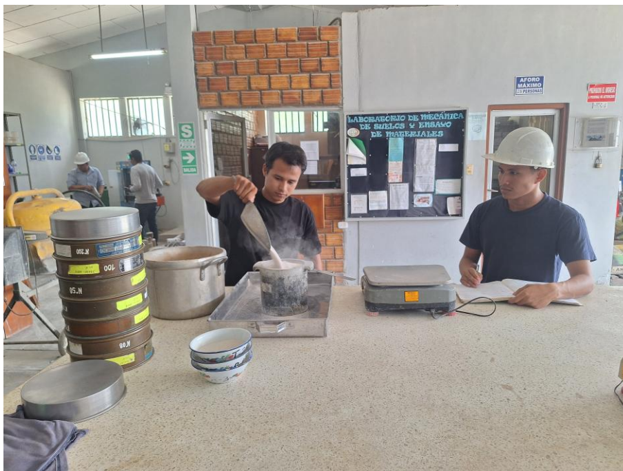
FOTO N° 06: Descarga del agregado fino para el peso unitario suelto.
