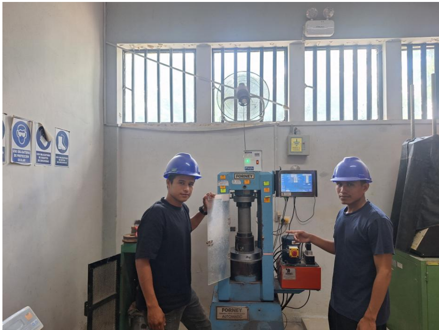
FOTO N° 13: Ensayo de resistencia a la compresión de los especímenes.
