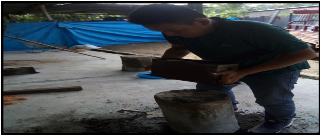
Con las manos debajo del molde, damos tres golpes en la madera para una mejor compactación.
