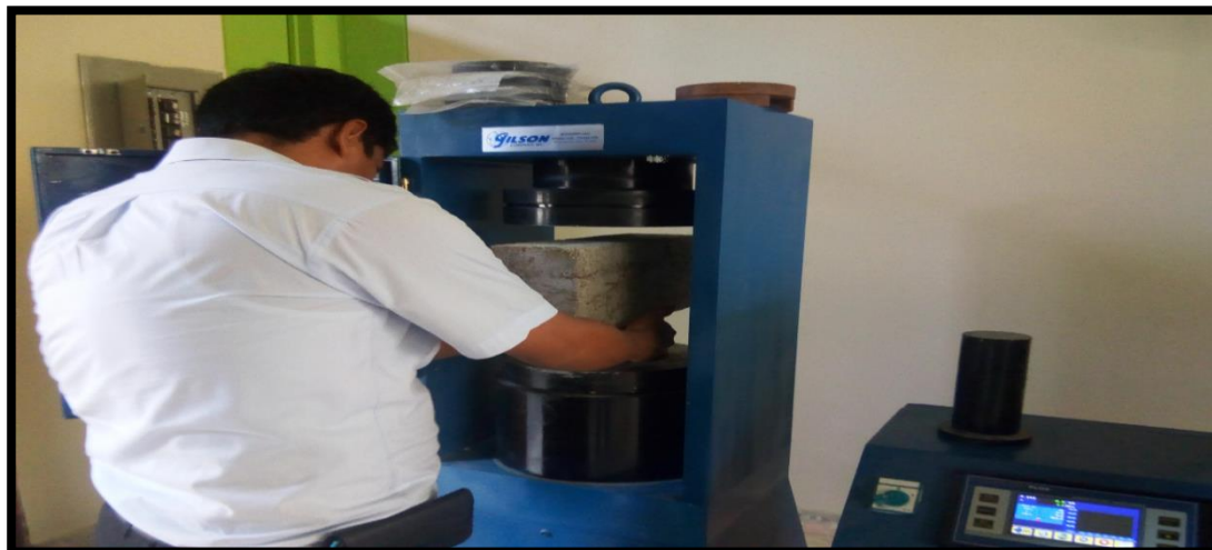
Colocación del ecobloque en la prensa
