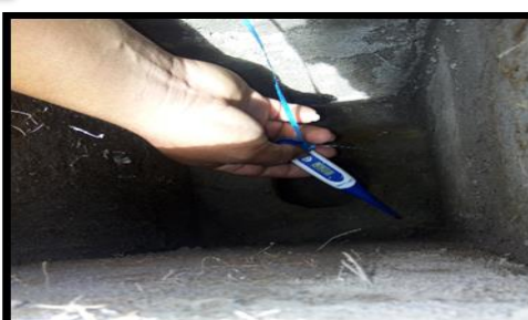
Medida de temperatura al interior del prototipo
