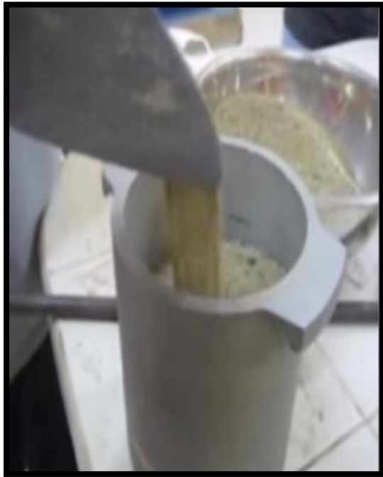
Vaciado del agregado fino al recipiente Desde una altura de 5cm
