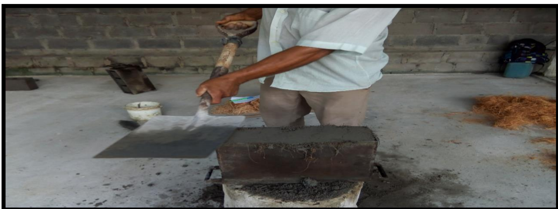
Nivelamos el material al ras del molde
