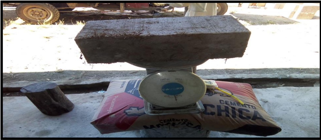
Peso ecobloque 9.5 kg (39x19x12)
