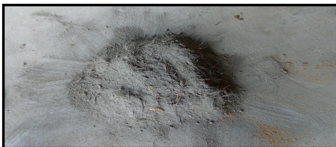
Mezcla de la fibra de coco juntamente con la arena y el cemento
