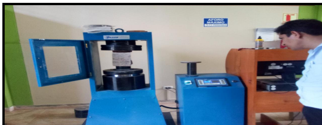
Inicio del ensayo de rotura del ecobloque
