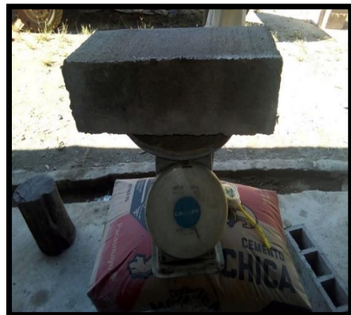
Peso bloque concreto 7.400 kg
