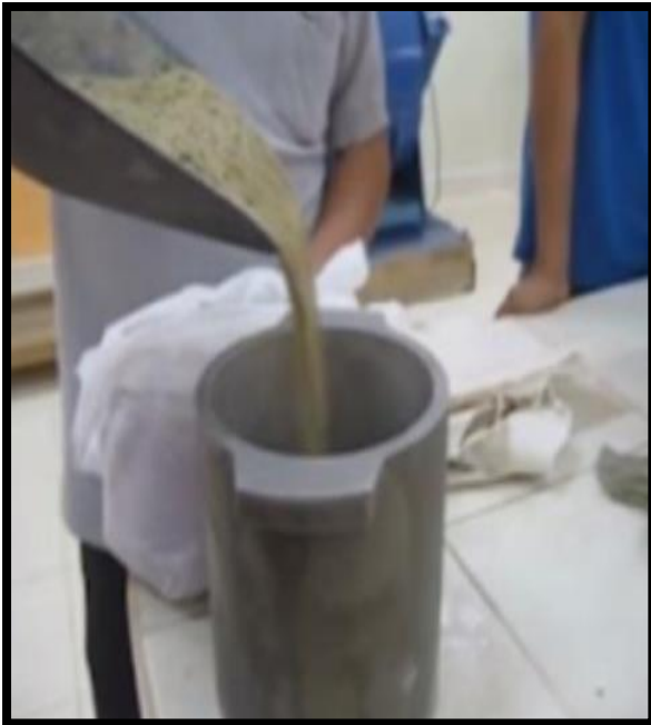
Vaciado del agregado fino al recipiente desde una altura de 5 cm
