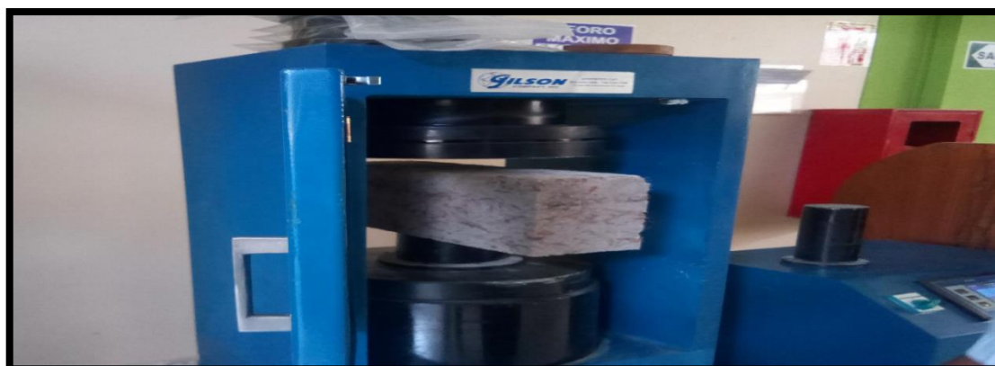
Muestra del ecobloque en la prensa
