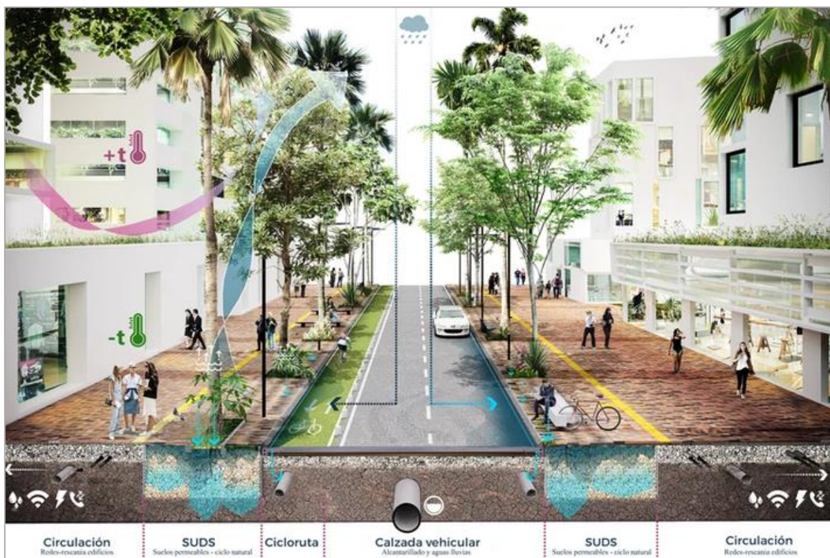
Figura N° 23: Pavimentos permeables que asientan el agua de lluvia a la tierra.
