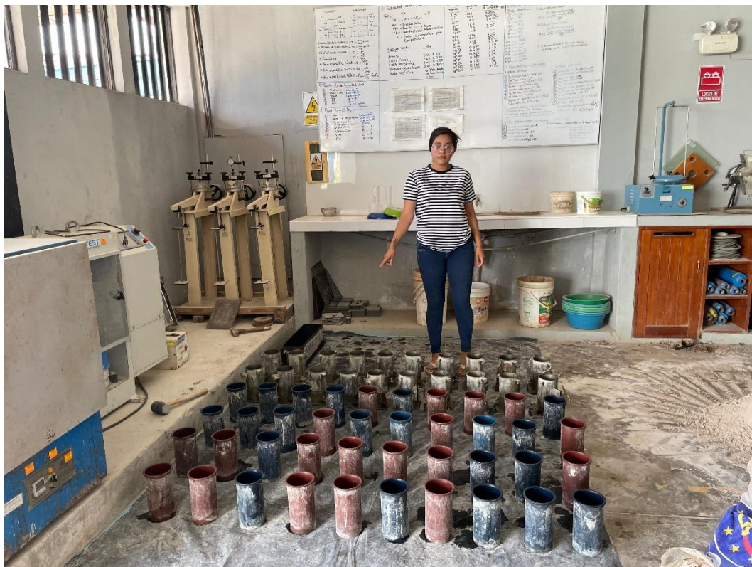
VERIFICACION DE LOS MOLDES CILINDRICOS
