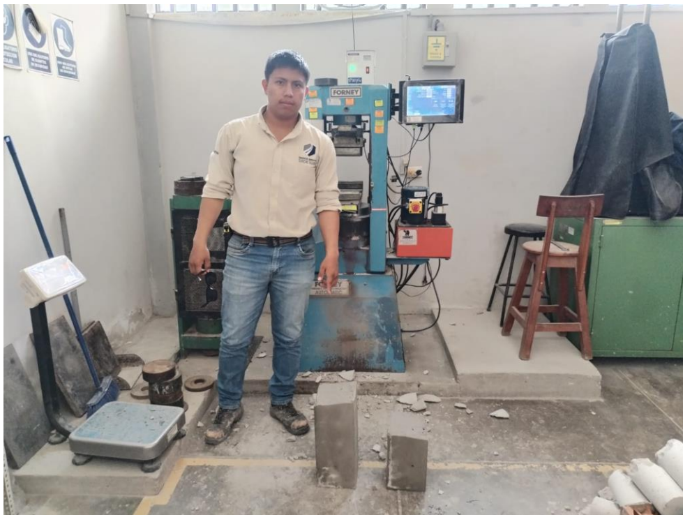
VERIFICACION DEL ENSAYO A LA COMPRESION DE MUESTRA DE VIGAS
