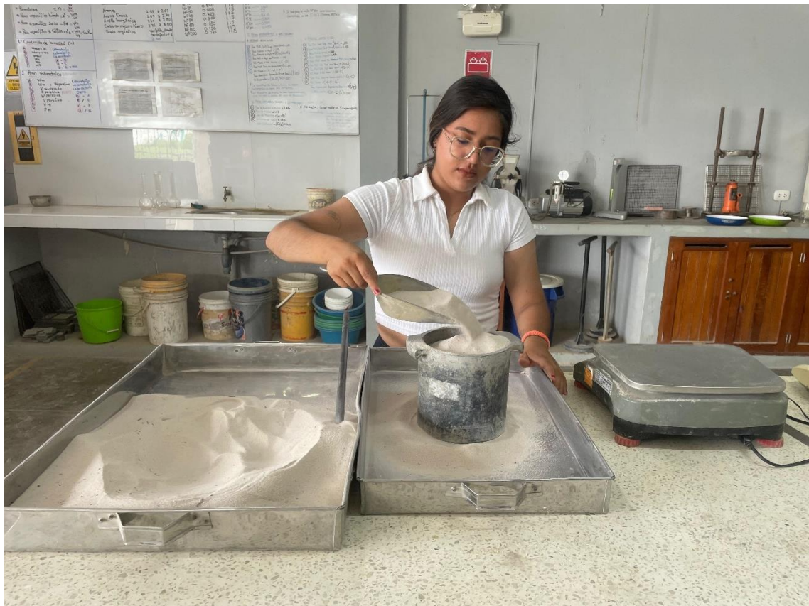
VERIFICACION DEL AGREGADO FINO PARA PESO SUELTO Y COMPACTADO
