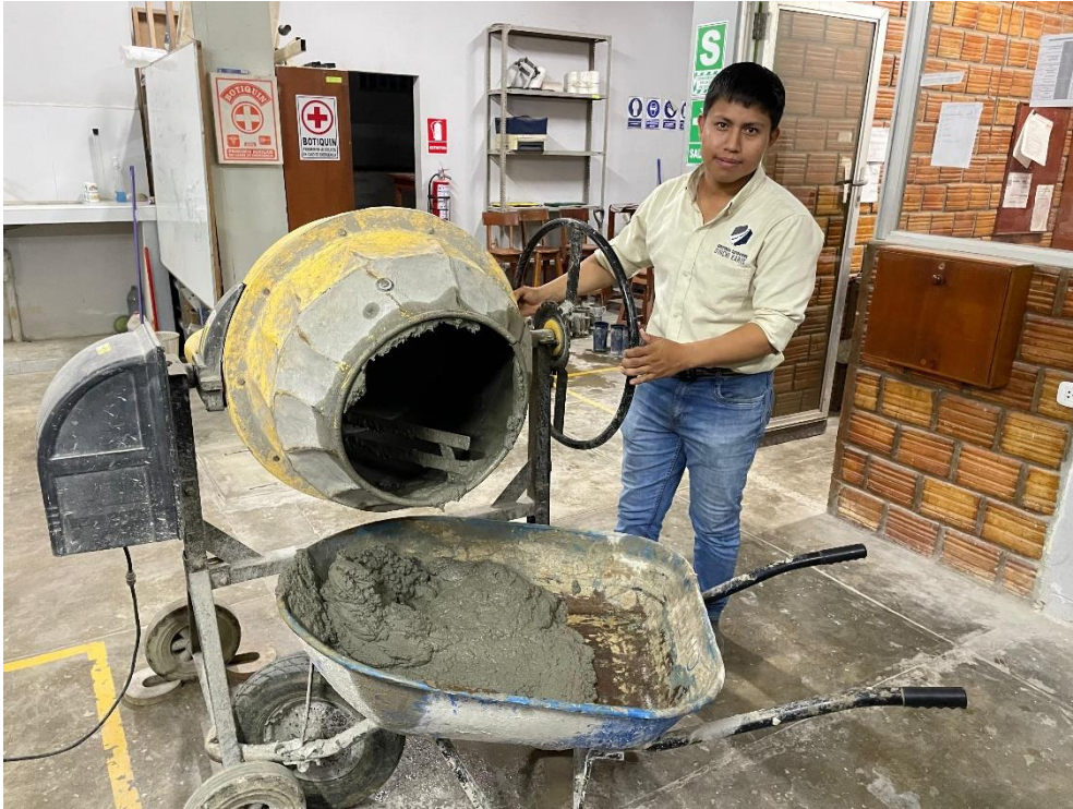
VERIFICACION DE LA MEZCLA PARA REALIZAR LOS TESTIGOS
