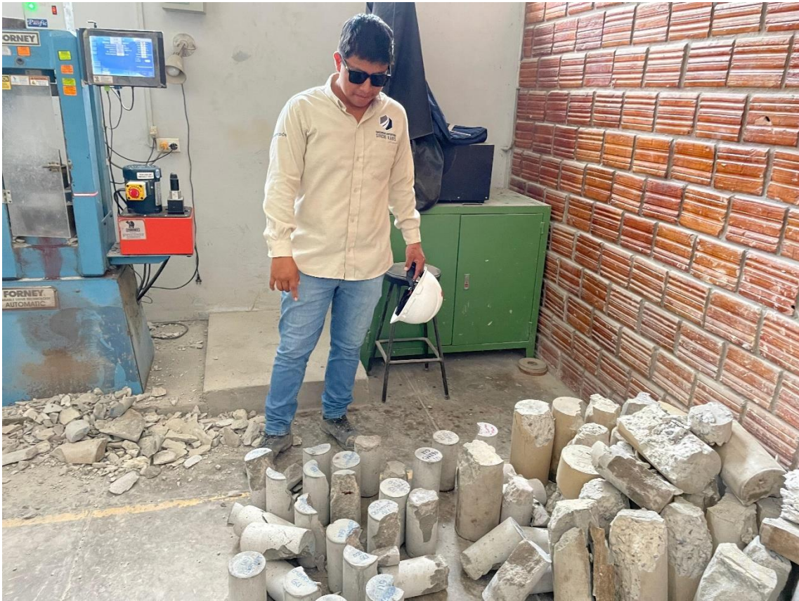
VERIFICACION DE LAS PROBETAS QUE PASARON EL ENSAYO A LA COMPRESION EN EL LABORATORIO
