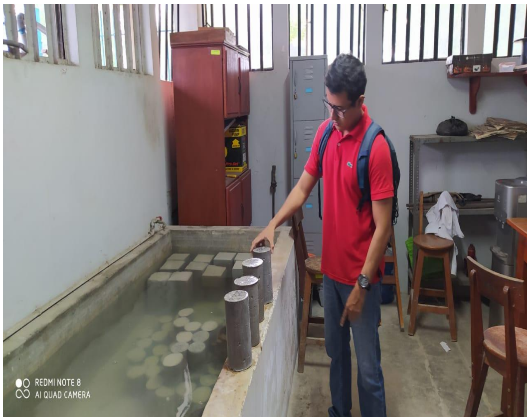
Imagen 5 Curado del Concreto en Poza con Agua potable.
