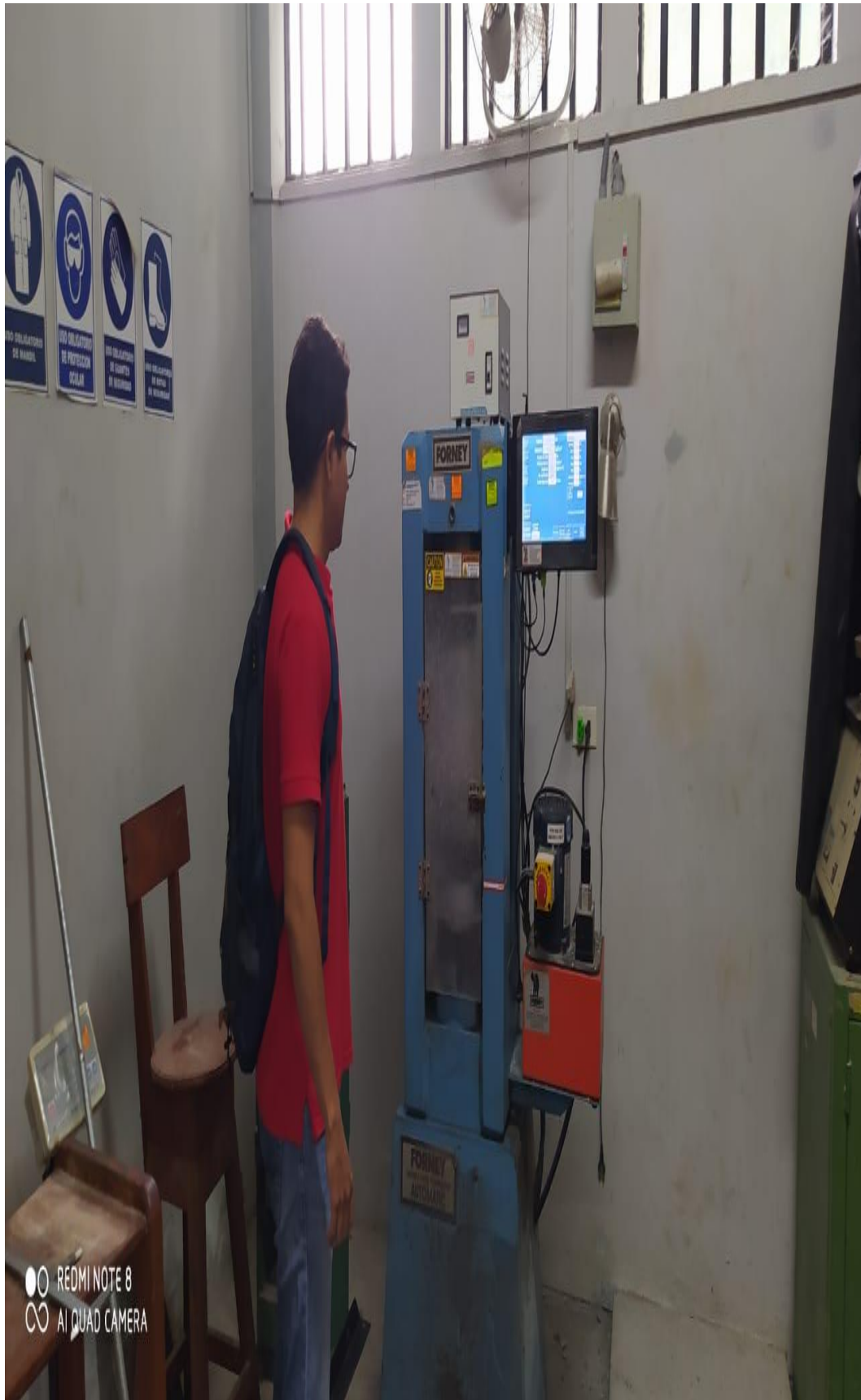
Imagen 7 Prueba de resistencia a la compresión del concreto.
