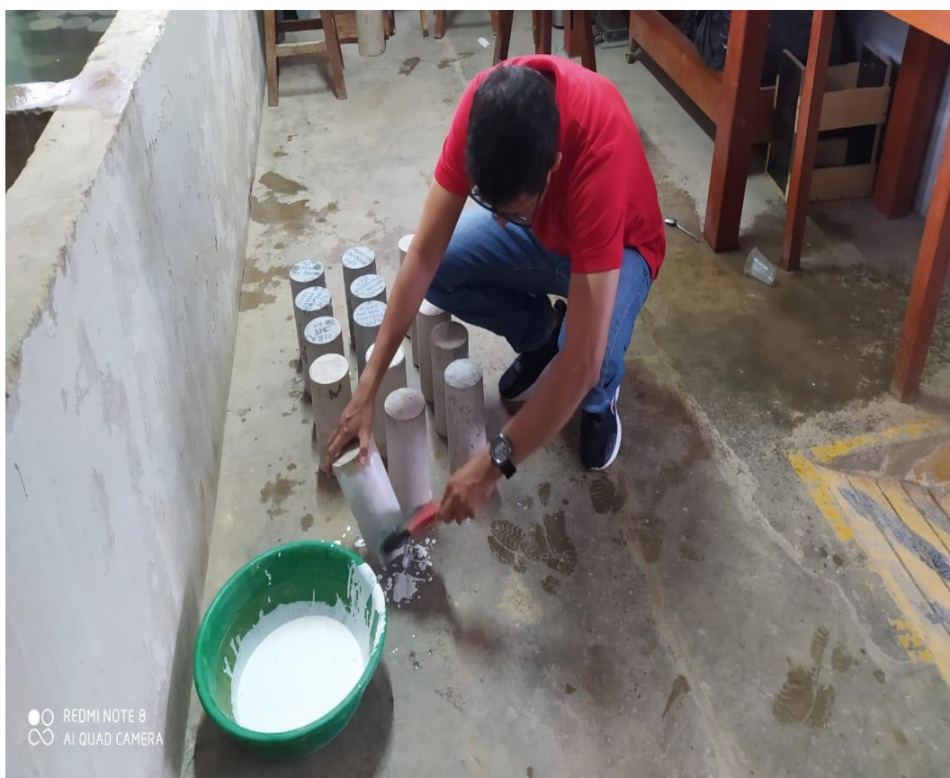
Imagen 4 Curado del Concreto con el aditivo químico chema membranal C-9.
