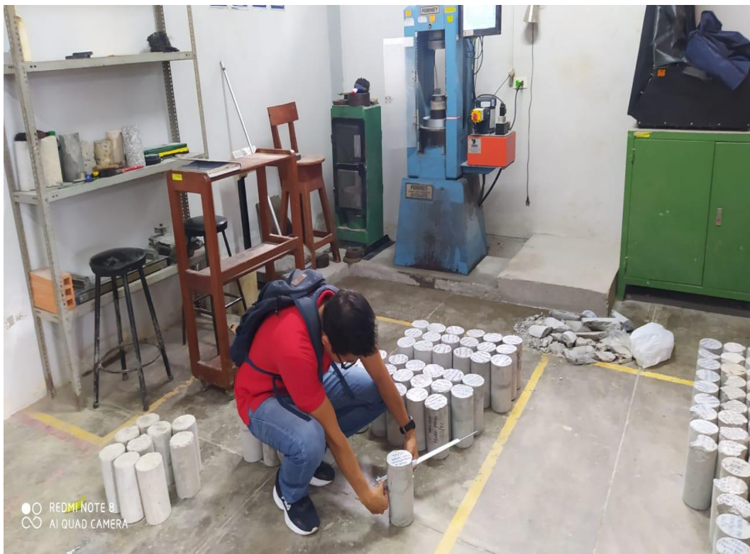
prueba de Resistencia a la compresión.
