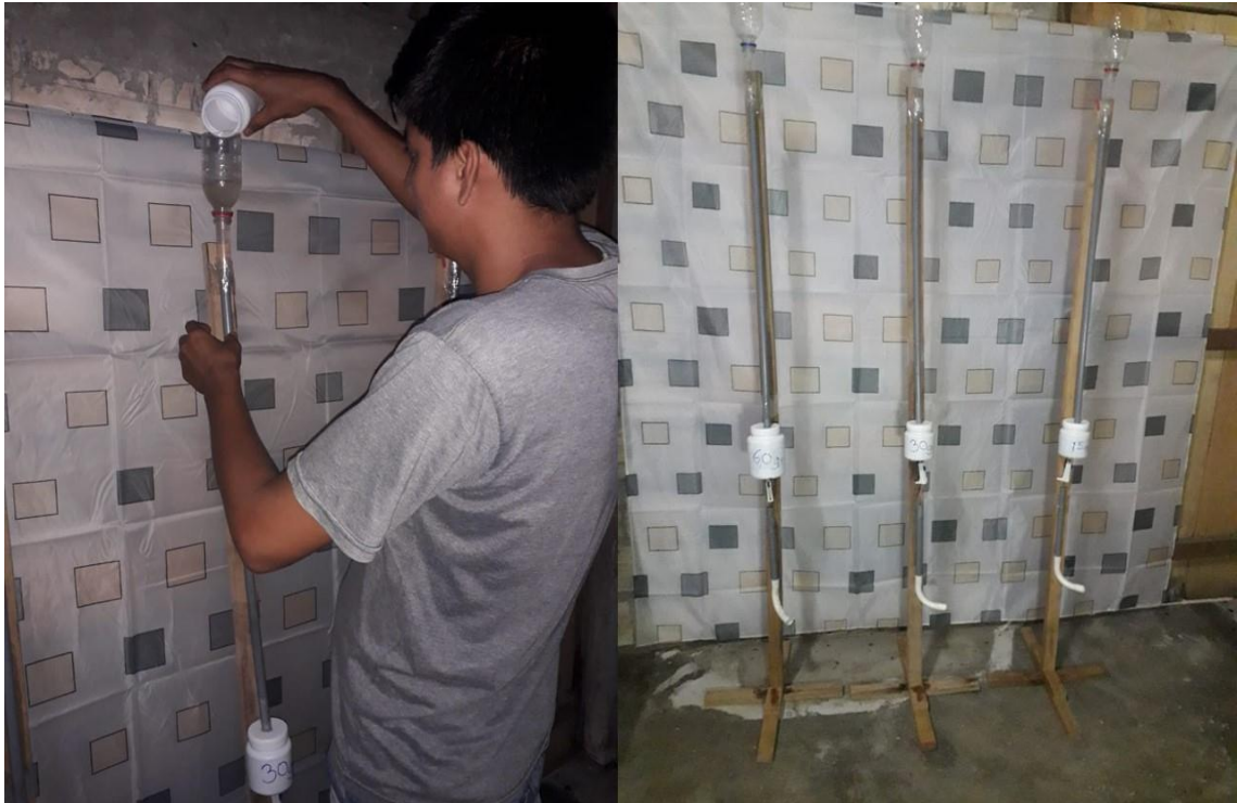
Imagen 7: Introducción del agua residual a los sistemas de tuberías
