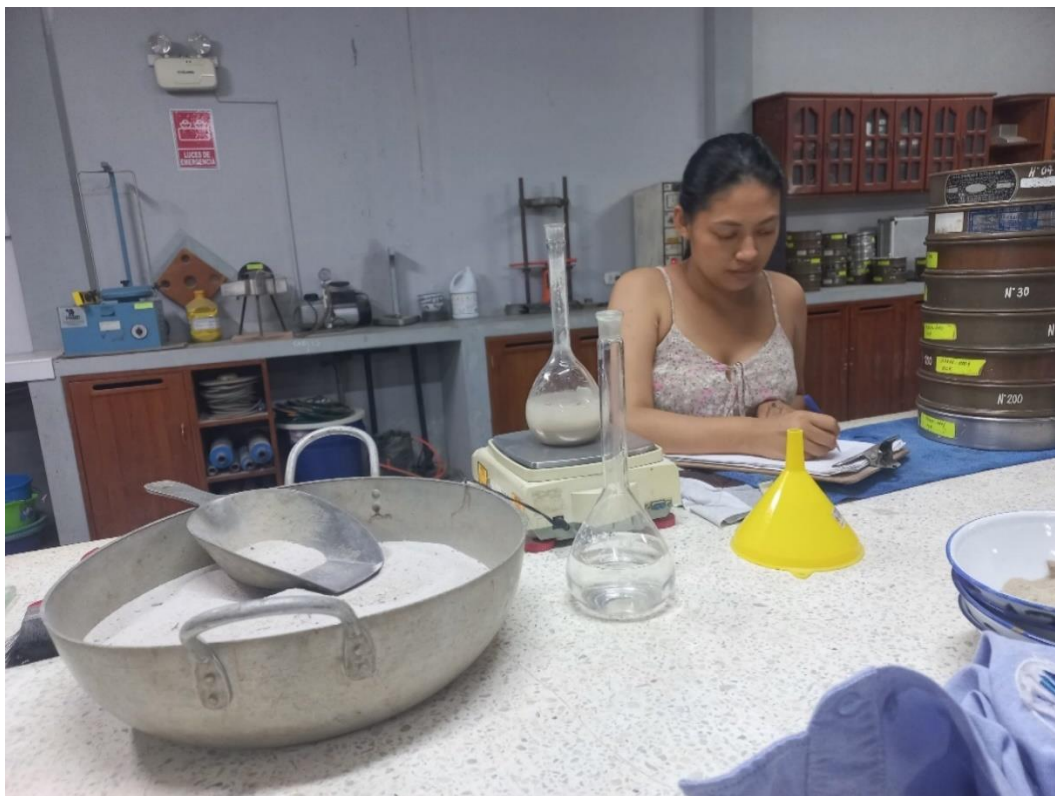
Imagen 7 : Pesado del agregado para el ensayo de humedad.
