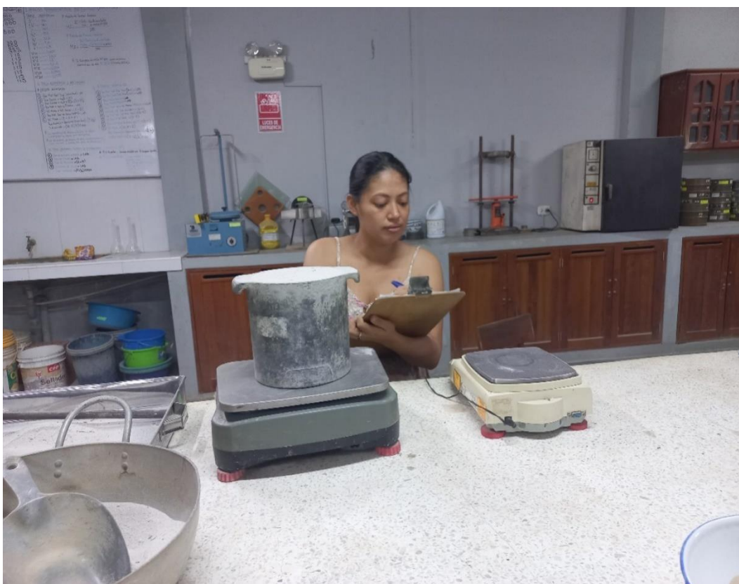
Imagen 2 : Pesado del agregado fino.
