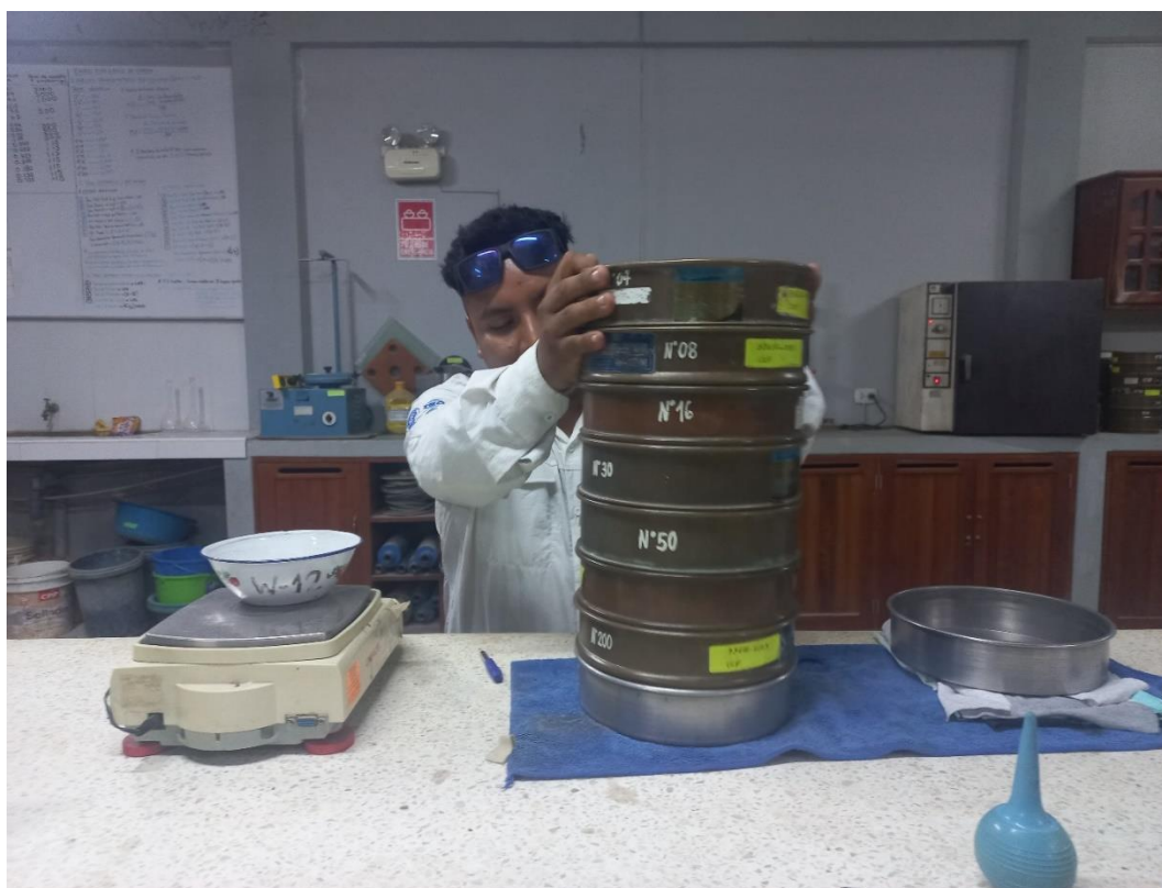
Imagen 4 : Ensayo de tamizaje del agregado fino.
