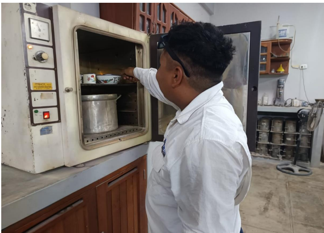
Imagen 10 : Colocación del agregado fino en la estufa para el secado del agregado.
