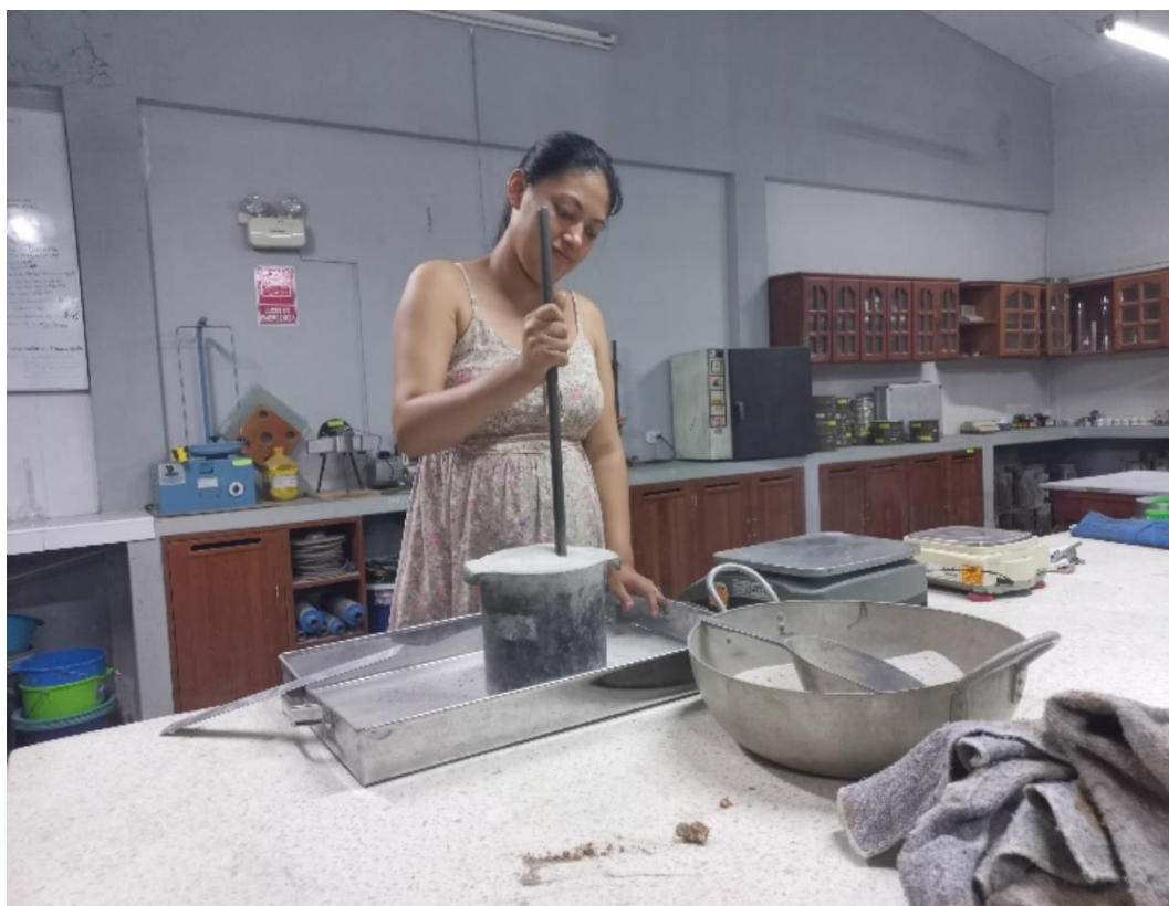
Imagen 5 : Ensayo de compactación del agregado fino.
