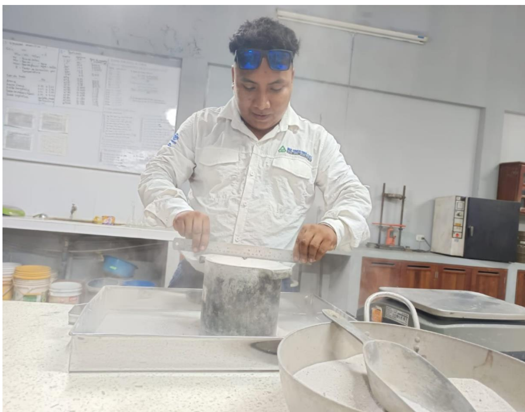
Imagen 6 : Ensayo de compactación del agregado fino.
