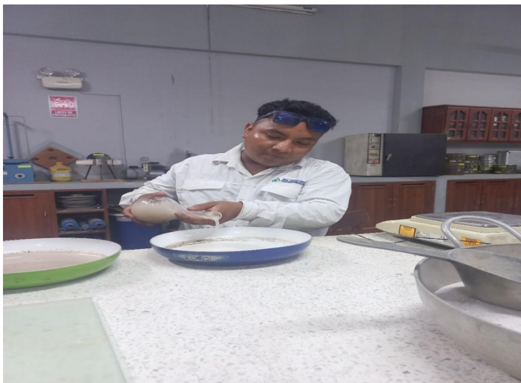
Imagen 8 : Ensayo para determinar el grado de humedad del agregado.
