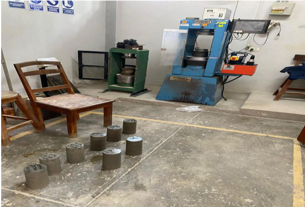
Imagen 11 : Ensayo de rotura de probetas de resistencia a la compresión a los 7 días.
