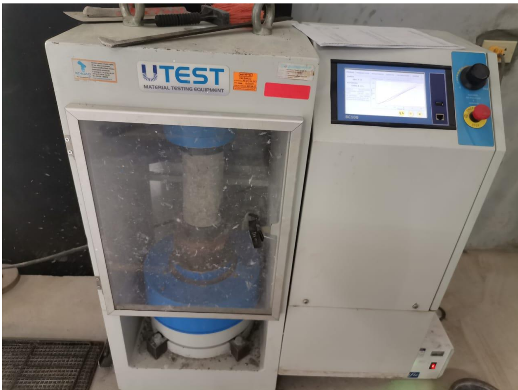
Imagen 12 : Ensayo de rotura de probetas de resistencia a la compresión a los 28 días.
