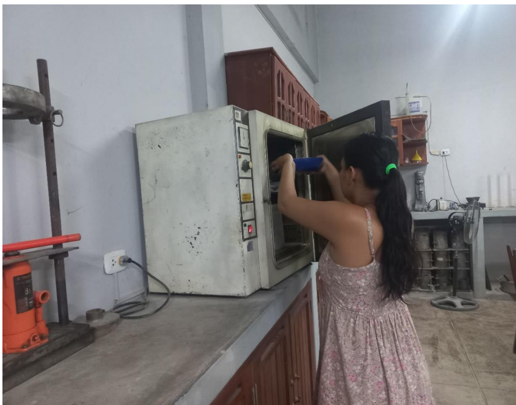
Imagen 9 : Colocación del agregado fino en la estufa para el secado del agregado.
