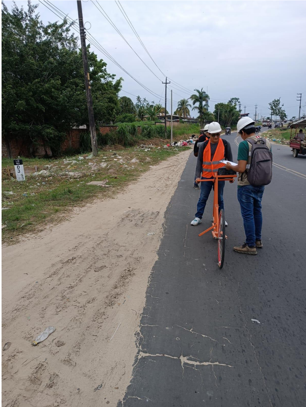
Inicio del rodamiento del Merlín
