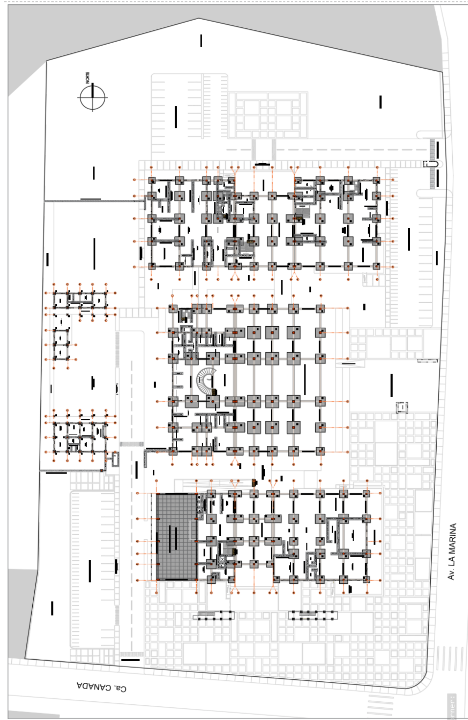
Imagen 95: Plano de cimentación y columnas.
