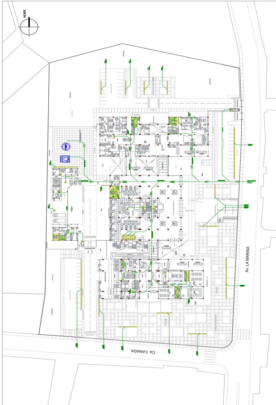
Imagen 99: Plano de Desagüe – 1er Piso
