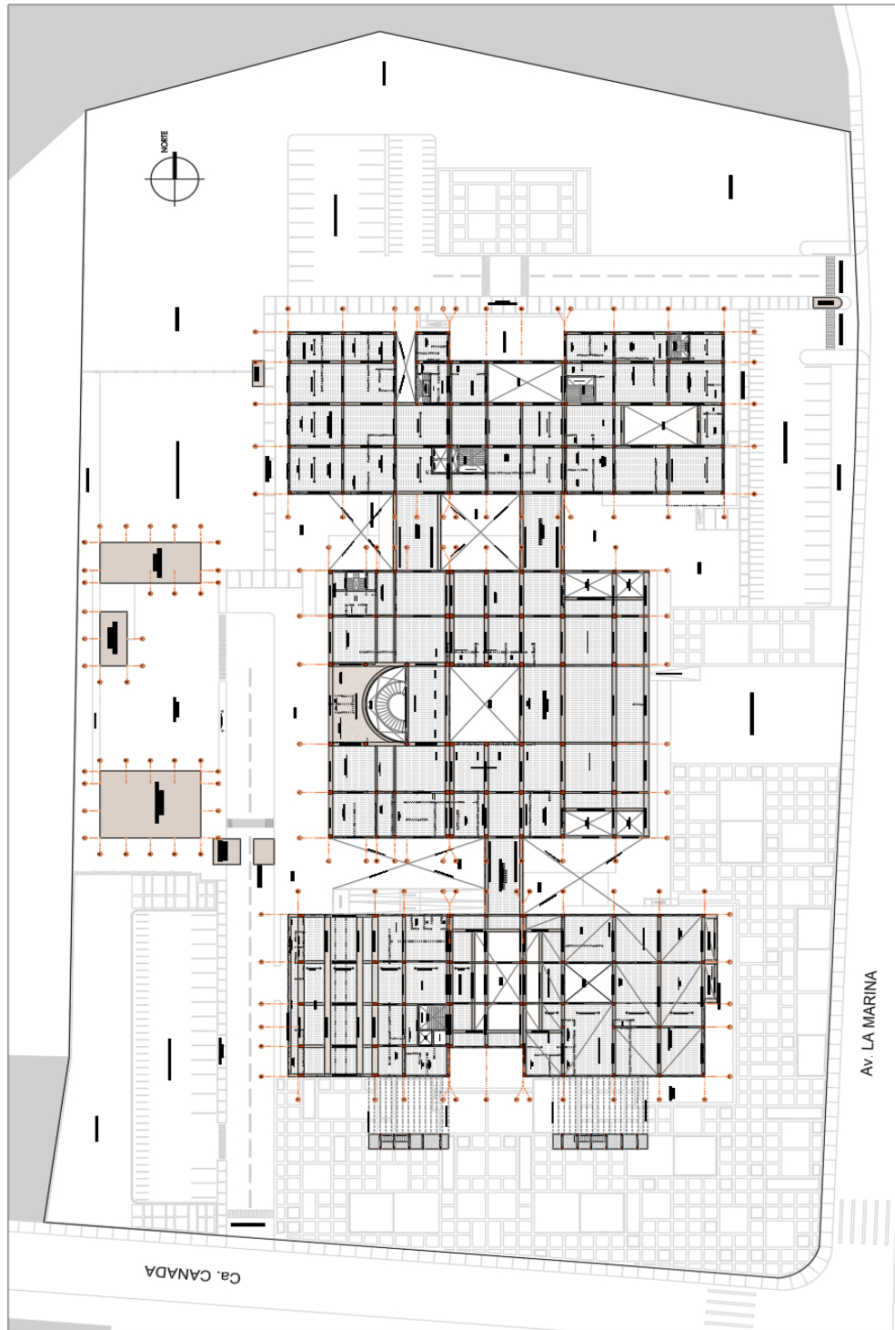
Imagen 96: Plano de Losa aligerada y vigas.
