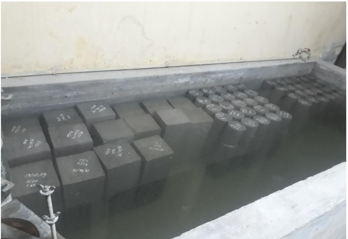
Curado de los testigos de concreto
