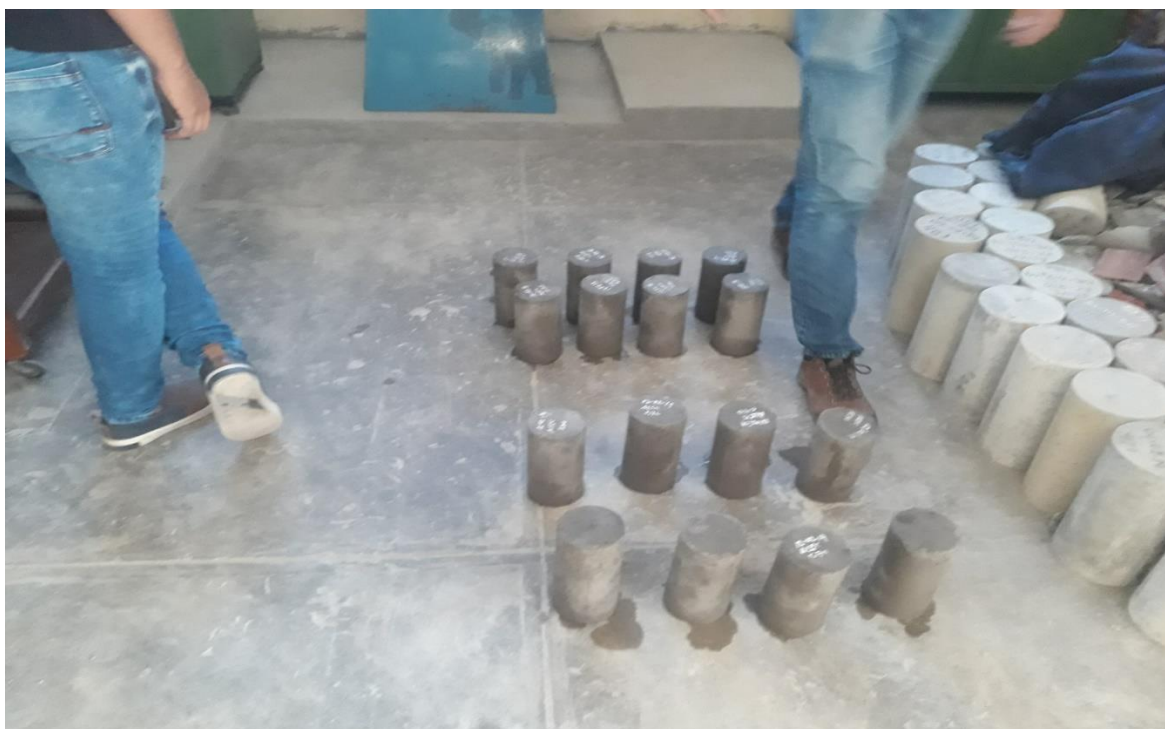
Preparación para ruptura de testigos
