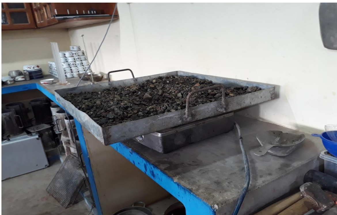
Secado del agregado grueso
