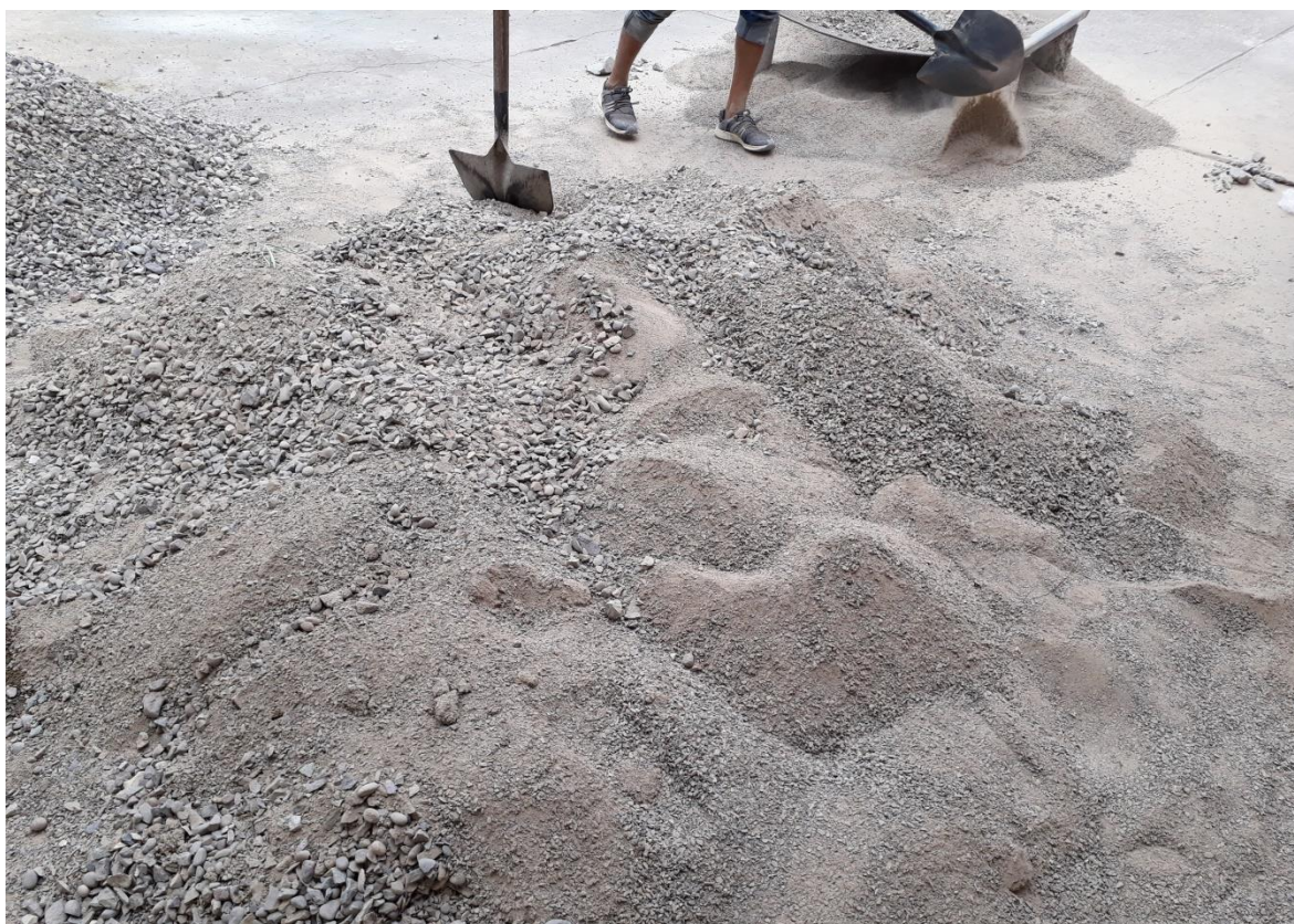
Mezclado y cuarteo del agregado
