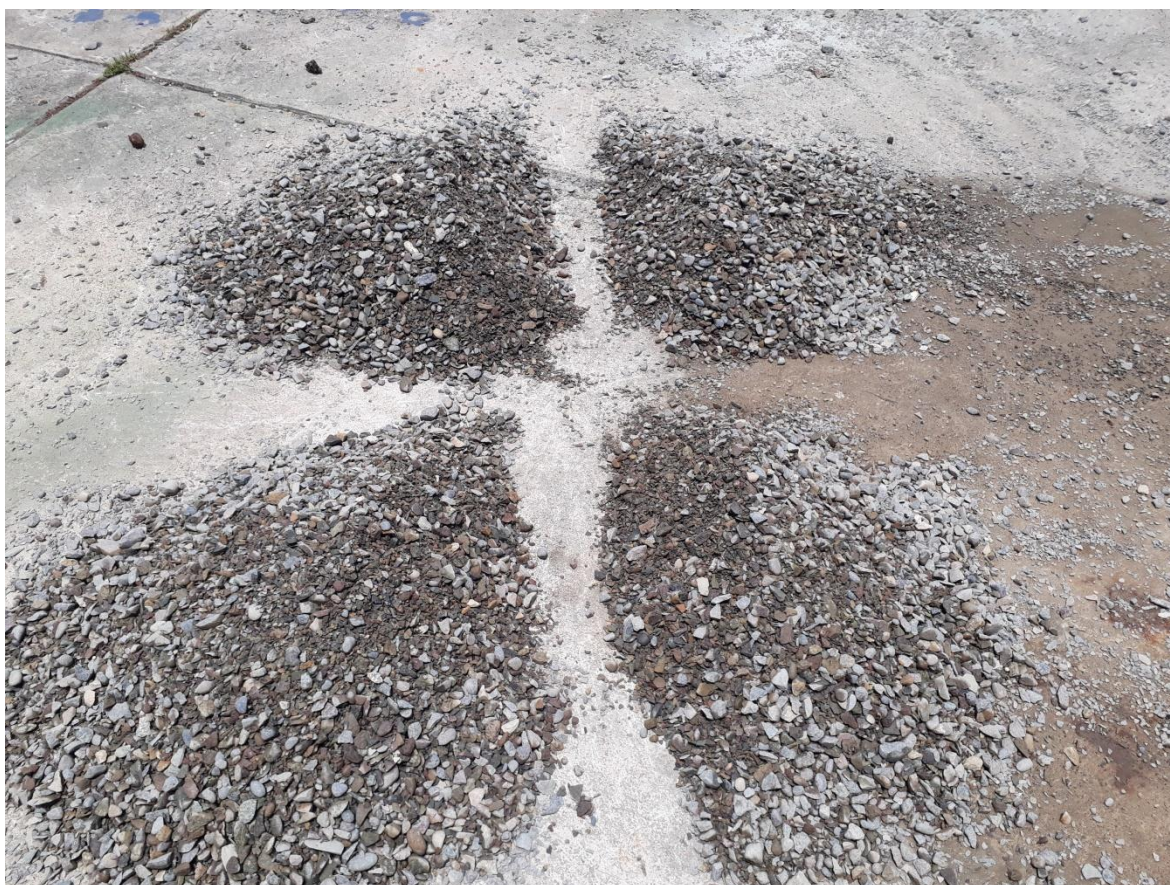
Mezclado y cuarteo del agregado grueso
