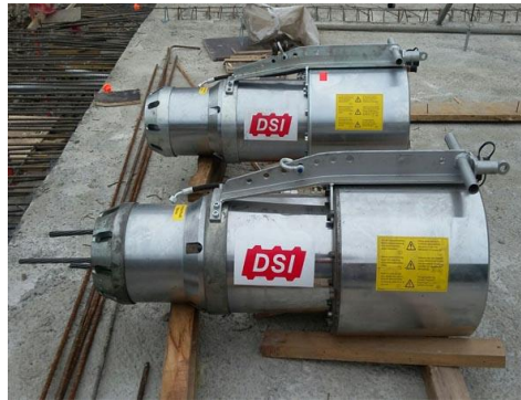
Imagen N° 14: Gato hidráulico para tensado de cables (SAMAYCA INGENIEROS)
