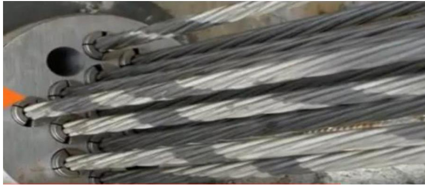
Imagen N° 10 torones o cables del postensado tomada de (Soto Valdez, 2018)
