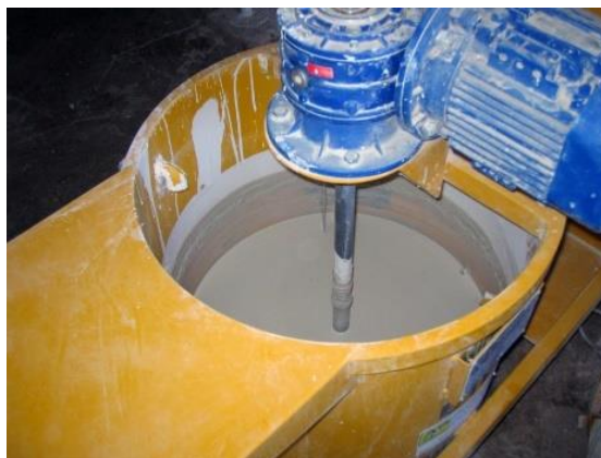
Imagen N° 13: lechada para inyección (fuente: Imagen de Google)
