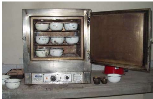
Figura 6. Horno de secado con muestras de suelo
