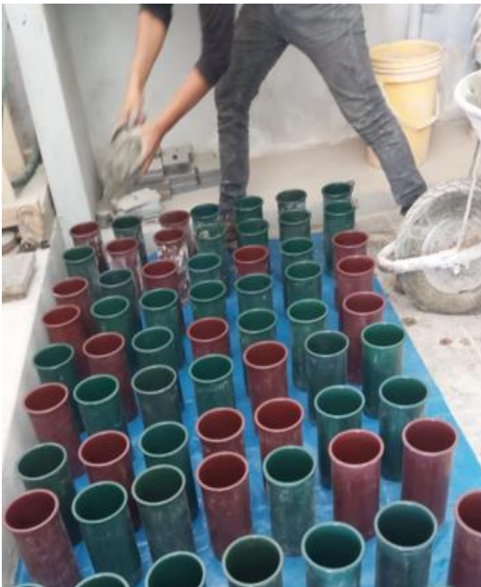
Preparación de los testigos cilíndricos
