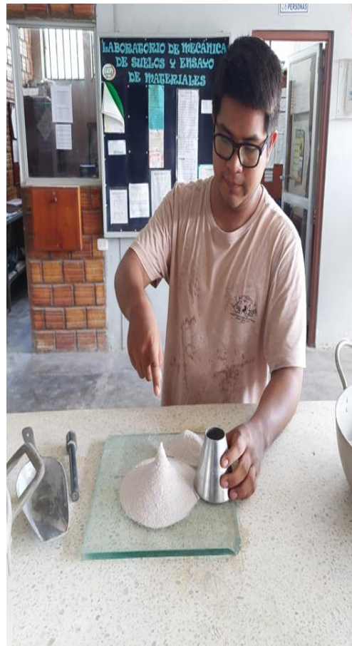
Ensayo del Pesos específico del agregado fino
