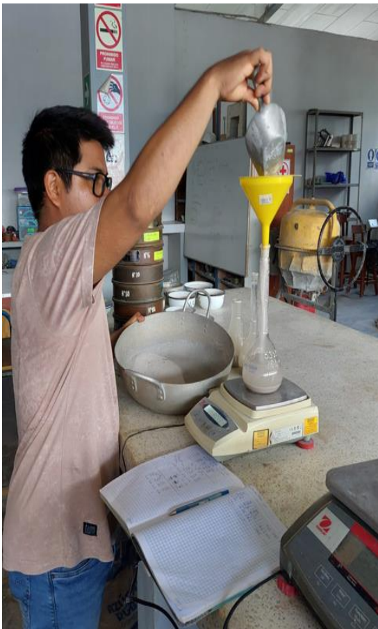
Ensayo del Pesos específico del agregado fino
