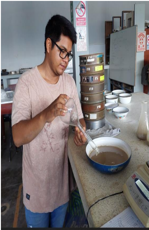
Ensayo de absorción del agregado
