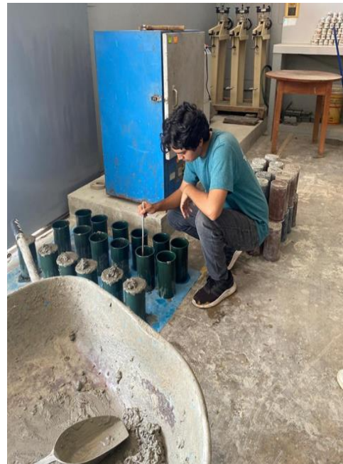
Preparación de los testigos cilíndricos
