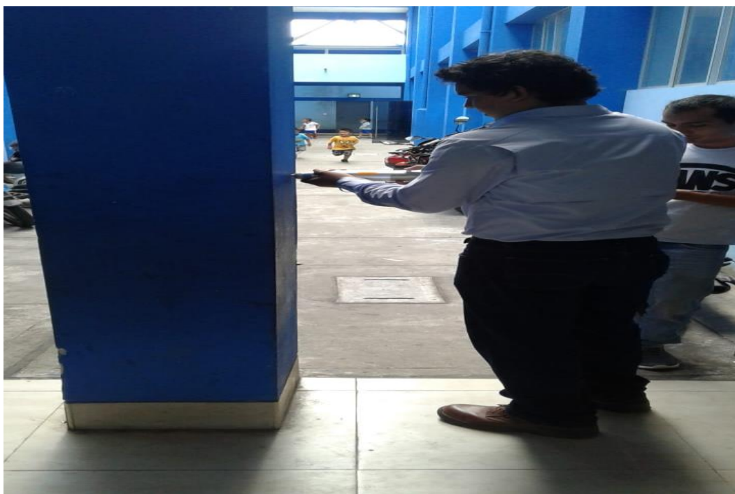
Gráfico 40. Fotografía del ensayo de esclerometría. Fuente Propia.
