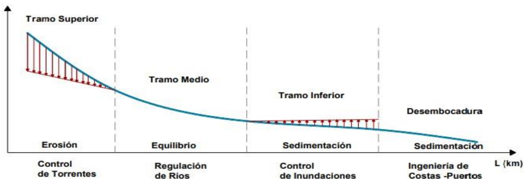
Figura 5, Representación gráfica del desarrollo longitudinal de un cauce
