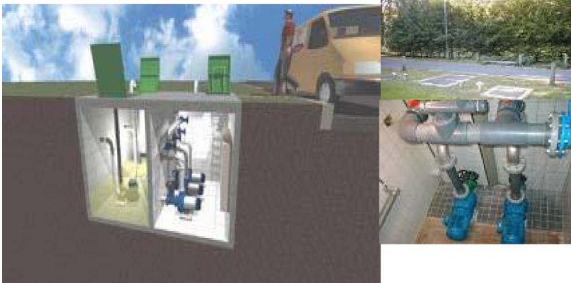
Esquema de Estación de vacío mediante Eyectores Fuente: Terraigua
